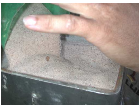
a) Colocação de areia para regularização de superfície do concreto
