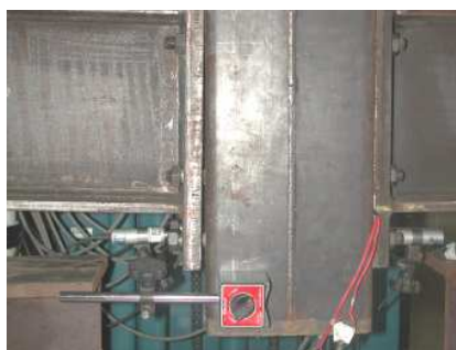
e) Modelo BCFT_A – Transdutor para medir a abertura da região de ligação
