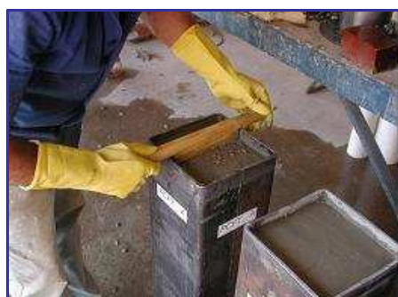
c) Acabamento da superfície de concreto
