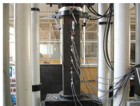
b) Colocação de placa para aplicação de carregamento no concreto
