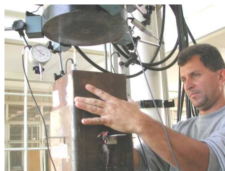
b) Colocação de placa para aplicação de carregamento no concreto
