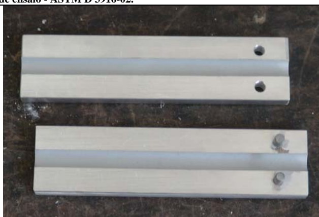
b) Dispositivos desenvolvidos para o ensaio das barras de GFRP.
