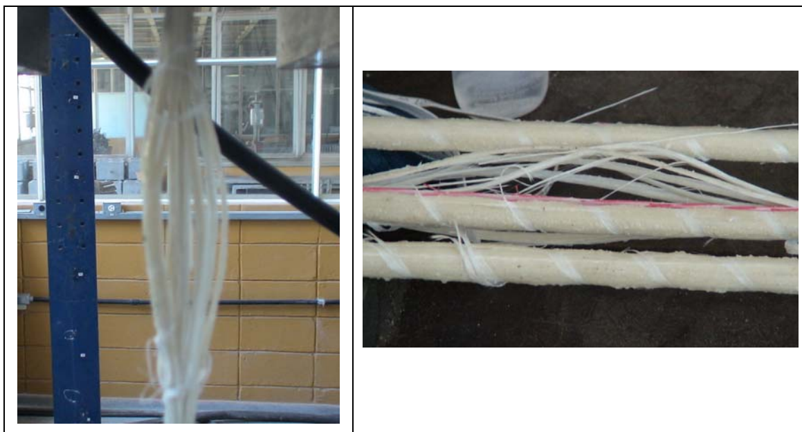
Figura 5.6 Ruptura típica dos corpos-de-prova de GFRP ensaiados à tração
