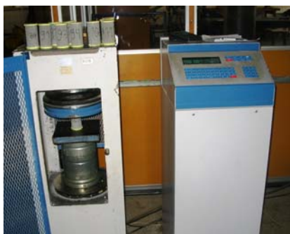
Figura 3.12 – Ensaio de resistência à compressão de corpos de prova
