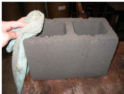
a) Secagem dos blocos para obter massa saturada superfície seca
