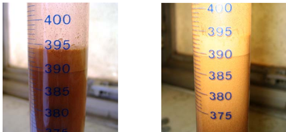
Figura 3.3 – Espuma no frasco de Chapman
