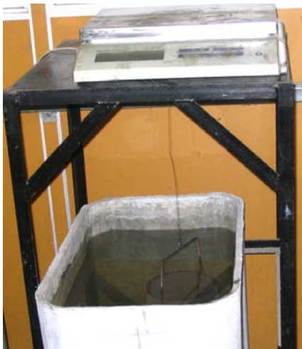
a) Pesagem em balança hidrostática
