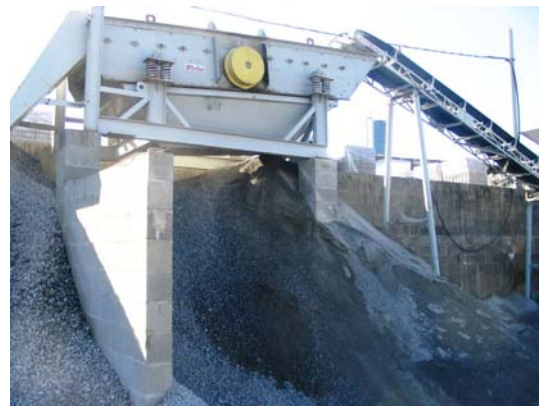
b) Peneiramento mecânico
