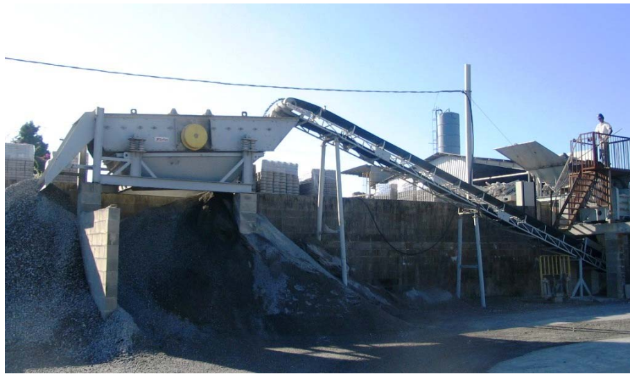
c) Ligação do britador ao peneirador por esteira
