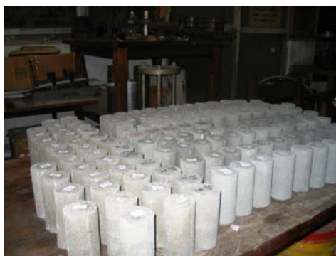
c) CPs da indústria para ensaio piloto
