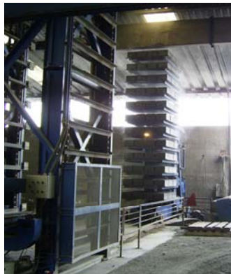
c) Transporte para cura térmica
