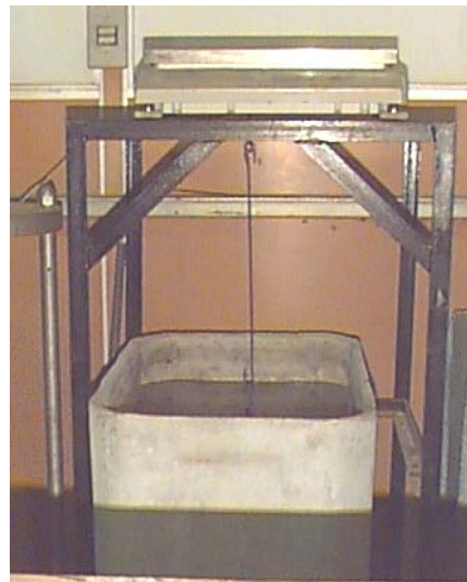
b) Ensaio de massa imersa com balança adaptada
