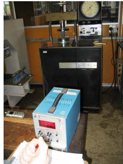
b) Aquisição de dados do Transdutor
