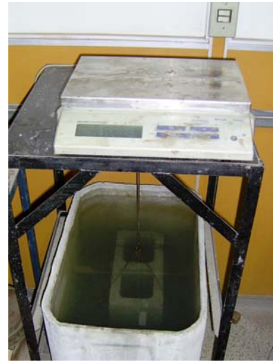
b) Ensaio de massa imersa do bloco
