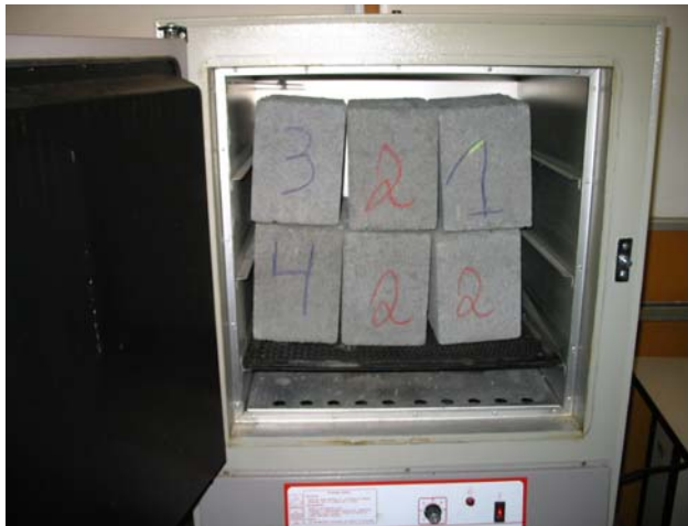
a) Secagem dos blocos em estufa
