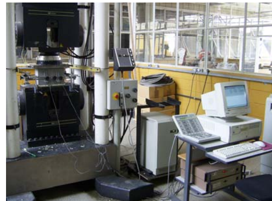
d) Prensa INSTRON com sistema de aquisição
