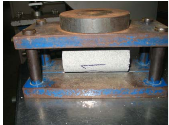
b) Dispositivo para centralização e alinhamento
