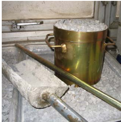
Figura 3.8 – Ensaio de massa unitária
