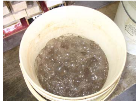
b) Reação da solução ácida com a argamassa
