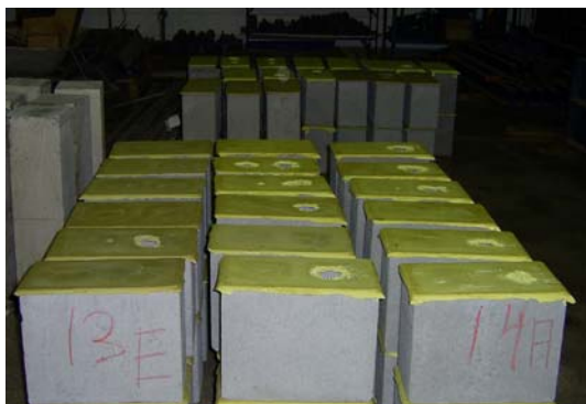
a) Capeamento dos blocos
