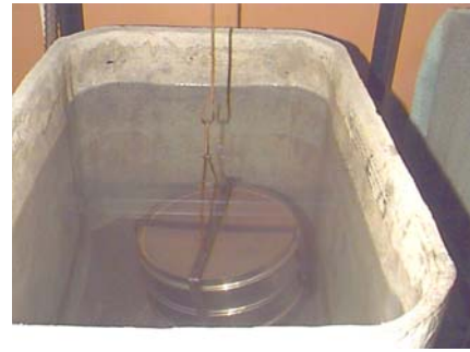
b) Pesagem em balança hidrostática
