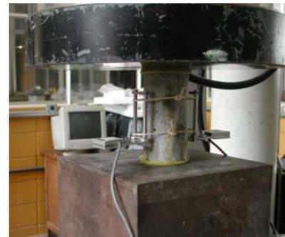
Figura 3.26 - Ensaio do módulo de elasticidade dos corpos-de-prova
