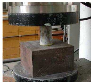
Figura 3.24 - Ensaio à compressão dos corpos-de-prova
