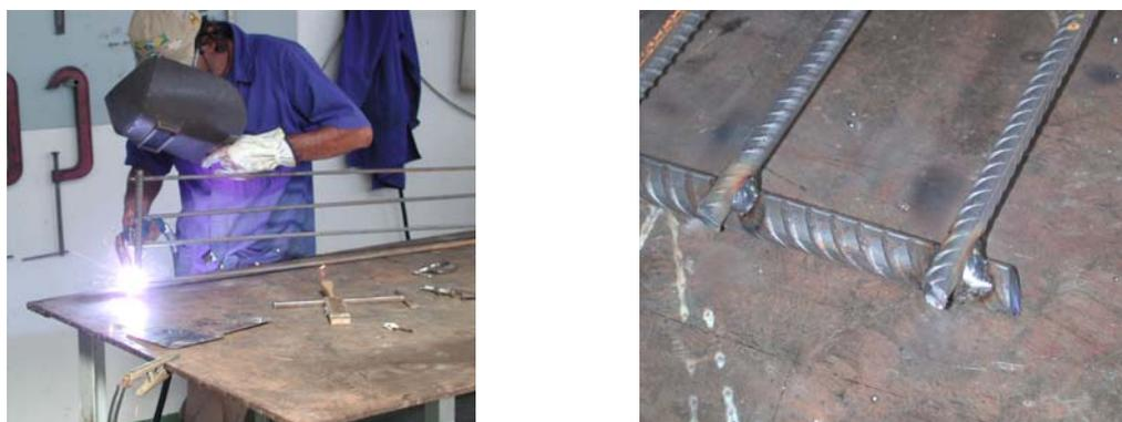
**Figura 3.10 - Soldagem dos tirantes das vigas e dos pilares**
