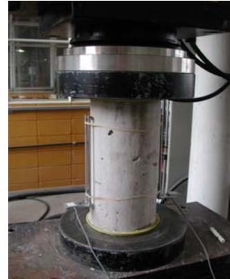
Figura 3.21 - Ensaio de módulo de elasticidade dos corpos-de-prova
