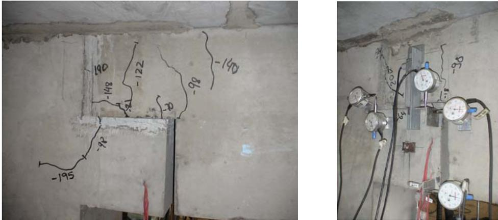
Figura 4.5 - Fissuração do graute e dente gerber do modelo E
