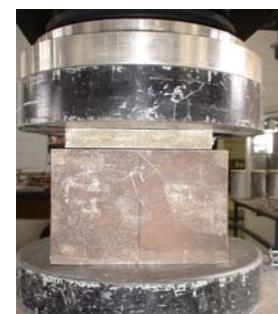
Figura 3.27 - Ensaio da rigidez da placa
