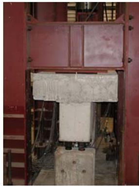
Detalhe da estrutura de apoio superior
