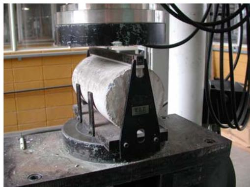
Figura 3.20 - Ensaio de tração por compressão diametral dos corpos-de-prova
