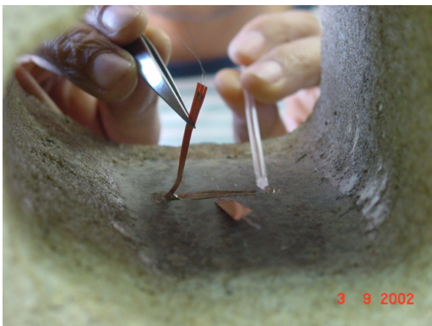
Figura 450 - Colagem do extensômetro transversal.
