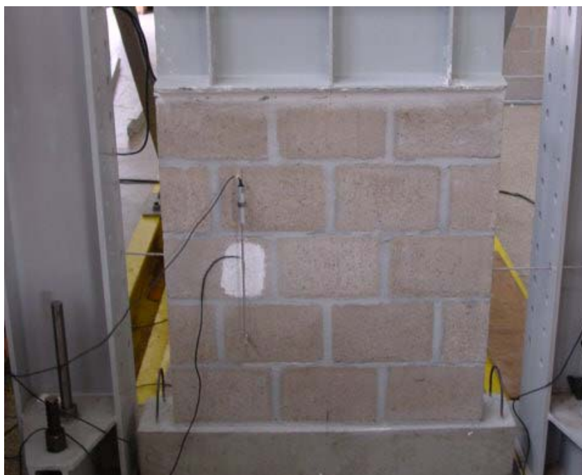
Figura 15 - Foto do corpo-de-prova tipo "wallette" pronto para o ensaio.
