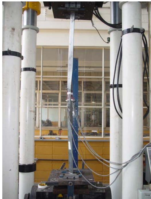
Figura 5.32 Estágio final ensaio: modo local/torsional cantoneira 60x2,38mm ( L_r = 1.685\text{mm} )
