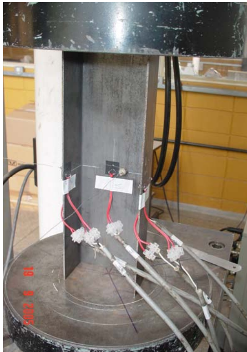
Figura 5.27 Instrumentação barra curta ( stub column ): exemplo de perfil do tipo U
