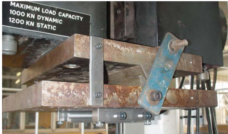
Figura 5.18 Detalhe da “faca” da rótula cilíndrica
