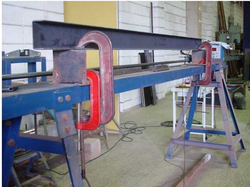
Figura 5.9 Perfil U posicionado na bancada para medição das imperfeições geométricas
