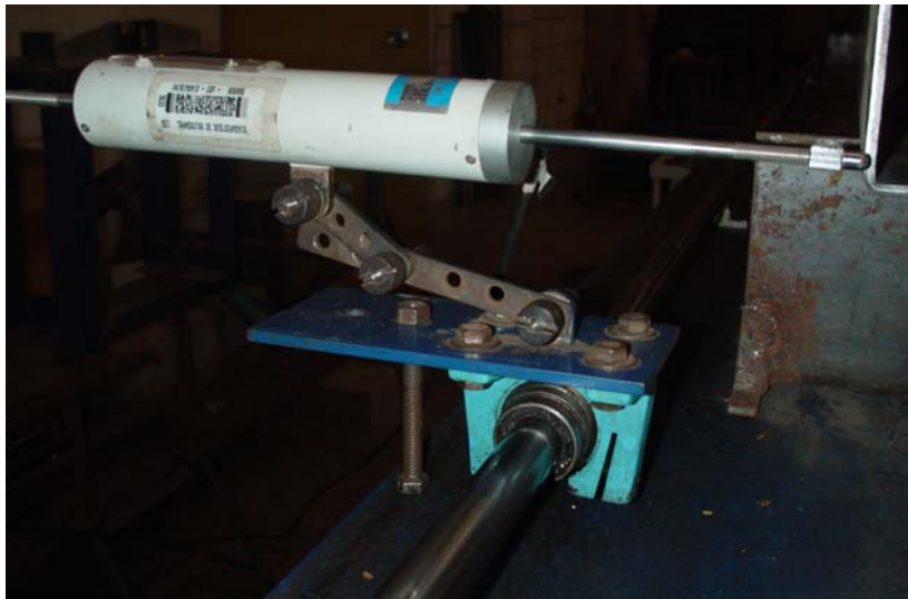
Figura 5.6 Transdutor de deslocamento: medição de imperfeições geométricas iniciais
