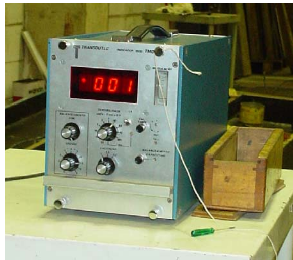
Figura 5.7 Indicador portátil interligado ao transdutor de deslocamento
