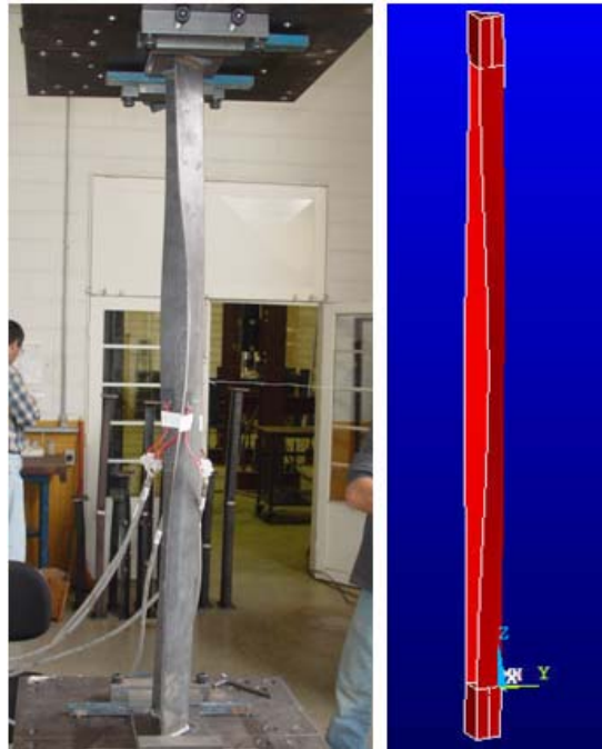
Figura 7.10 Ensaio versus Ansys: modo local/torsional para cantoneira 60x2,38mm
