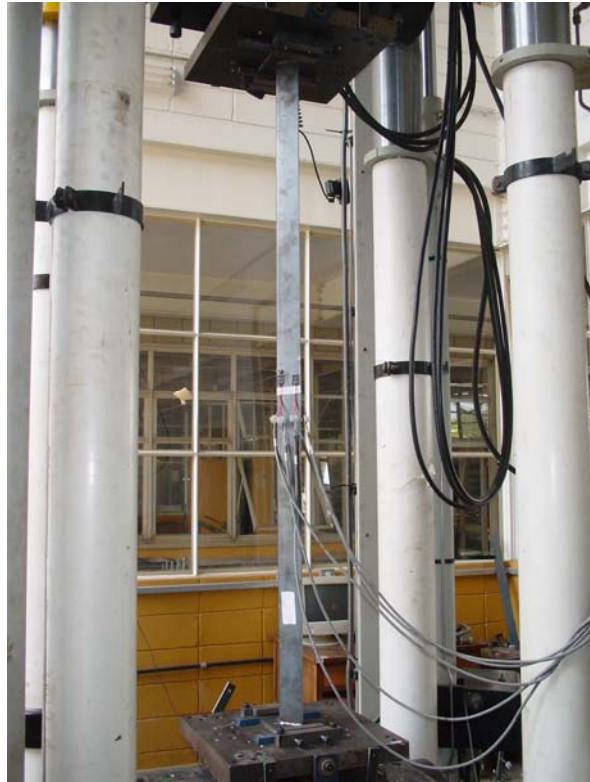
Figura 5.31 Antes do ensaio: cantoneira 60x2,38mm ( L_r = 1.685\text{mm} )
