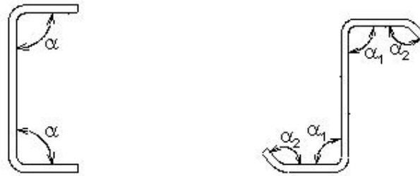
Figura 5.12 Ângulo formado por elementos adjacentes
