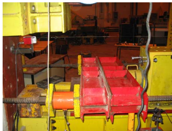
Figura 4.11: Detalhe do segundo procedimento para aplicação da força axial
