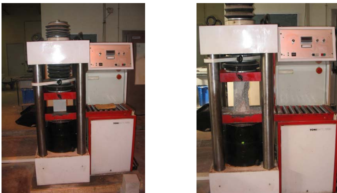
Figura 4.17: Ensaio de caracterização do concreto
