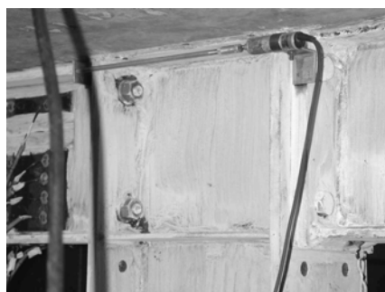
Figura A.6: Ilustração dos transdutores para medir a abertura relativa entre as duas chapas de topo.
