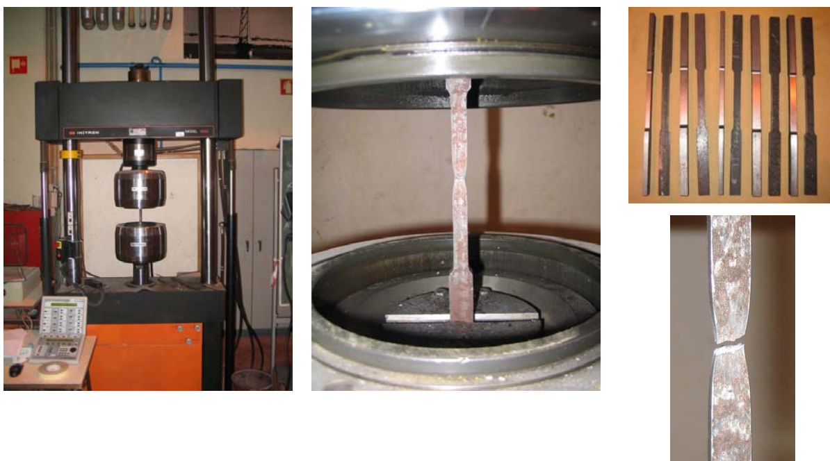
Figura 4.18: Detalhe do ensaio para caracterização do aço
