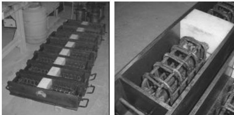
Figura 6.12 Fôrmas das vigas e armadura de confinamento
