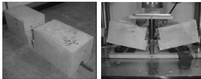
Figura 6.24 Aspecto final das vigas da série C3
