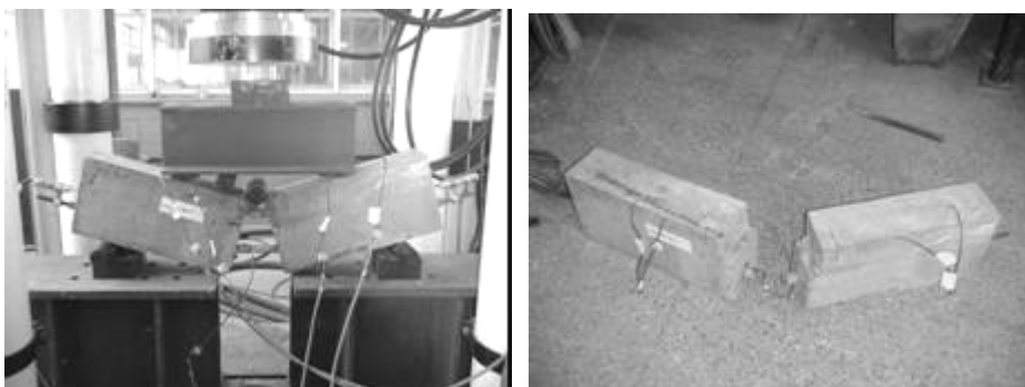
Figura 5.56 Modo de ruptura do modelo de viga com barra de 10 mm em CAA da série 2
