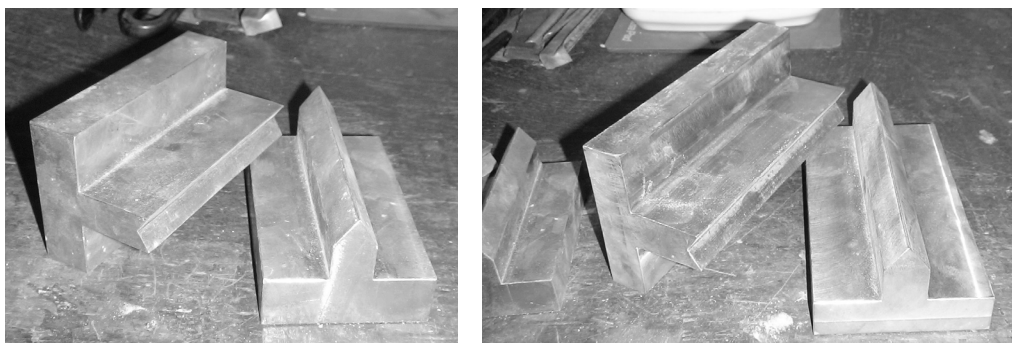
Figura 5.5 Fôrmas para a rótula do modelo de viga com barra de 10 e 16 mm
