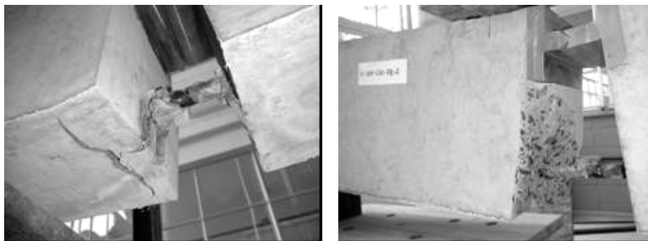
Figura 5.57 Modo de ruptura do modelo de viga com barra de 16 mm em CAA da série 2
