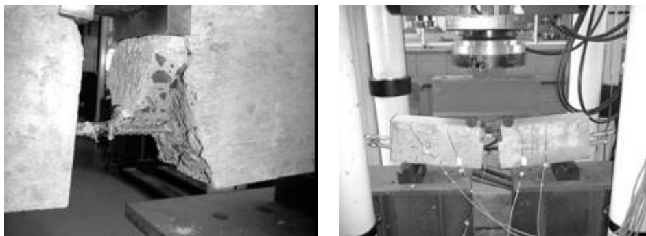
Figura 5.36 Modo de ruptura do modelo de viga com barra de 10 mm em CC da série 1
