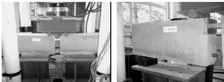
Figura 5.37 Modo de ruptura do modelo de viga com barra de 16 mm em CC da série 1
