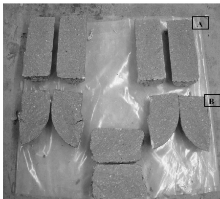
Figura 2.5 Cortes no concreto após o ensaio de tubo-U (Gomes, 2002)
