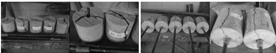
Figura 5.26 Comportamento dos modelos de arrancamento em CAA da série 2
