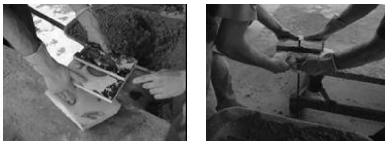
Figura 5.14 Concretagem dos modelos de arrancamento em CC
