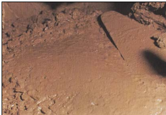
Figura A.1 – Propriedades da superfície do concreto com teor de argamassa ideal.
