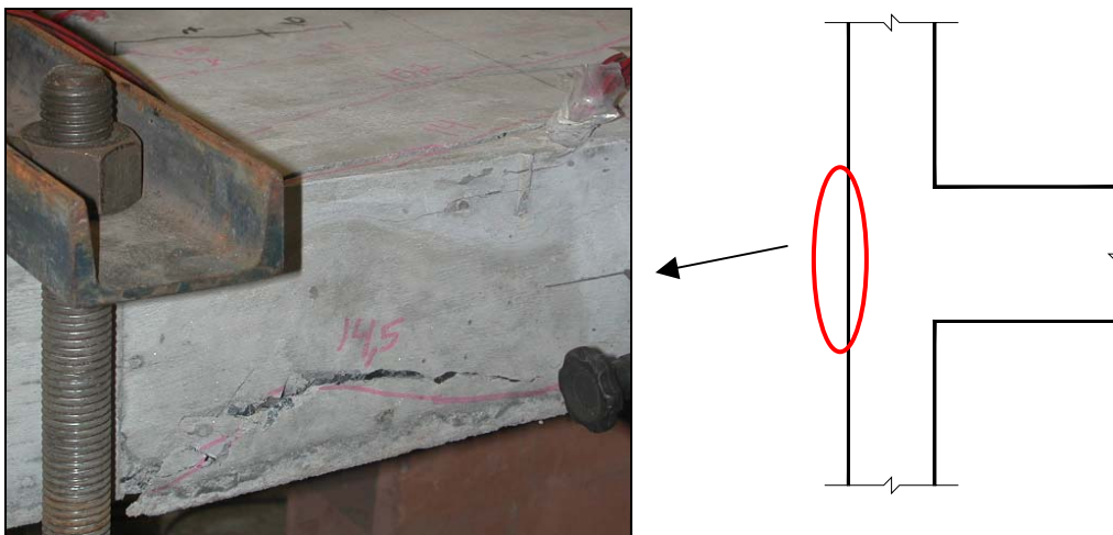
Figura 5.16 – Ruptura do cobrimento no lado externo do nó (Modelo N400).
