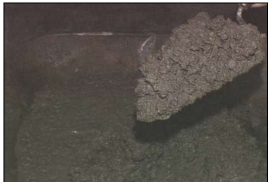
Figura A.2 – Aspecto homogêneo do concreto com teor de argamassa ideal.
