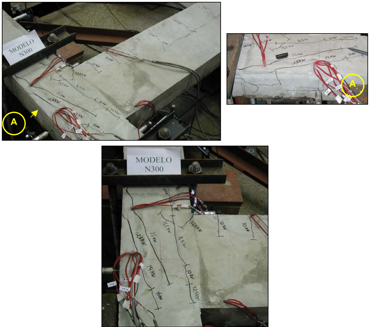
Figura 5.21 – Fissuração do Modelo N300.
