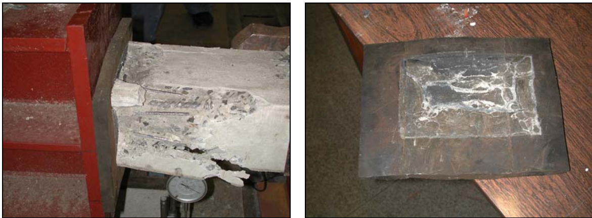
Figura 5.1 – Ruptura da extremidade do pilar por concentração de tensões.
