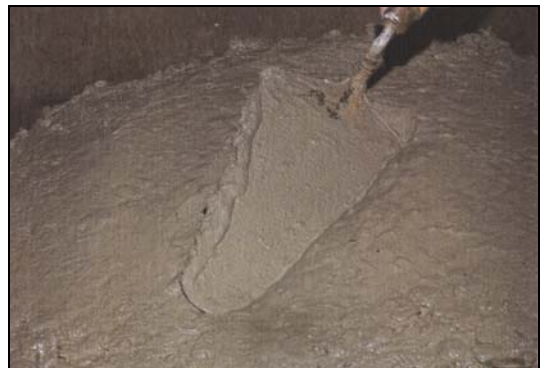
Figura A.1 – Propriedades da superfície do concreto com teor de argamassa ideal.
