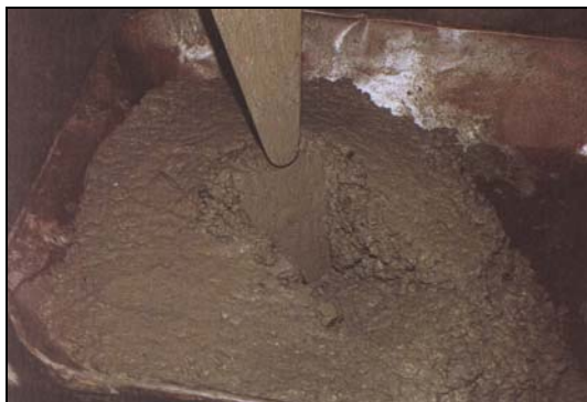
Figura A.2 – Aspecto homogêneo do concreto com teor de argamassa ideal.
