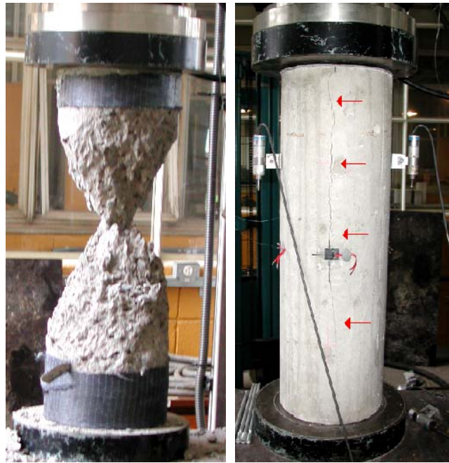
Figura 52: Ruptura característica e ocorrida com o modelo Ci 02.
