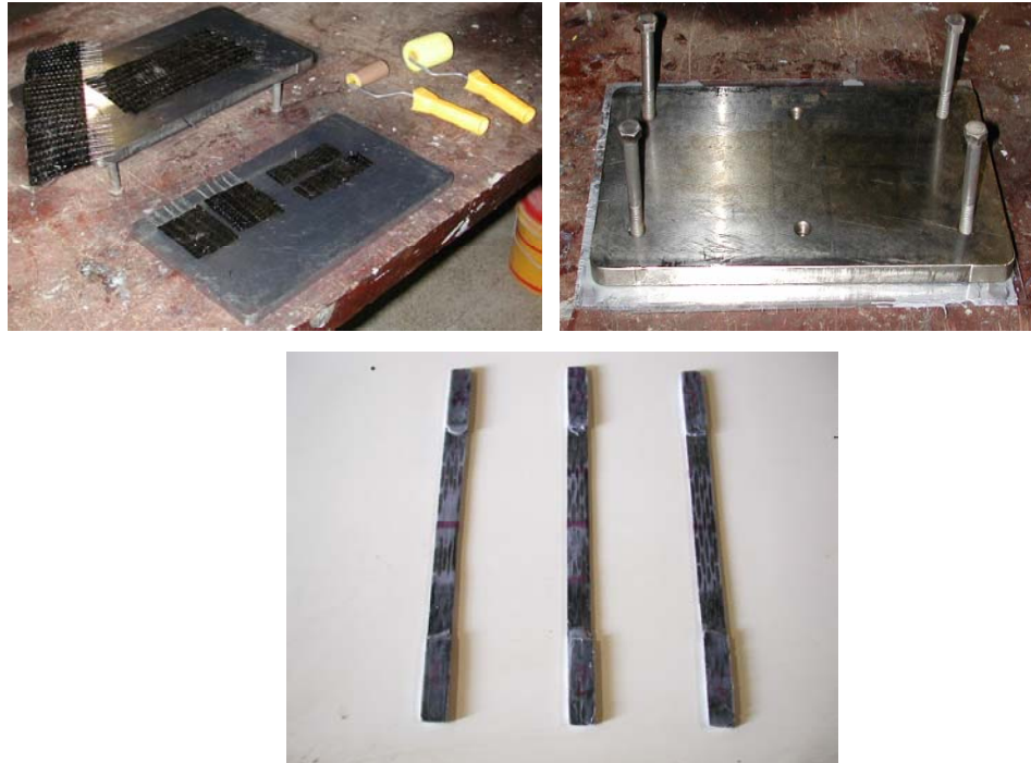
Figura 43: Processo de moldagem e aspecto final das amostras de PRFC.
