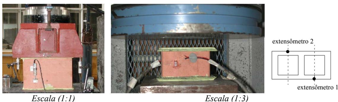
**Figura 5.8 - Ensaios dos módulos de deformação dos blocos nas escalas (1:1) e (1:3)**
