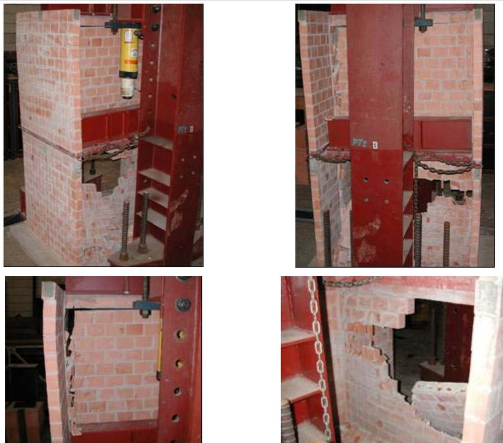
**Figura 8.49 - Forma de ruptura do painel H2 com 2 pavimentos**
