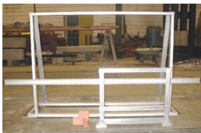
**Figura 5.14 – Gabaritos utilizados na construção dos corpos-de-prova na escala (1:3)**
