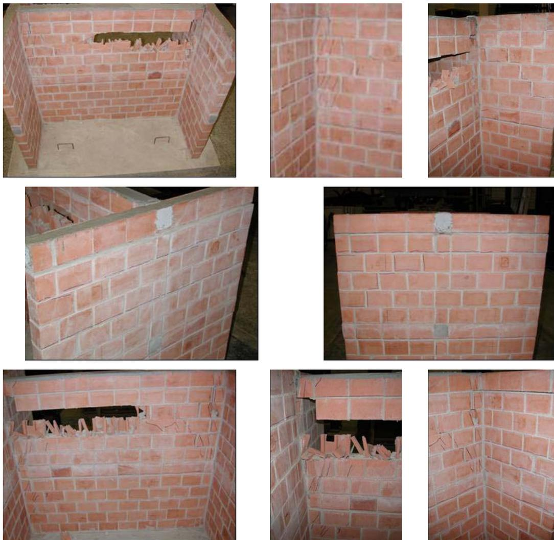
**Figura 8.33 - Formas de ruptura do painel H2-2**
