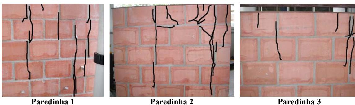
**Figura 5.34- Formas de ruptura das paredinhas na escala natural (1:1)**
