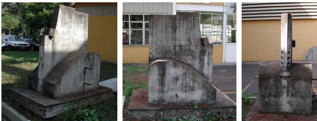
*Figura 3.1 – Modelo do pilar típico do vertedouro de Ilha Solteira - escala 1:20*
