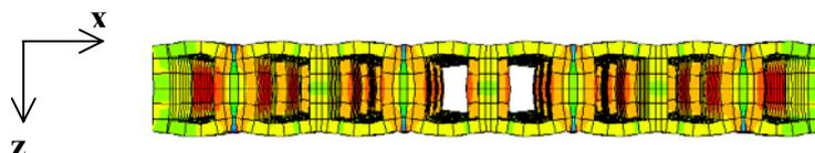
**Figura 6.63 - Distribuição das tensões máximas principais no modelo de paredinha vazada sem junta horizontal de argamassa**
