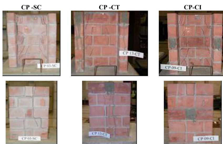
**Figura 7.21 - Comparação das formas de ruptura dos corpos-de-prova de cisalhamento**
