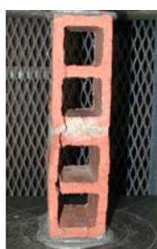
**Figura 5.30 – Forma de ruptura do prisma de 2 blocos na escala (1:3)**
