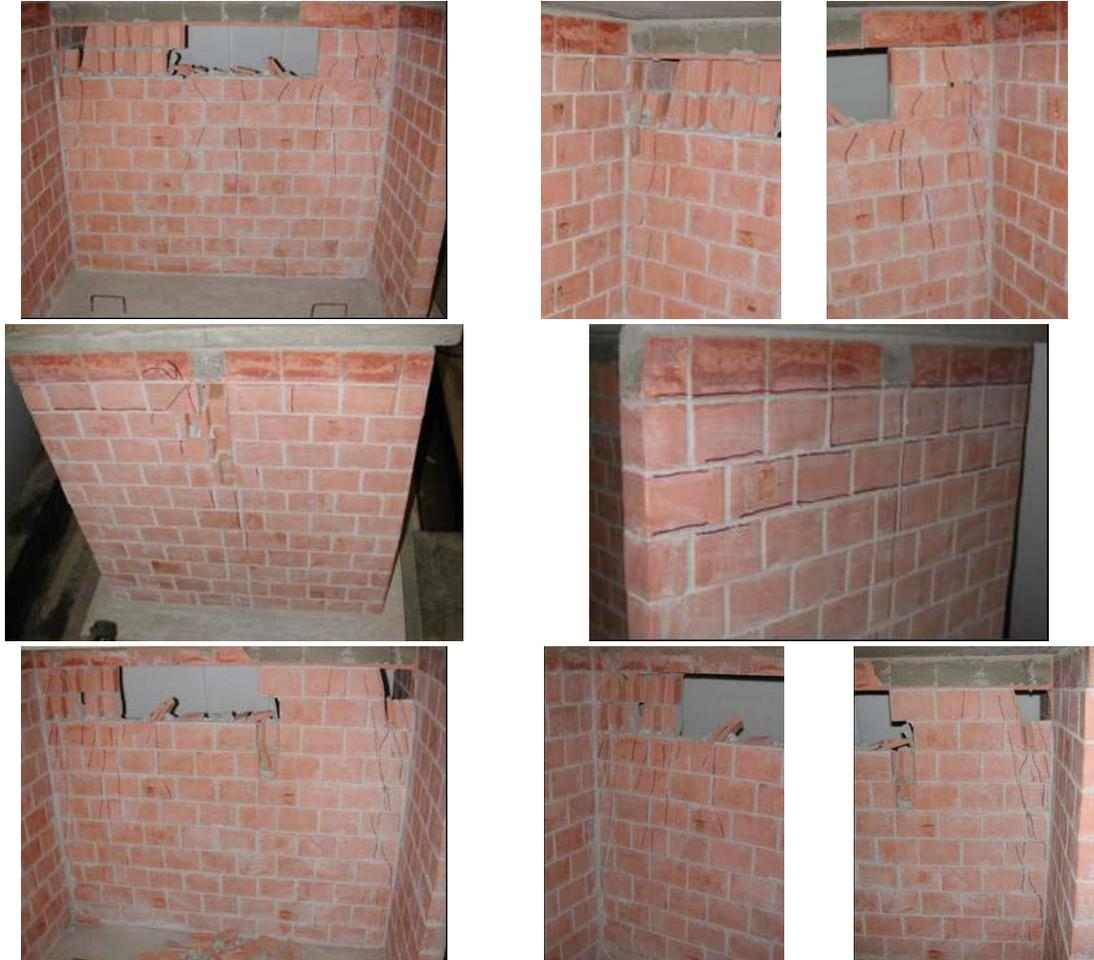
**Figura 8.30 - Formas de ruptura do painel H2-1a**
