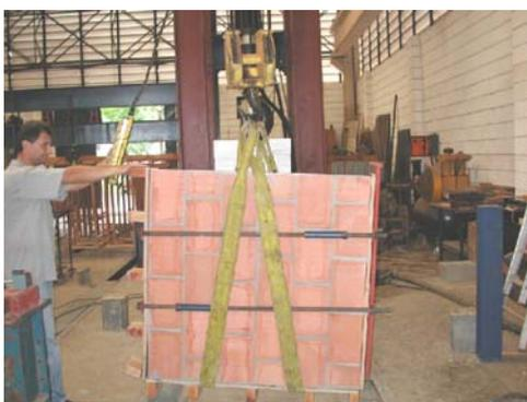
**Figura 5.15 – Transporte da paredinha na escala natural (1:1)**
