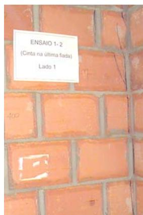
**Figura 2.28 - Forma de ruptura da série 2**
