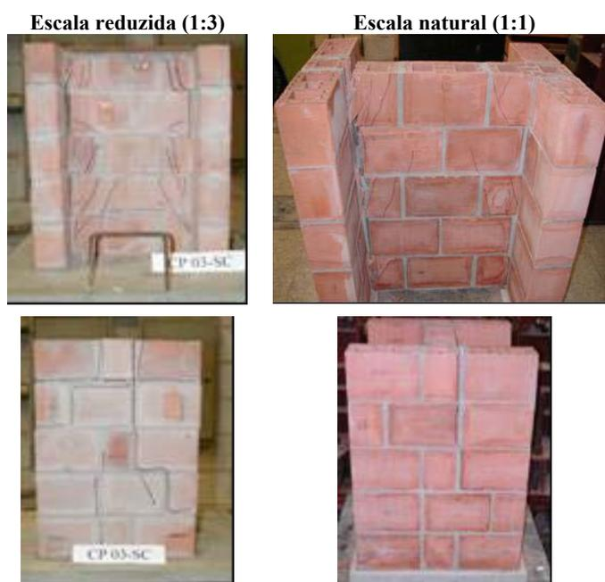
**Figura 7.15 - Comparação entre as formas de ruptura para as diferentes escalas**
