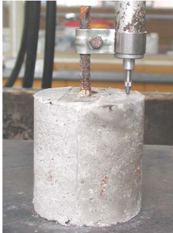
Figura 4.6 – CP's com barra axial (instrumentação com transdutor)
