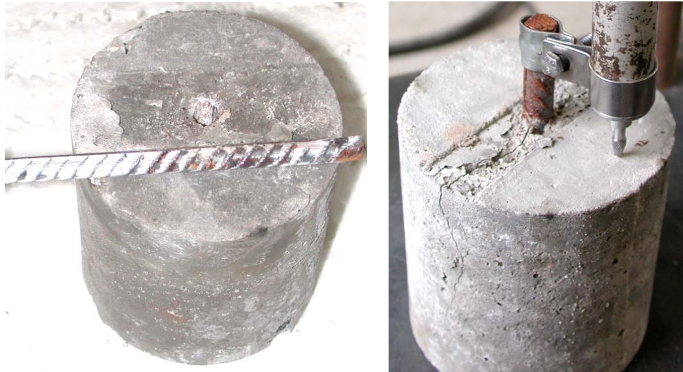
Figura 4.11 – Ruptura por arrancamento (a) e por fendilhamento (b)
