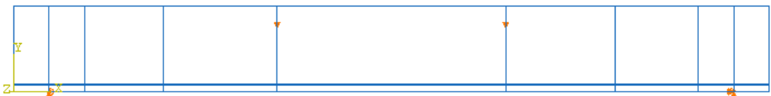
Figura 3.28 – Condições de contorno – apoios e carregamento
