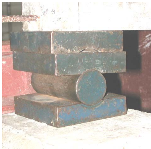
Figura 4.24 – Detalhe do apoio
