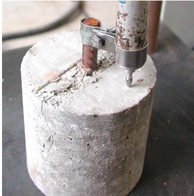
Figura 2.21 – ruptura por fendilhamento
