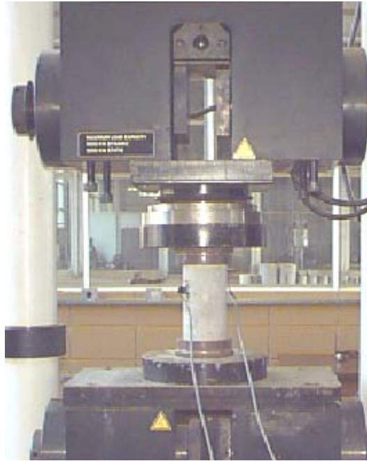
Figura 4.3 – Determinação do módulo de elasticidade do concreto - ensaio realizado na máquina INSTRON
