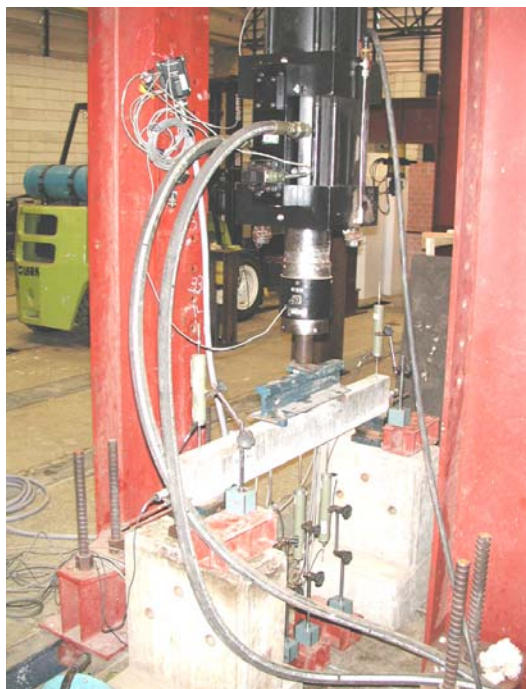
Figura 4.22 – Vista do pórtico, viga e atuador hidráulico
