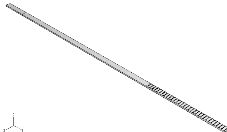
Figura 3.37 – Parte aço para o modelo-metade da viga
