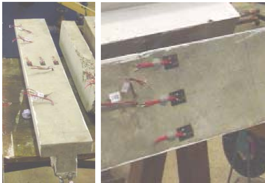
Figura 4.42 – Posicionamento dos extensômetros no concreto
