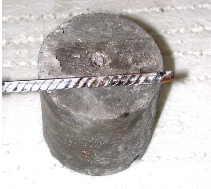
Figura 2.20 – ruptura por arrancamento
