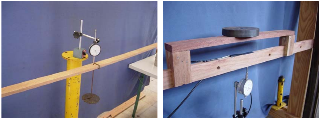
Figura 102 – Ensaio de flexão estática dos sarrafos (menor e maior inércia)
