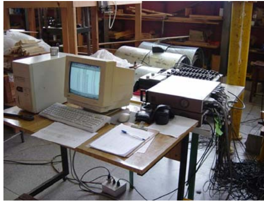
Figura 105 – Sistemas de aquisição de dados
