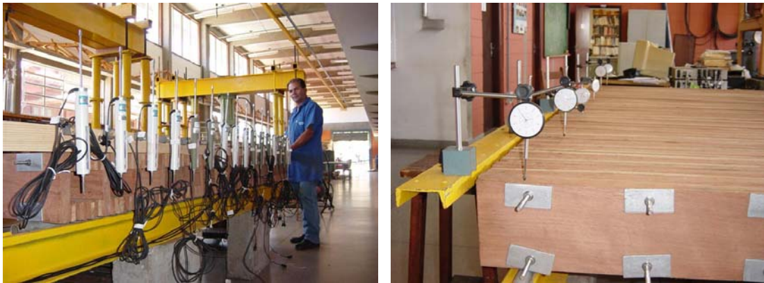
Figura 109 – Transdutores de deslocamento KYOWA e MITUTOYO
