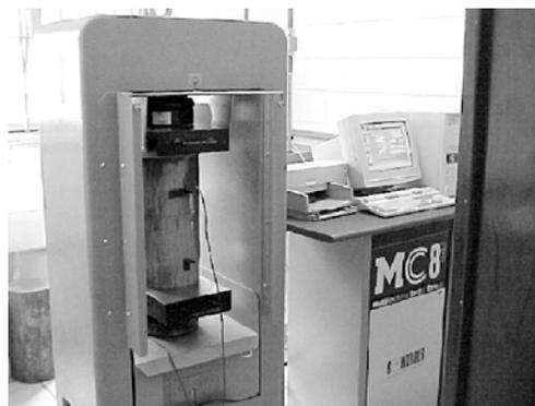
Figura 21 - Ensaio de compressão paralela às fibras em peça estrutural.
