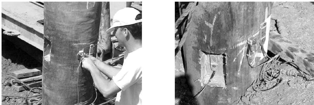
Figura 32 - Instrumentos fixados na parte externa e na parte interna de estaca de madeira.
