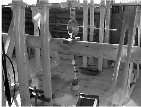
Figura 18 - Ensaio de flexão estática em poste de madeira
