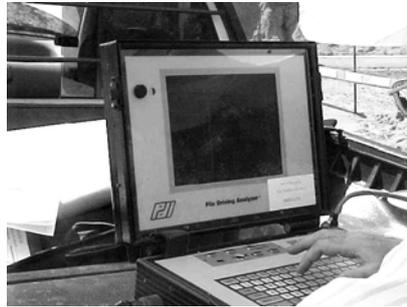
Figura 31 - PDA modelo PAK, usado para monitoração da cravação das estacas.
