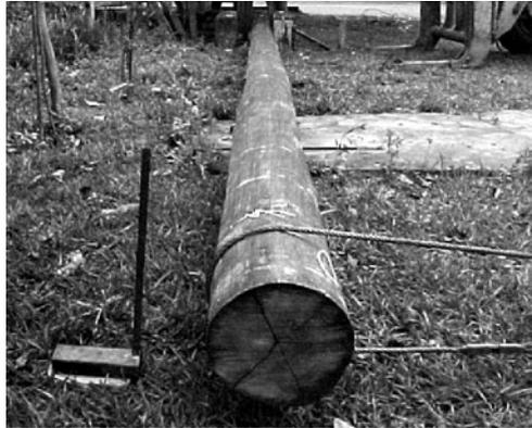
Figura 23 - Ensaio de flexão em estaca
