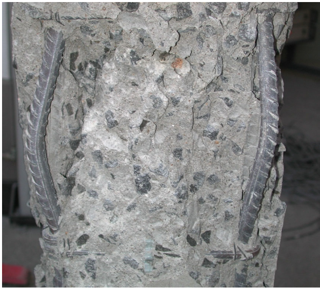
Figura 5.20 – Detalhe das barras da armadura longitudinal da face 3 do pilar P1-12,5-200
