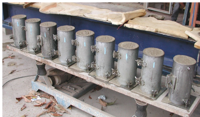
Figura 4.38 – Moldagem dos corpos-de-prova
