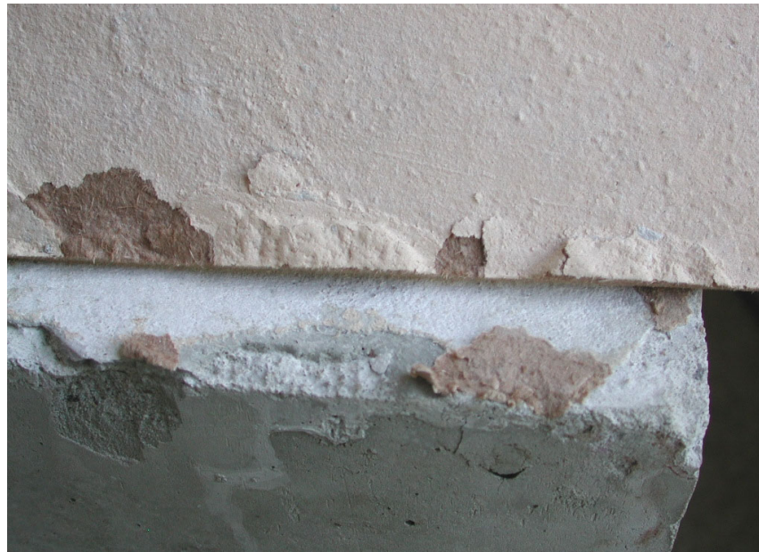
Figura 5.14 – Detalhe de como a almofada se adaptou a irregularidade da extremidade
