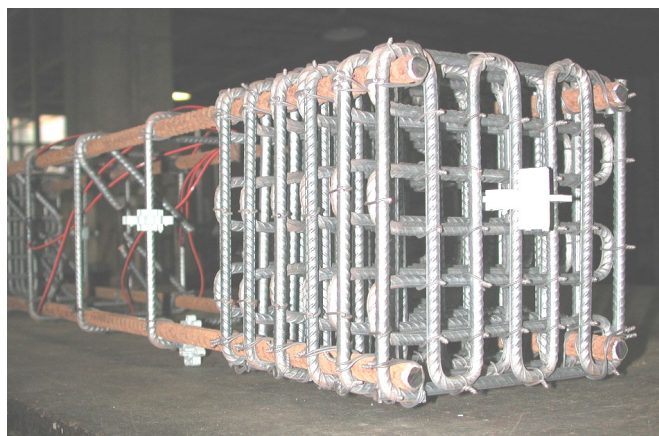
Figura 2.13 – Armadura de fretagem nas extremidades do pilar.
