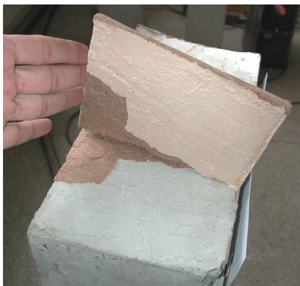
Figura 5.13 – Almofada da extremidade do pilar após o ensaio
