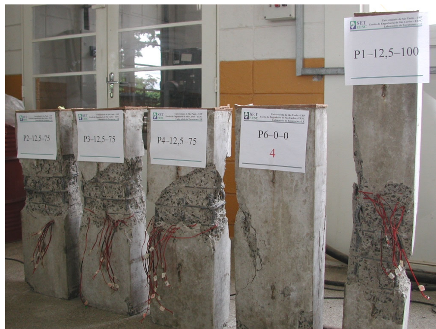
Figura 5.15 – Modelos da quarta concretagem após os ensaios
