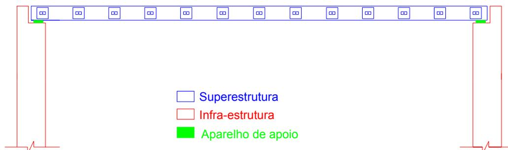
**Figura 6** – Partes principais das pontes de madeira laminada protendidas.
