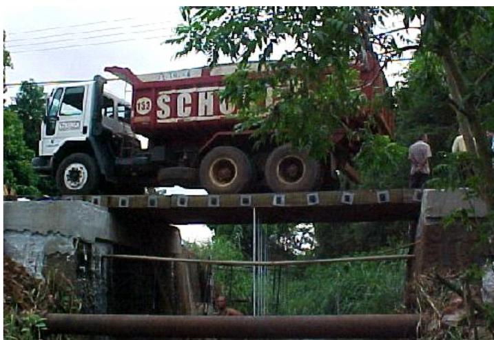
**Figura 70** – Veículo posicionado na ponte, para prova-de-carga.
