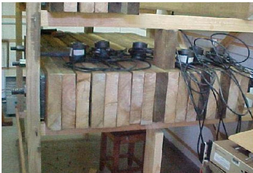
**Figura 49** – Ensaio de perda de protensão em corpos-de-prova, com temperatura e umidade controladas.
