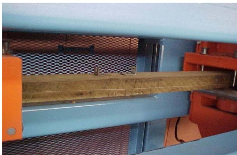
**Figura 45** – Ensaio de tração em peças estruturais – fotografia.
