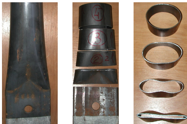
Figura A.1 - Seccionamento das extremidades dos banzos \Phi 76x2,0
