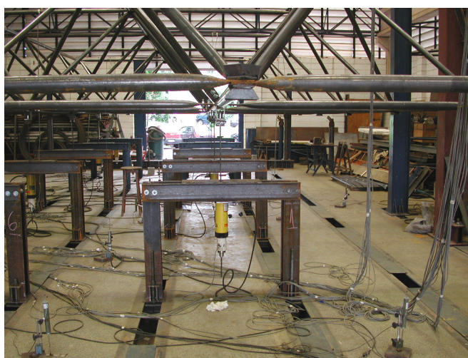
Figura 3.3 - Detalhe dos atuadores
