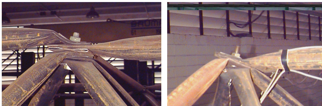
Figura 2.28 - Flexão de extremidade da barra em um nó típico.
