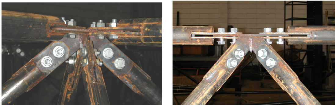
Figura 2.34 - Nó com chapa de ponteira.
