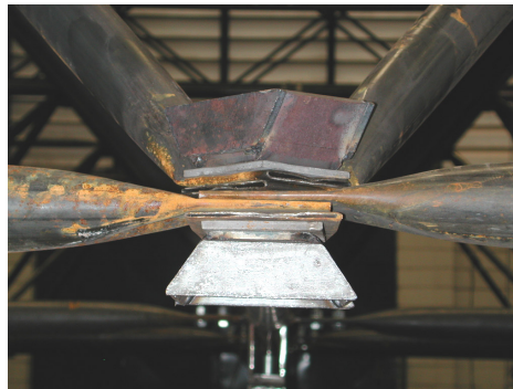
Figura 3.12 - Detalhe da ligação da treliça TE1-R
