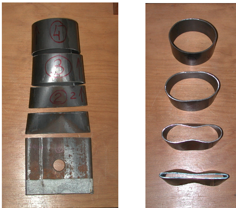
Figura 3.26 – Seccionamento do tubo estampado - Banzo do nó típico
