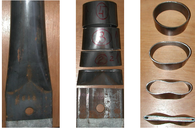
Figura A.5 - Seccionamento das extremidades dos banzas \Phi 76x2,0
