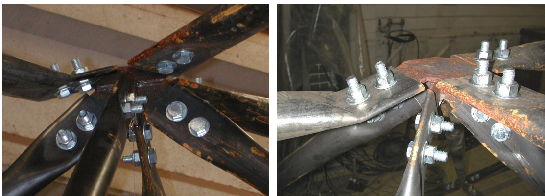
Figura 5.5 - Configuração de colapso do nó de canto da treliça TE4
