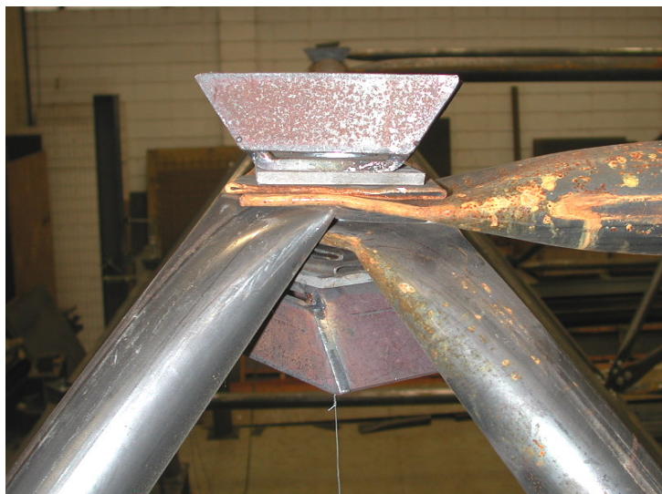
Figura 4.2 - Detalhe do reforço da treliça TE1-R
