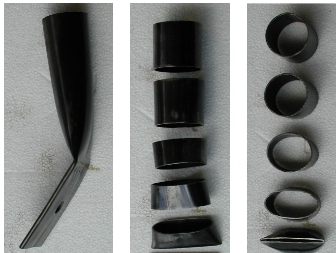
Figura A.3 - Seccionamento das extremidades das diagonais \Phi 60x2,0
