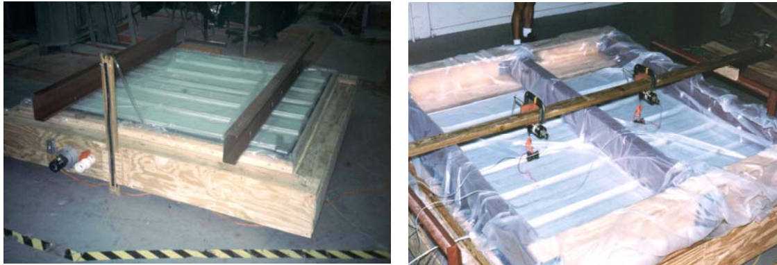
Figura 43 – Disposição do modelo em caixa de vácuo (vedação).
