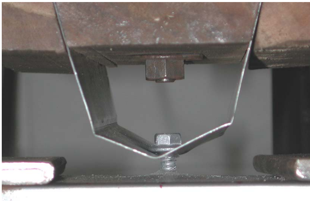
Figura 70 –Arrancamento do parafuso da terça ( pull out )
