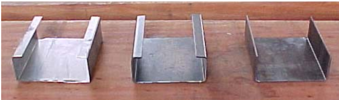
Figura 52 – Seguimentos de terças utilizadas nos ensaios.
