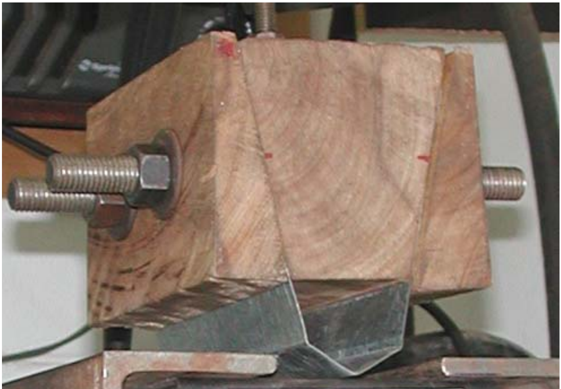
Figura 62 - Fixação da fatia de telha no aparato de ensaio, dispositivo produzido para o estudo.
