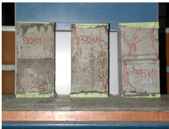
Figura 4.67 –Carga máxima aplicada ( i = 0\% e e = 10\text{mm} ) – V5L30F3
