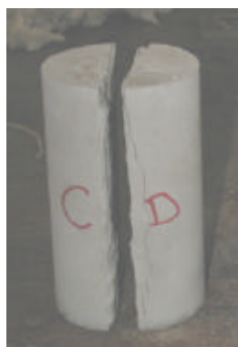
Figura 4.33 – Corpos-de-prova no traço V0L0F0 (argamassa simples) após ensaio de tração por compressão diametral
