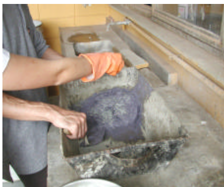
Figura 3.13 – Aplicação de fibra de PVA à mistura, após colocação de cimento, areia, vermiculita, látex e água, respectivamente
