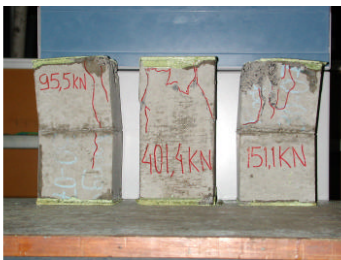
Figura 4.70 –Carga máxima aplicada ( i = 5\% e e = 10\text{mm} ) – V5L30F3
