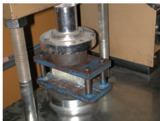
Figura 3.6b – Ensaio de tração por compressão diametral (b)
