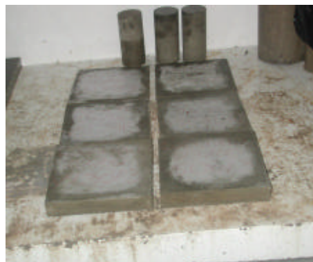
Figura 3.18 – Colocação das placas desmoldadas na câmara úmida para aguardar a cura de 7 dias
