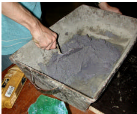
Figura 3.3a – Moldagem com colher de pedreiro logo após colocação de água
