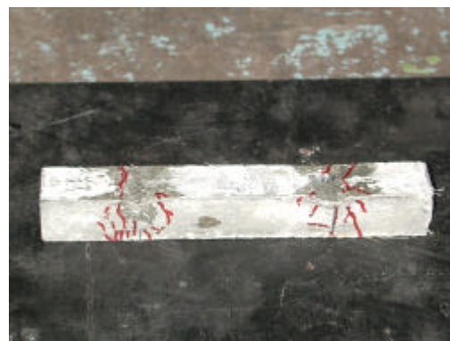
Figura 4.56 – Afundamento de placa de 20mm em duas linhas
