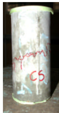
Figura 4.30 – Corpo-de-prova no traço V5L30F4 após ensaio
