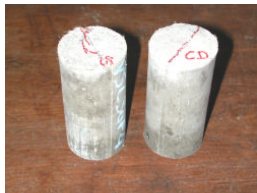
Figura 4.32 – Corpos-de-prova no traço V5L30F4 após ensaio de tração por compressão diametral
