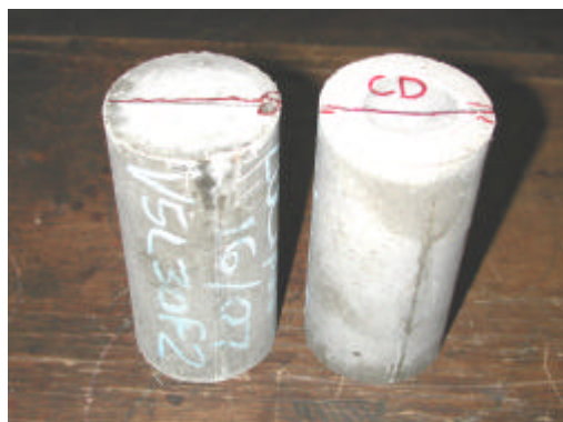
Figura 4.31 – Corpos-de-prova no traço V5L30F2 após ensaio de tração por compressão diametral
