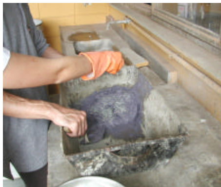
Figura 3.3c – Aplicação de fibra à mistura, após colocação de cimento, areia, vermiculita, látex e água, nesta seqüência
