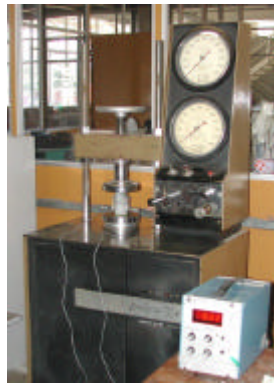
Figura 3.8a – Ensaio para obtenção do módulo de elasticidade (a)
