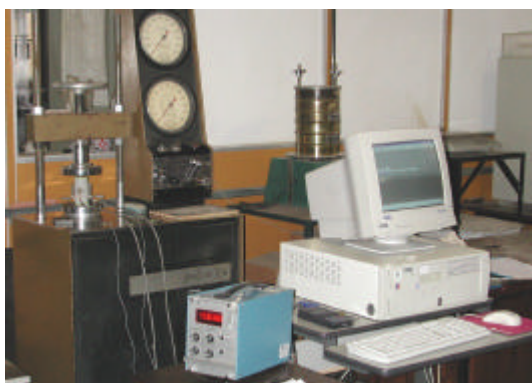
Figura 3.10a – Ensaio para obtenção do módulo de elasticidade em corpos-de-prova por meio de transdutores e extensômetro (a)
