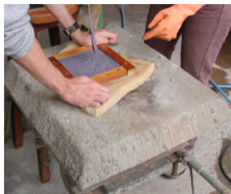
Figura 3.14 – Adensamento em mesa vibratória, após aplicação da fibra de PVA
