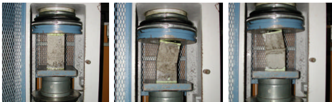
Figura 3.30 – Aplicação de carga na ELE em protótipos da série 2
