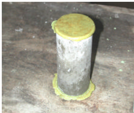
Figura 3.7 – Corpo-de-prova após capeamento para ser ensaiado
