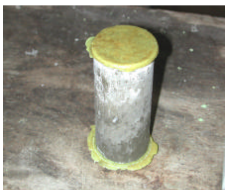
Figura 3.4a – Corpo-de-prova após capeamento para ser ensaiado
