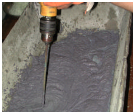
Figura 3.3b – Moldagem utilizando máquina para facilitar a mistura
