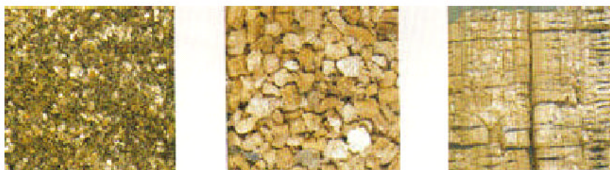
Figura 2.1 – Vermiculita: natural, expandida e partícula expandida
