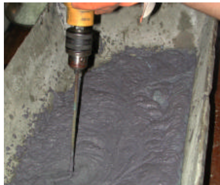
Figura 3.12 – Moldagem utilizando máquina para facilitar a mistura
