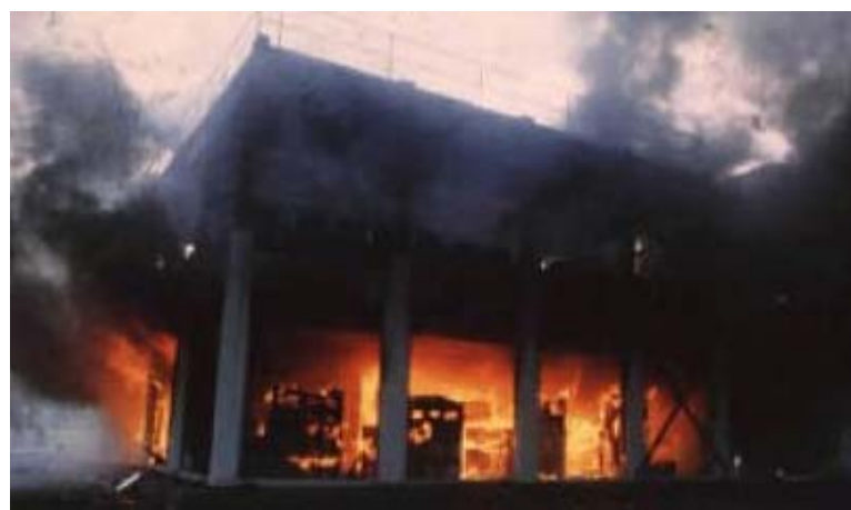
FIGURA 3.6: Teste de resistência ao fogo executado pela BHP na Austrália:
