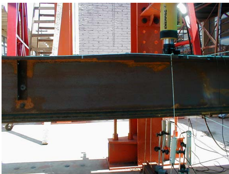
Figura 58 Detalhe em vista frontal do modo de instabilidade distorcional ocorrido no vão central no ensaio do conjunto 23 – Perfil Ue 400x85x25x2,25.
