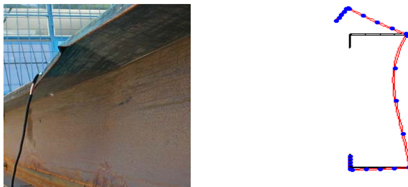
Figura 62 Modo de instabilidade do perfil ensaiado em comparação aos resultados numéricos via faixas finitas.
