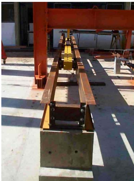
Figura 48 Vista longitudinal do ensaio evidenciando o equipamento hidráulico para aplicação de força e dispositivos de travamentos para união dos perfis.
