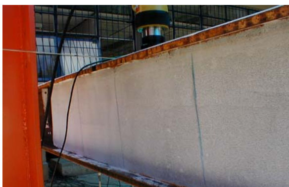
Figura 63 Instabilidade local da alma no conjunto 23, perfil A - Perfil Ue 400x85x25x2,25.
