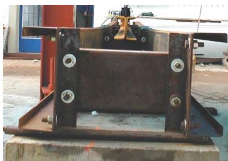
Figura 43 Detalhe do travamento lateral entre perfis.
