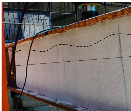
Figura 25 Curvatura dupla longitudinal da alma devido a distorção na flexão de perfil U enrijecido.
