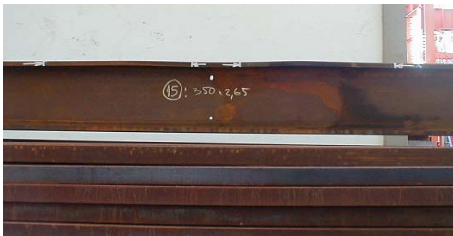
Figura 60 Comprimento de meia-onda entre os pontos de inflexão do perfil tipo Ue 350x85x25x2,65 – conjunto 15.
