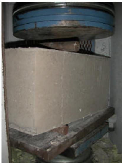
**Figura 3.9 – Ensaio à tração indireta do bloco vazado de concreto.**
