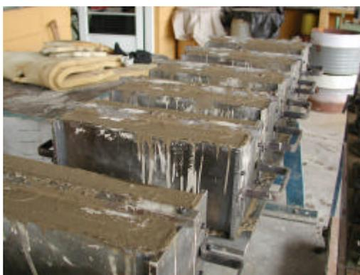
**Figura 3.3 – Blocos após a concretagem antes do acabamento final do topo.**
