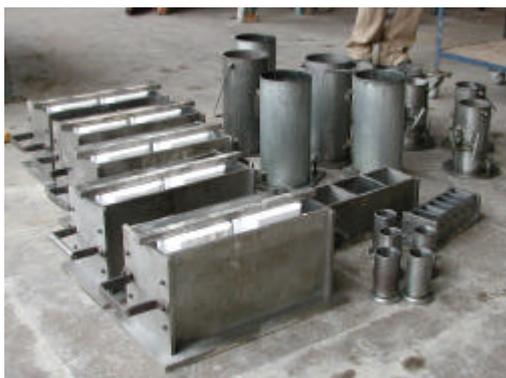
**Figura 3.12 – Fôrmas utilizadas na moldagem dos diferentes tipos de corpos-de-prova e dos blocos de concreto.**
