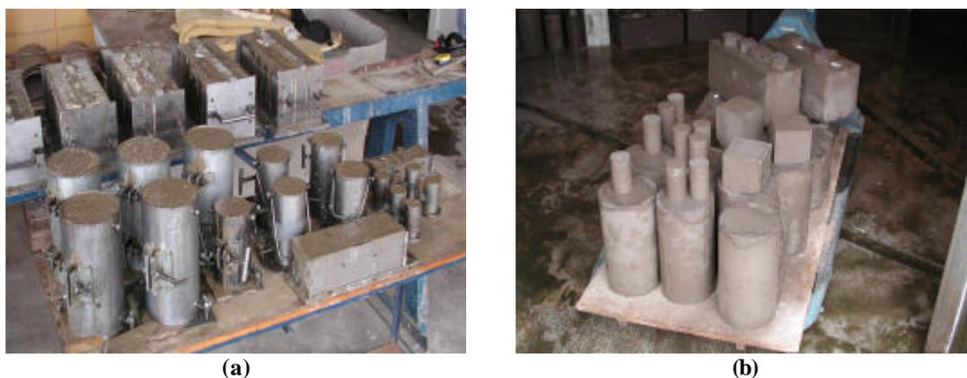
Figura 3.14 – Elementos após a concretagem (a) e sendo colocados na câmara úmida (b).
