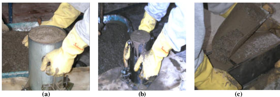
Figura 3.13 – Adensamento dos corpos-de-prova cilíndricos 15 x 30 cm (a), 10 x 20 cm (b) e cúbicos(c).
