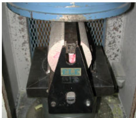
**Figura 3.16 – Ensaio de resistência à tração por compressão diametral.**
