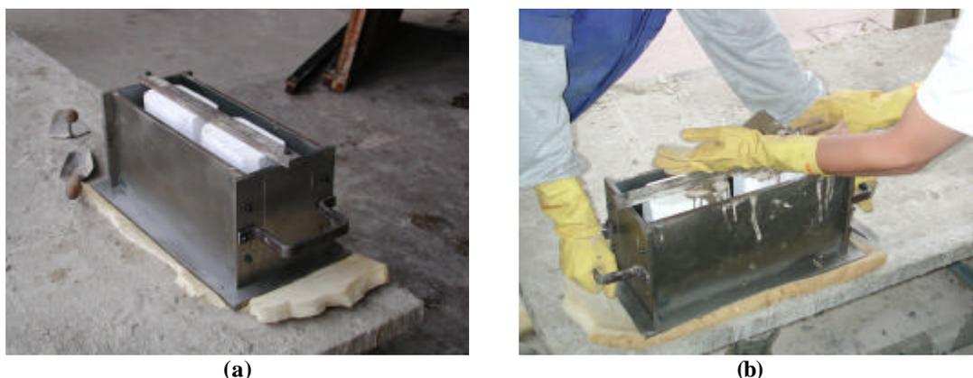
**Figura 3.2 - Fôrma preparada para concretagem sobre a mesa vibratória (a). Concretagem e adensamento dos blocos de concreto (b).**
