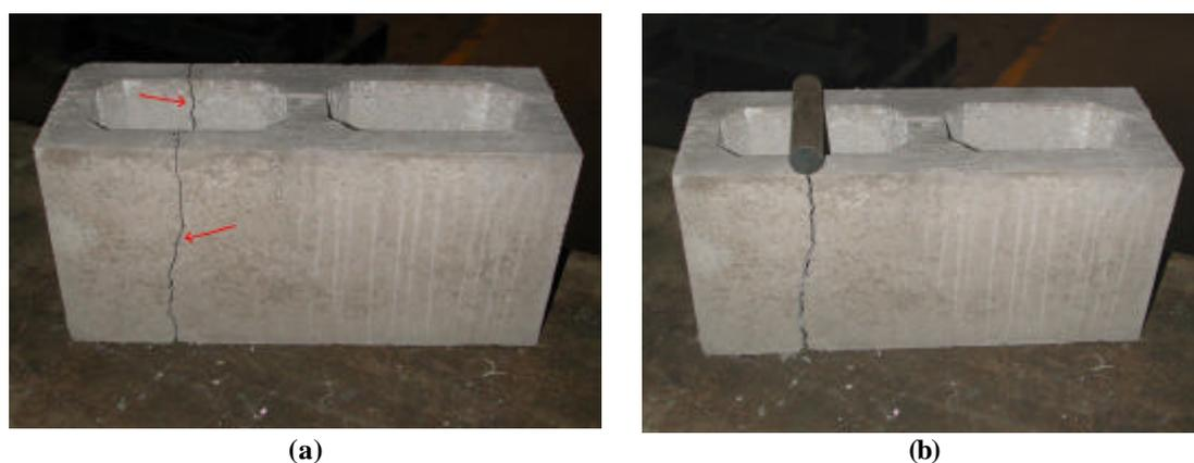
**Figura 3.11 – Fissura interna e externa na parede longitudinal<sup>3</sup> (a) e separação do bloco abaixo da linha de aplicação da força.**
