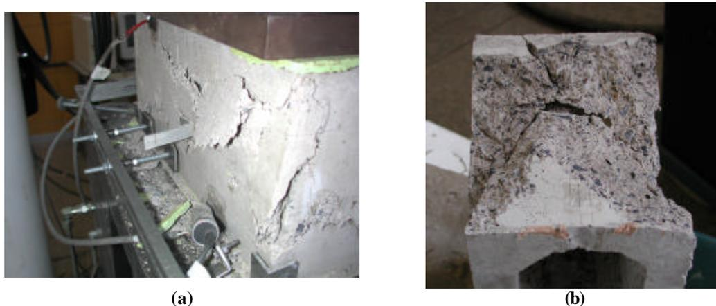
**Figura 3.10 – Configuração da ruína do bloco: fissuras inclinadas e destacamento do concreto na parede longitudinal (a) e septo transversal após ruína (b).**
