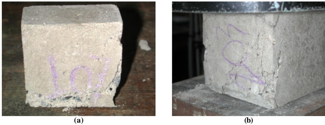
**Figura 3.17 – Caracterização da ruína do corpo-de-prova prismático (a) e cúbico (b).**
