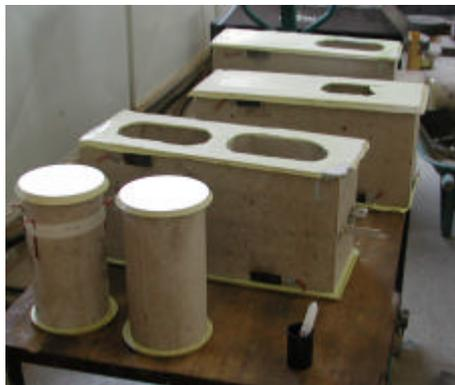
Figura 3.4 – Blocos e corpos-de-prova capeados com enxofre.
