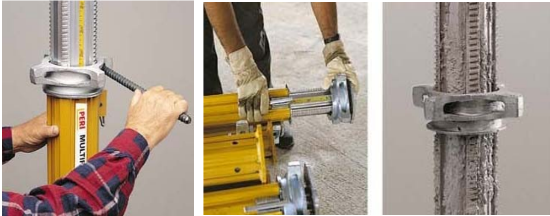
Figura 3.3 - Detalhes de escoras em alumínio
