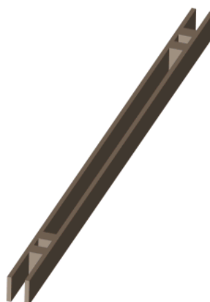
Figura 5.1 - Desenho esquemático de uma longarina.
