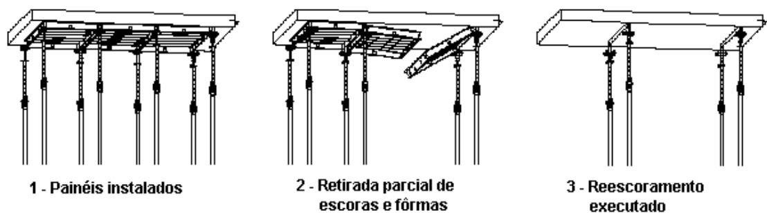
Figura 5.3 - Desmontagem dos painéis de fôrmas no processo construtivo racionalizado.
