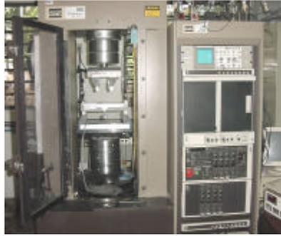
Figura 4.15- Prensa “MTS” para ensaios de flexão com controle de deslocamento.
