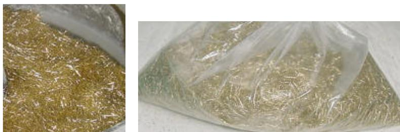
Figura 3.3- Fibras metálicas importadas
