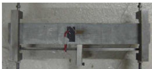
**Figura 4.21- Extensômetro fixado na borda superior da seção central.**
