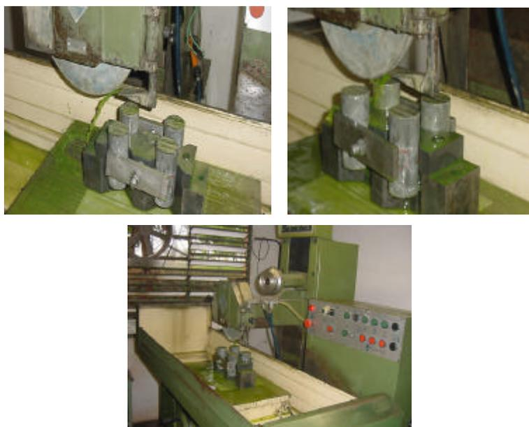
Figura 4.37- Planificação do topo e base dos modelos cilíndricos em retífica mecânica.
