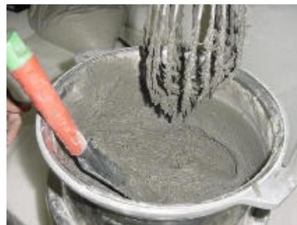
**Figura 4.27-** Mistura com fibras metálicas pronta para moldagem dos modelos.
