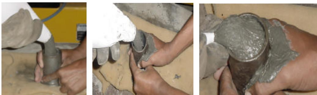
**Figura 4.29-** Moldagem dos modelos cilíndricos.
