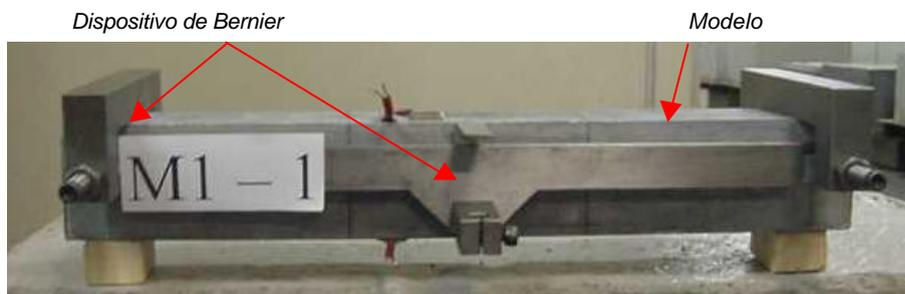
**Figura 4.19- Modelo com o dispositivo de Bernier acoplado.**
