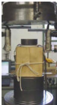
**Figura 4.6-** Dispositivo de proteção para ensaios de compressão em concretos de alta resistência.
