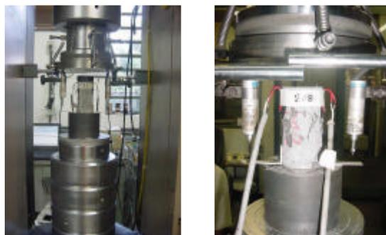
**Figura 4.38- Ensaio de compressão axial.**
