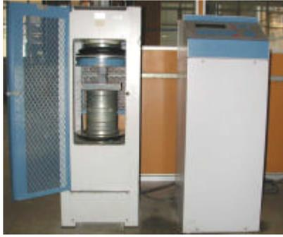
**Figura 4.2- Prensa “ELE” para ensaios de compressão axial.**
