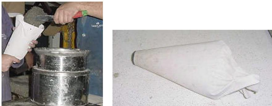
**Figura 4.28-** Bisenaga utilizada para auxiliar na moldagem dos modelos.
