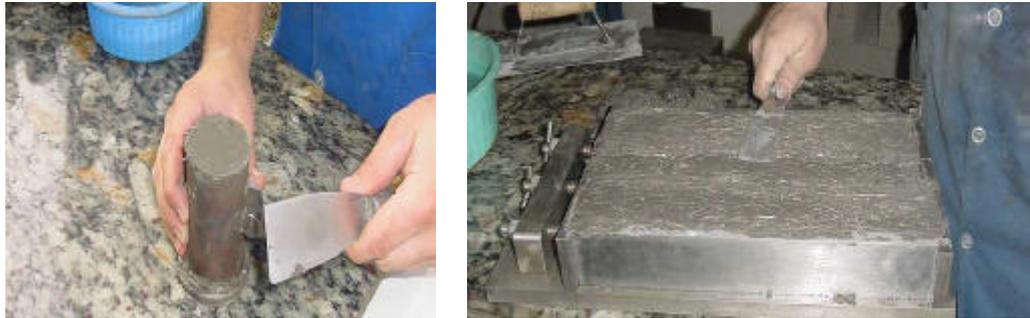
**Figura 4.31- Acabamento da superfície exposta ao ar.**
