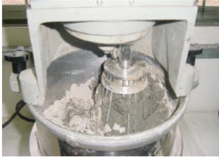
**Figura 4.24-** Adição da água e superplastificante na pré mistura.
