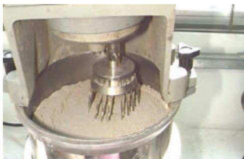
**Figura 4.23- Mistura mecânica dos materiais secos.**
