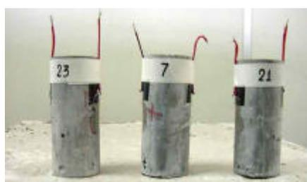
**Figura 4.9-** Extensômetros colocados diametralmente opostos.
