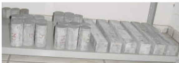
**Figura 4.36- Modelos com mais de 14 dias retirados da câmara úmida.**
