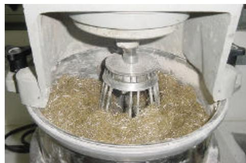
**Figura 4.26-** Adição das fibras metálicas na mistura.
