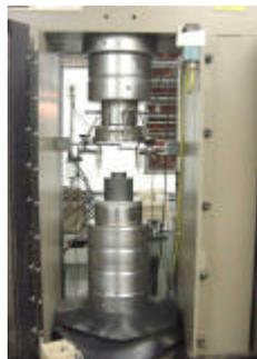
**Figura 4.4- Prensa “MTS” para ensaios de compressão axial com controle de deslocamento.**
