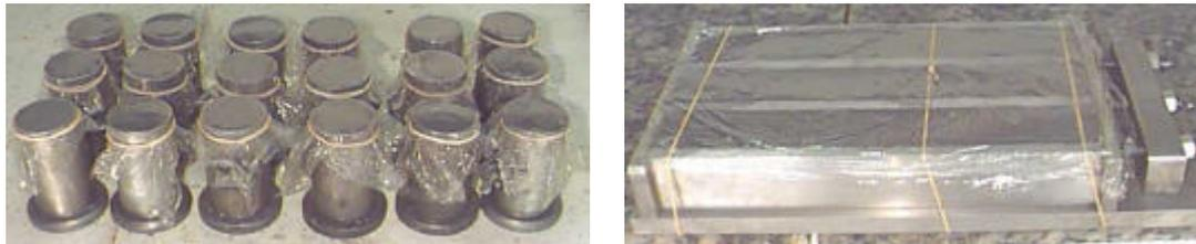
**Figura 4.32- Filme de PVC colocado sobre a superfície exposta dos modelos.**
