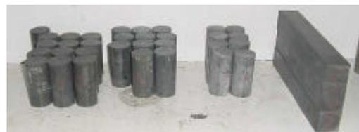
**Figura 4.34- Modelos na câmara úmida depois de retirados das fôrmas.**
