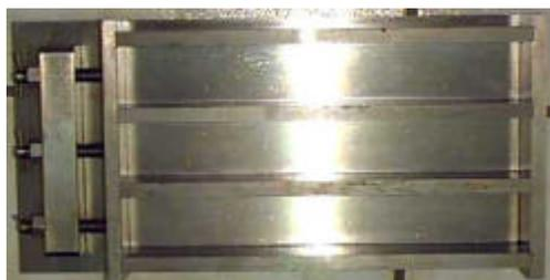
**Figura 4.14- Fotografia da fôrma metálica para os modelos prismáticos.**
