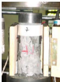
**Figura 4.7-** Dispositivo de proteção com modelo rompido.
