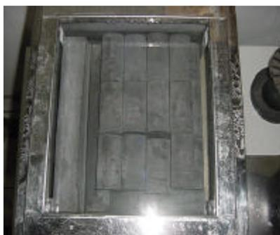
**Figura 4.35- Modelos submetidos a cura térmica em equipamento “*Banho Maria*”.**
