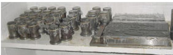
**Figura 4.33- Modelos na câmara úmida nas primeiras 24 horas.**
