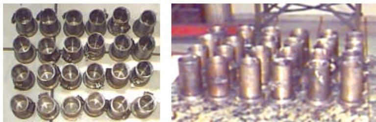
**Figura 4.1- Fôrmas para os modelos dos ensaios de compressão axial**
