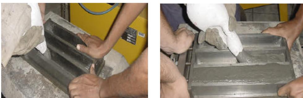
**Figura 4.30-** Moldagem dos modelos prismáticos.
