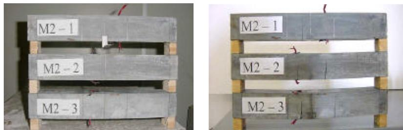
Figura 4.42- Forma de ruptura dos modelos da série M2
