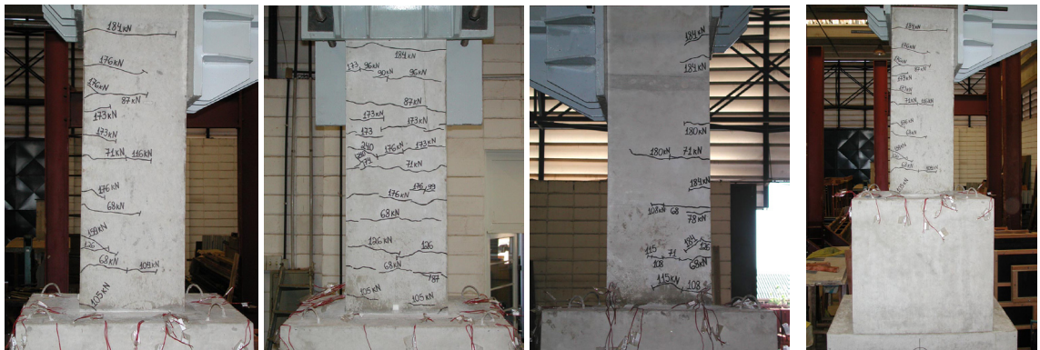
(a) Face frontal (b) Face tracionada (c) Face posterior Figura 5.1 - Ruptura por flexão do pilar
