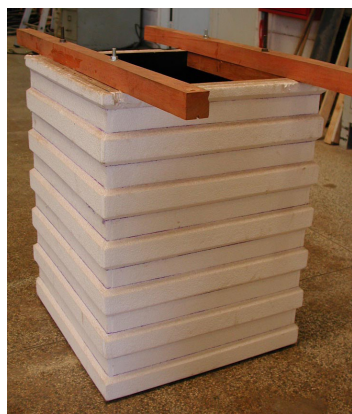
Parte interna da fôrma do Modelo IR1
