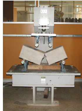
Figura 4.30 – Obtenção da resistência à tração na flexão do concreto na máquina ELE
