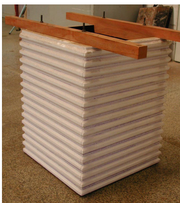
Parte interna da fôrma do Modelo IR2
