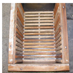
Rugosidade na fôrma do Modelo IR2
