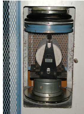
Figura 4.29 – Obtenção da resistência à tração por compressão diametral do concreto na máquina ELE
