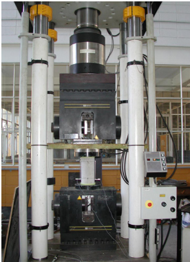
Figura 4.28 – Caracterização do concreto à compressão na máquina universal INSTRON
