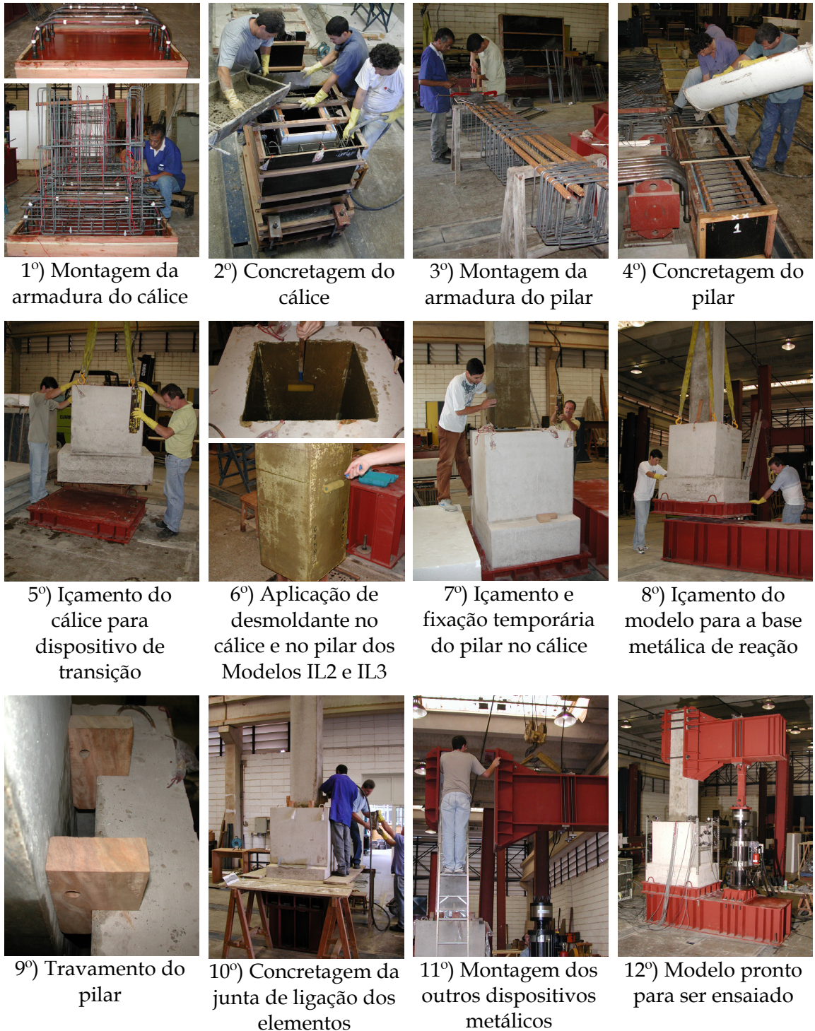
Figura 4.13 - Etapas de confecção e montagem dos Modelos IL1, IL2 e IL3
