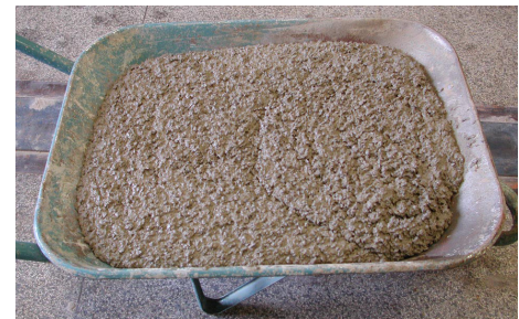
Figura 4.4 – Consistência do concreto da junta
