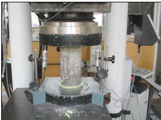
Figura 6.6. Instrumentação dos CPs
