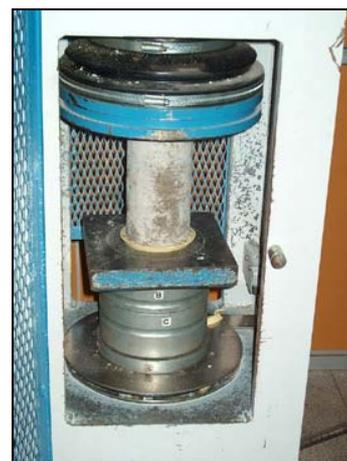
Figura 6.1. Ensaio de resistência à compressão simples.
