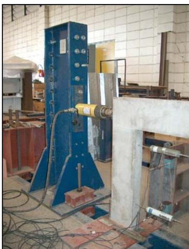
Figura 5.24. Aplicação da força horizontal.
