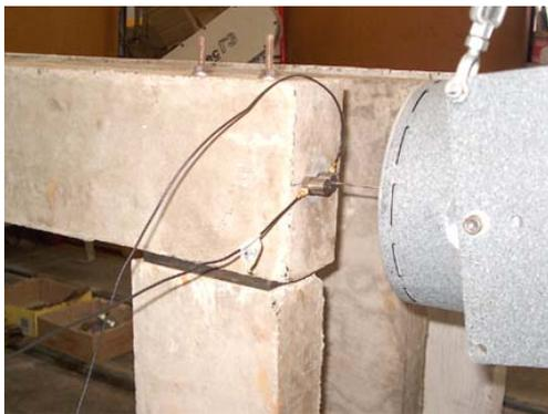
Figura 7.54. Excitação do pórtico semi-rígido.
