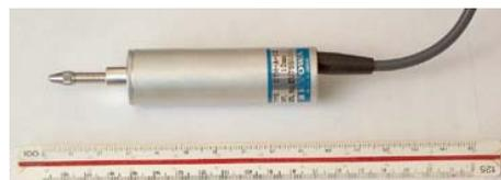
**Transdutor de deslocamento (à base de extensômetro elétrico de resistência)**
