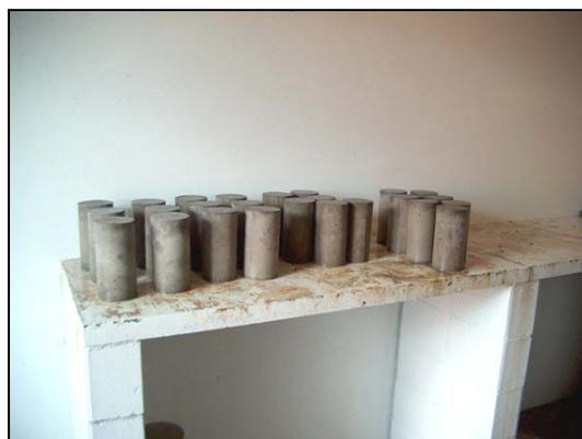
(b) CPs na câmara úmida
