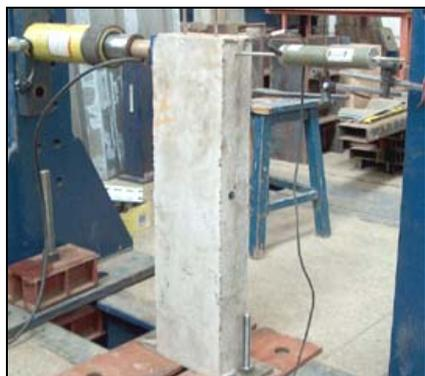
Figura 6.22. Ensaio de flexão dos pilares isolados.
