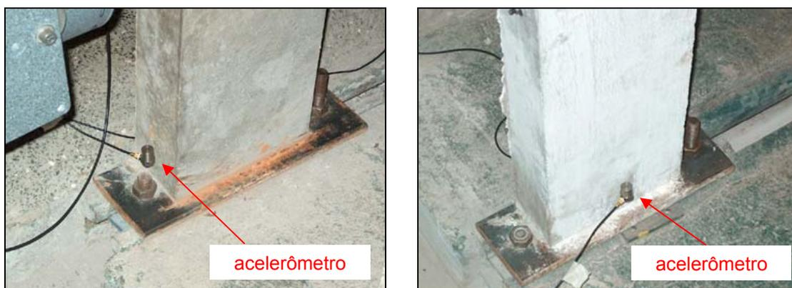
Figura 7.24. Posicionamento dos acelerômetros nas laterais do pilar.
