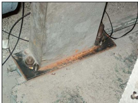
Figura 7.50. Posicionamento dos acelerômetros na base metálica.
