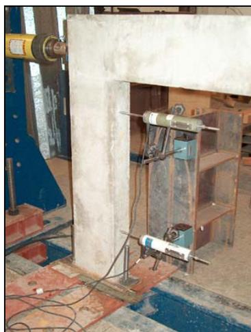
Figura 5.25. Transdutores de deslocamento (esquerda)
