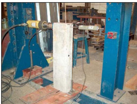
Figura 5.21. Ensaio de flexão dos pilares.
