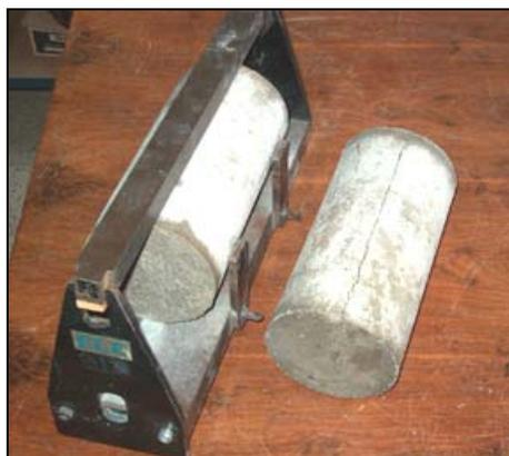
Figura 6.2. Ensaio de resistência a compressão diametral.
