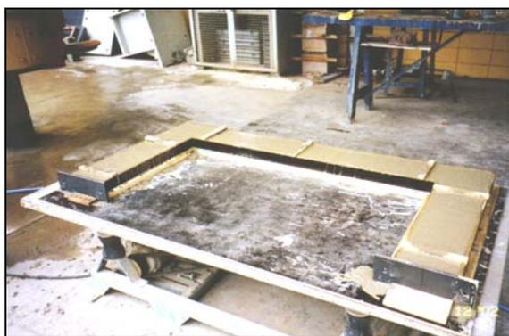
Figura 5.14. Modelo concretado sobre a mesa vibratória.
