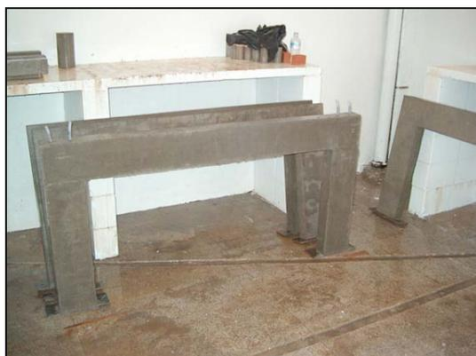
(a) Pórticos na câmara úmida
