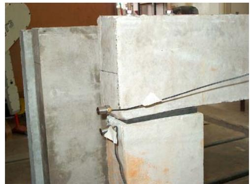
Figura 7.55. Fixação de acelerômetros acima e abaixo da almofada.
