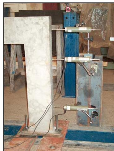
Figura 5.26. Transdutores de deslocamento (direita)
