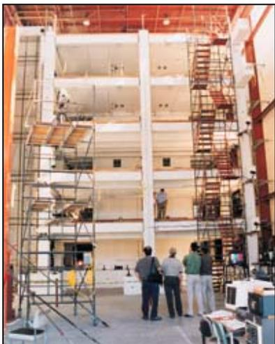
Figura 1.5. Estrutura de ensaio do programa PRESSS-PCI<sup>4</sup>.
