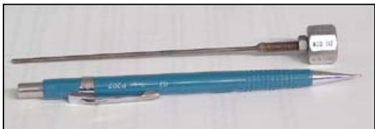
Figura 5.42. Transdutor de força com haste metálica.
