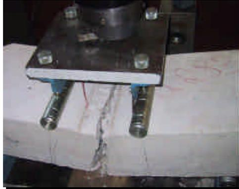
Figura 5.15 – Ruína de uma viga da série Q283 sob carregamento repetido – 90%
