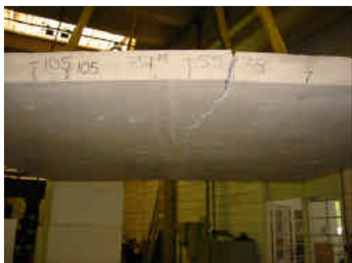
Figura 5.60 - Fissuração do modelo PCA3
