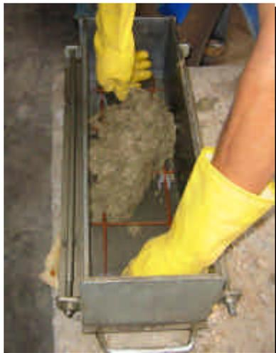
Figura 5.21 – Lançamento do concreto
