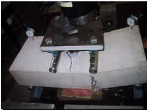
Figura 5.13 – Ruína de uma das vigas da série Q283, sob ação estática
