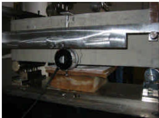
Figura 5.29 – Fissuração de viga sem armadura
