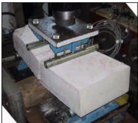
Figura 5.9 – Primeira viga da série Q283 rompida sob ação estática
