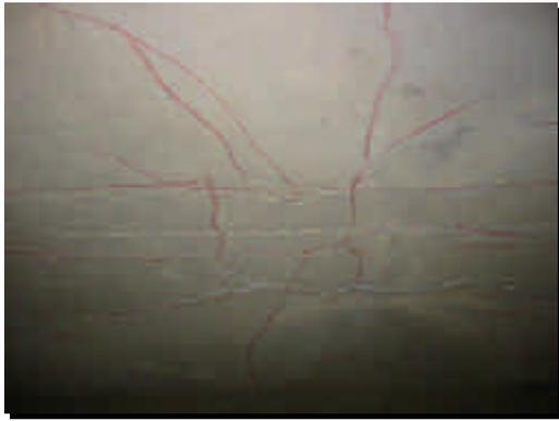
No modelo PCA5 houve a formação de fissuras de flexão em todas as direções, crescendo a partir do centro em direção às bordas. Também se observa a formação de fissuras circunferenciais, em torno da área central da placa.
