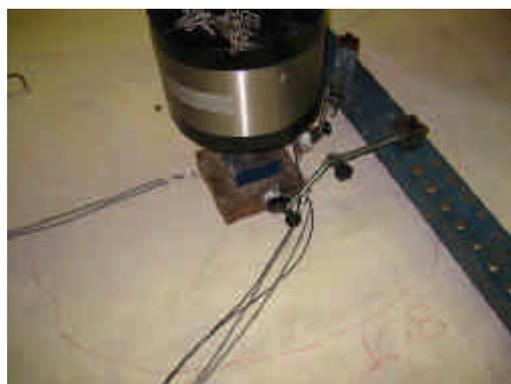
Figura 5.61 – Fissura circunferencial a 40 cm da face da força, modelo PCA3
