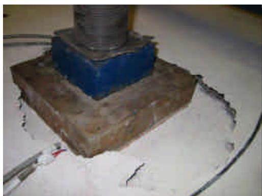
Figura 5.58 – Fissura circunferencial adjacente à face da força, modelo PCA2
