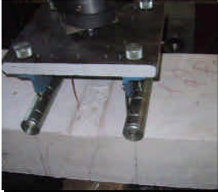
Figura 5.14 – Fissuração de uma viga da série Q283 submetida a carregamento repetido – 90%
