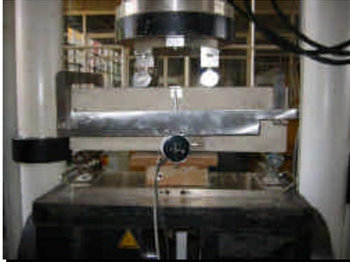
Figura 5.22 – Posicionamento do transdutor vertical
