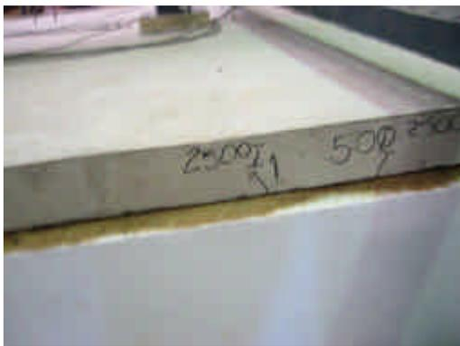
Figura 5.72 – Abertura de fissuras na borda do modelo PCA5
