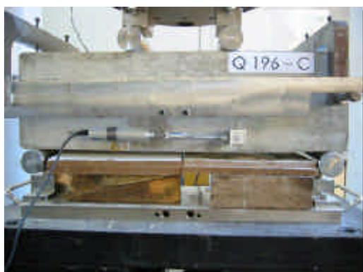
Figura 5.31 – Fissuração de viga com tela Q196
