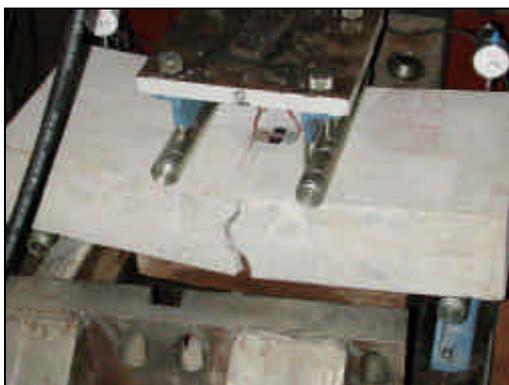
Figura 5.8 – Viga rompida sob carregamento estático
