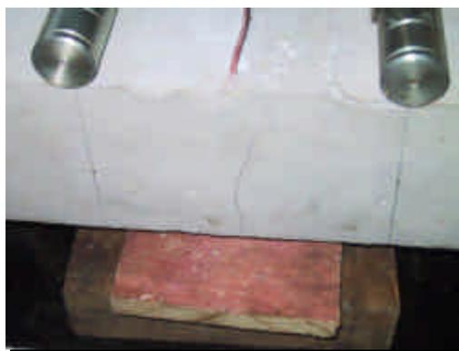
Figura 5.10 – Formação da primeira fissura no ensaio estático da série Q283
