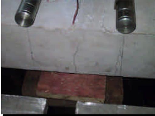
Figura 5.11 – Formação da segunda fissura no ensaio estático da série Q283, à direita
