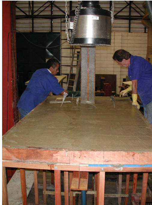
Figura 5.36 – Fase de acabamento na laje no modelo CTM-T
