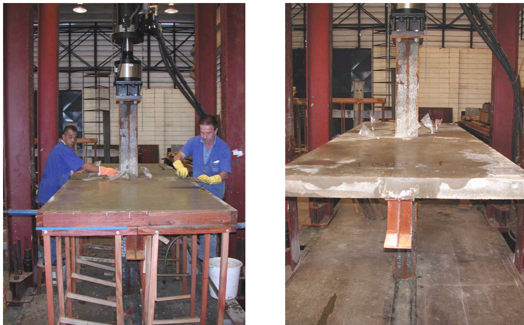
Figura 5.32 – Foto do acabamento do concreto e do modelo assim que a forma foi retirada
