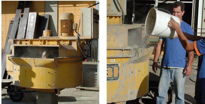
Figura 5.29 – Detalhe da betoneira do Laboratório e colocação de material para mistura
