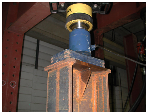
Figura 5.19 – Detalhe do ponto de aplicação do carregamento no pilar
