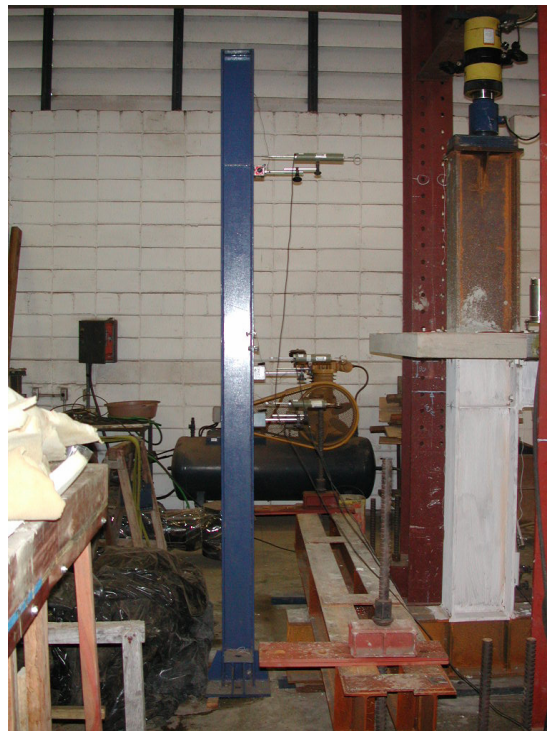
Figura 5.45 – Transdutores de deslocamento no pilar
