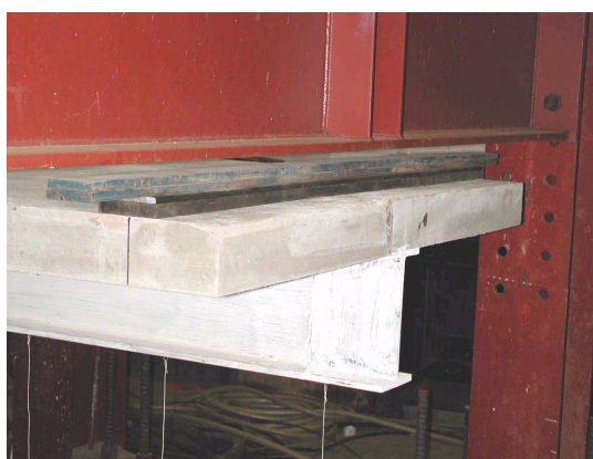
Figura 5.33 – Detalhe da borracha de neoprene
