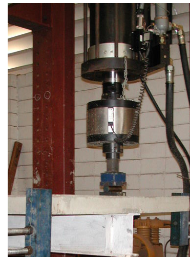
Figura 5.20 – Detalhes da aplicação do carregamento nas extremidades das vigas dos modelos em “T”
