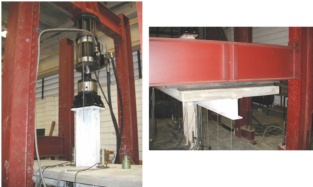
Figura 5.15 – Detalhe da aplicação do carregamento no modelo misto e do apoio da laje na viga do pórtico
