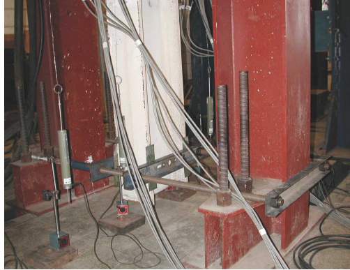
Figura 5.25 – Travamento do pilar no modelo CTA-C2
