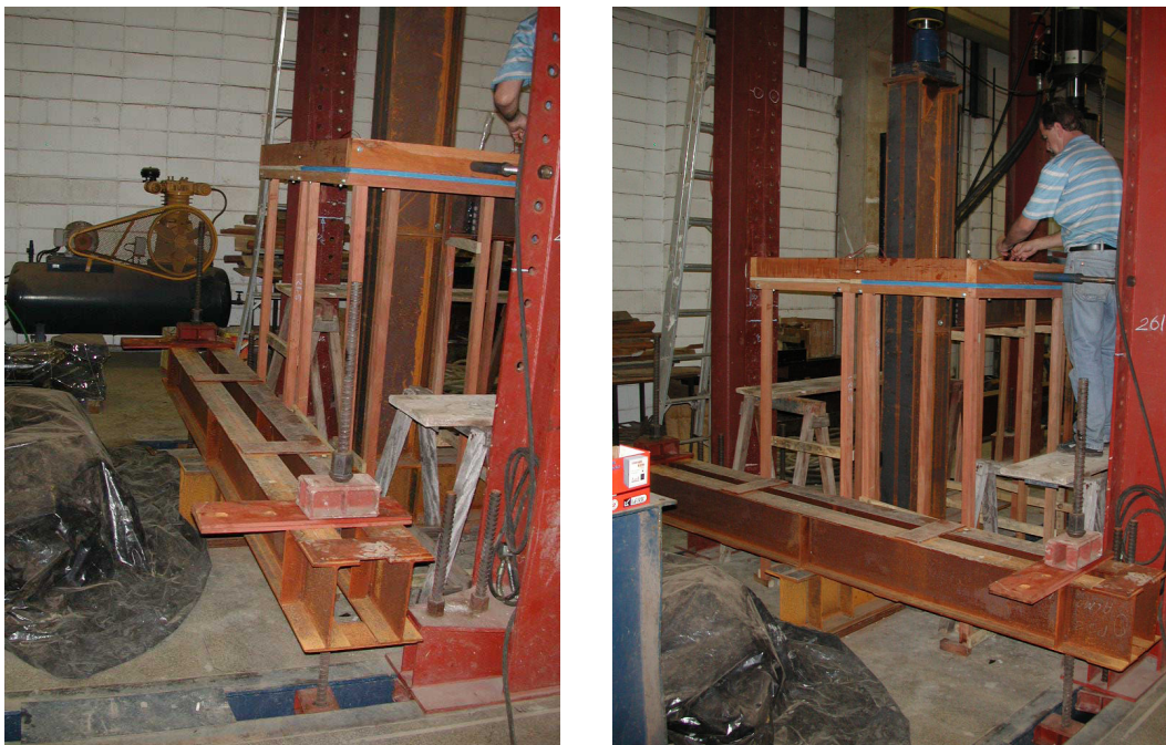
Figura 5.22 – Trava horizontal dos modelos em “T”
