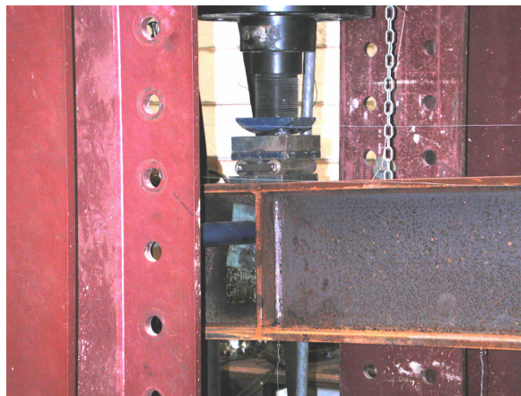
Figura 5.20 – Detalhes da aplicação do carregamento nas extremidades das vigas dos modelos em “T”
