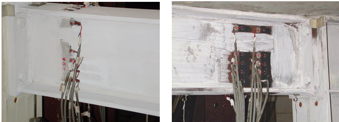
Figura 5.38 – Seções da viga instrumentadas (modelo em aço e modelo misto)
