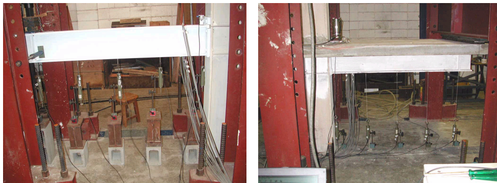
Figura 5.42 – Transdutores de deslocamento nos modelos mistos e em aço.
