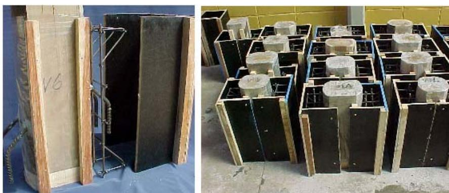
Figura J7 – Detalhe da forma e seu posicionamento para moldagem do corpo-de-prova.
