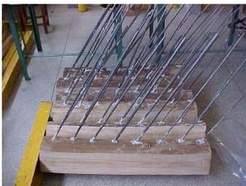
Figura G4 – Corpo-de-prova prontos para os ensaios de ancoragens.
