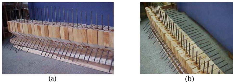
Figura E4 – Corpos-de-prova com as barras de aço coladas.
