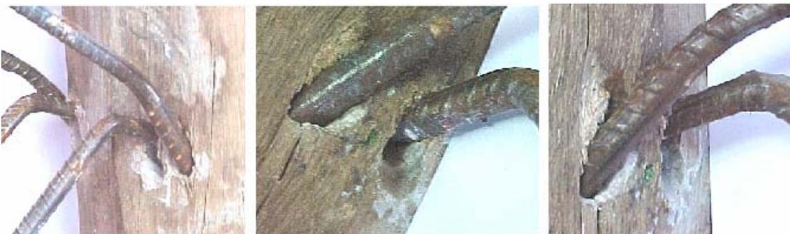
Figura J11 – Barras de aço com grandes deformações, evidenciando os embutimentos na madeira e as rótulas plásticas na barra comprimida.
