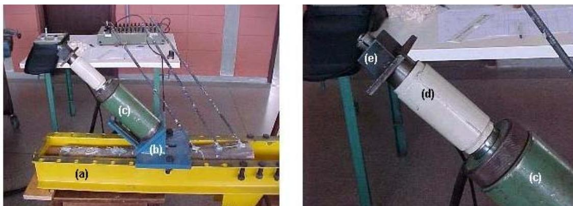
Figura G3 - Ensaio de ancoragem de barras de aço à 45°, em peças estruturais roliças de Eucalipto citriodora, sendo: (a) viga de reação; (b) suporte; (c) cilindro hidráulico; (d) célula de carga; (e) fixação da extremidade externa da barra de aço.
