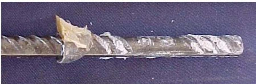
Figura 71 - Falhas de continuidade dos filetes superficiais.
