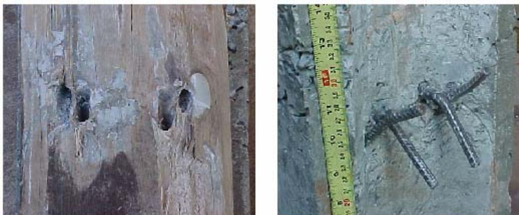
Figura I15 - Forma de ruptura: ambutimento na madeira e barras deformadas.
