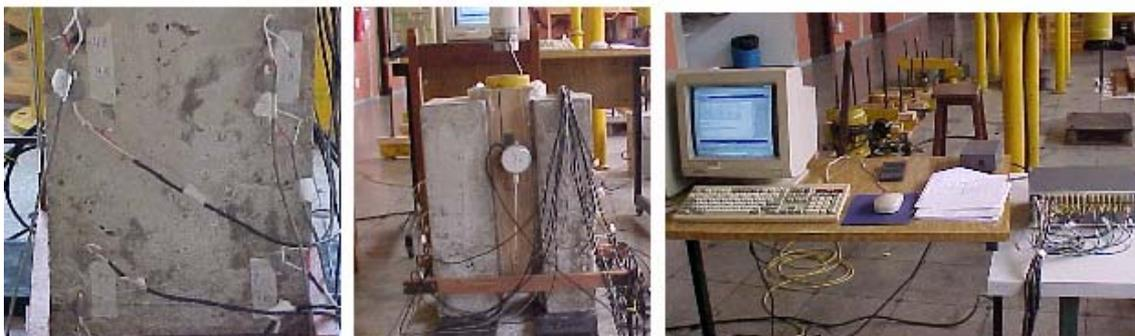
Figura I5 – Detalhes das ligações nos extensômetros; corpo-de-prova instrumentado e o sistema de aquisição de dados.
