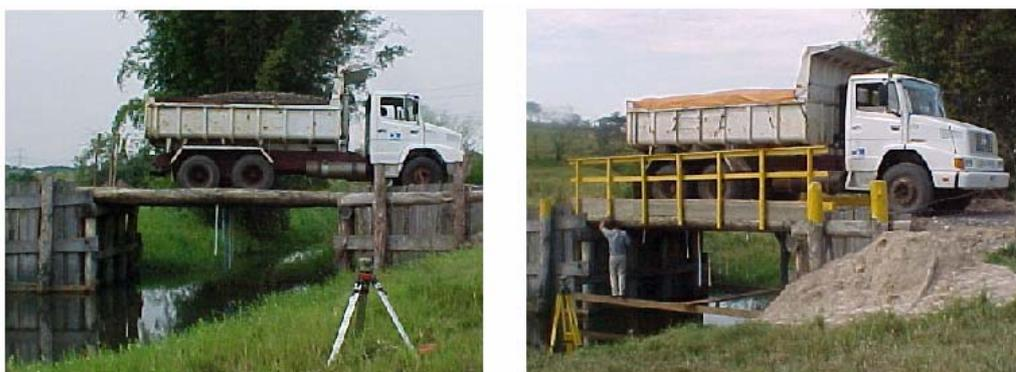
Figura K10 – Provas de carga no tabuleiro de madeira e na ponte concluída. Detalhe do posicionamento do nível óptico e das réguas presas no tabuleiro.
