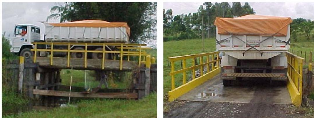
Figura k14 – Terceira prova de carga, carregamentos 1 e 2.
