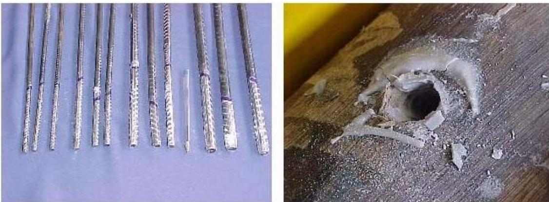
Figura G5 – Formas de ruptura, independentes dos diâmetros das barras e dos comprimentos de ancoragens e aspecto do corpo-de-prova após a retirada da barra de aço.
