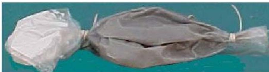
Figura 55 - Componentes A e B da resina Sikadur 32 fluido, em embalagem de polietileno prontos para serem misturados no canteiro de obras.
