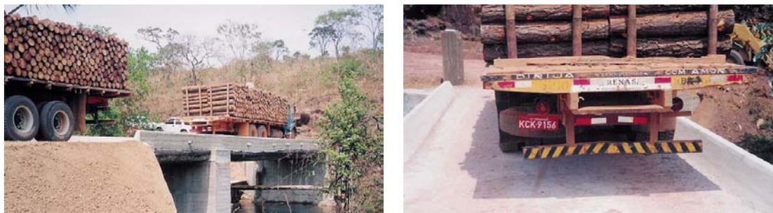
Figura L16 - Vista do veículo 1 na primeira e segunda prova de carga.
