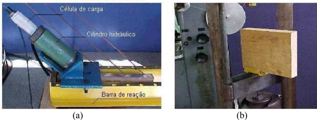
Figura D3 - Ensaio de ancoragem com solicitação axial nas barras de aço coladas, sendo: (a) direção 45°; (b) direções 0° ou 90° em relação às fibras.
