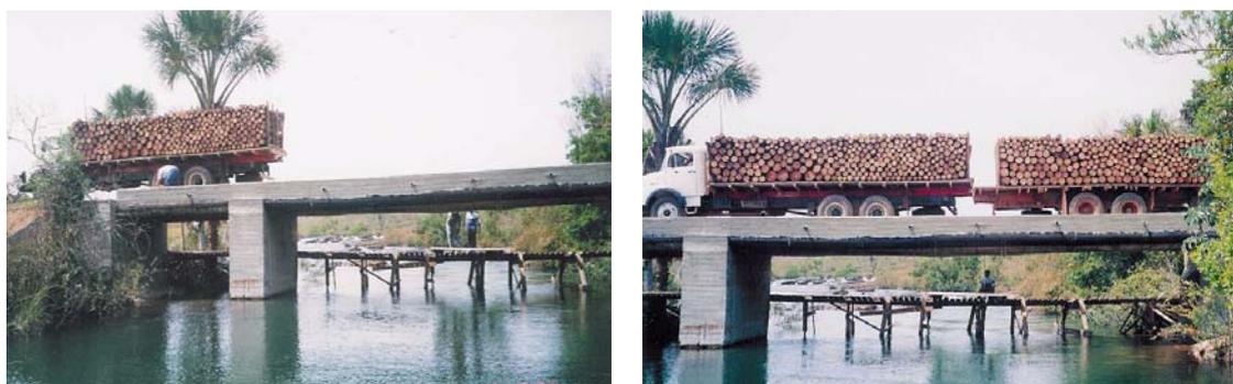
Figura L17 - Vista do veículo 2 na quarta e dos veículos 1 e 2 na quinta prova de carga.
