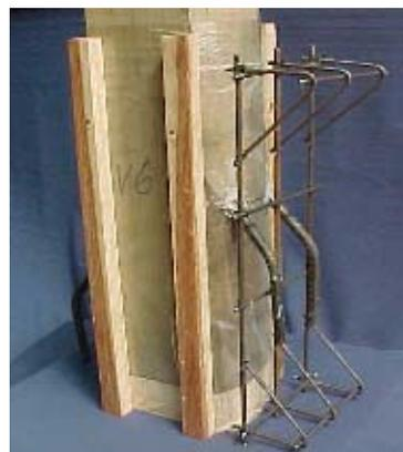
Figura J6 – Armaduras e detalhe do seu posicionamento no corpo-de-prova.
