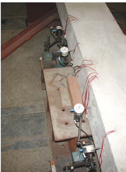
Figura 6.25: Relógios utilizados para medir as rotações do pilar
