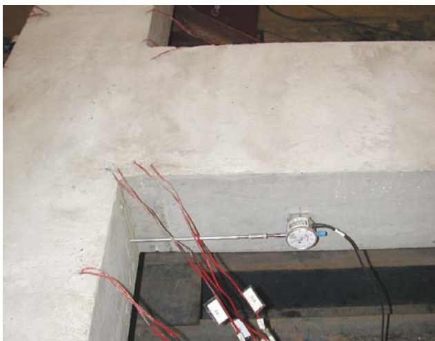
Figura 6.24: Relógio utilizado para medir a rotação relativa viga-pilar (T3 e T4)
