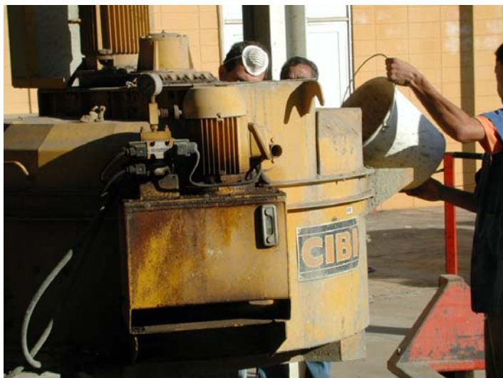
Figura 6.18: Lançamento dos materiais na betoneira: (Modelos LVP1 e LVP2)
