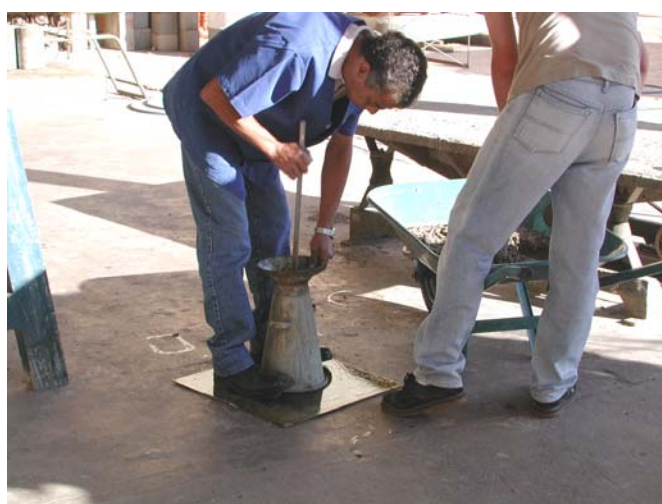
Figura 6.19: Controle do abatimento do tronco de cone
