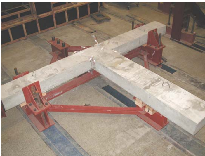
Figura 6.14: Liga o viga-pilar posicionada sobre o quadro horizontal
