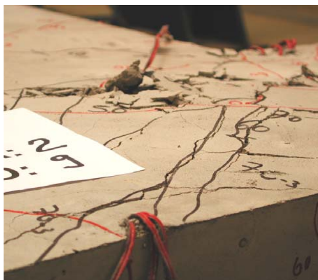
Final do ensaio: detalhe da dilatação do nó
