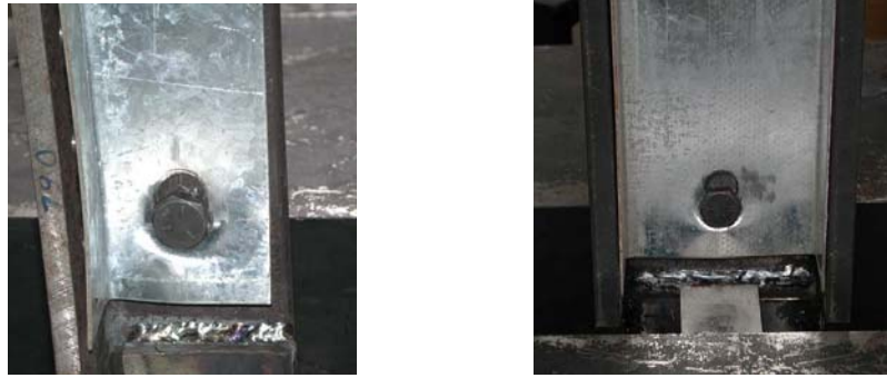
Figura 5.17 - Esmagamento da parede do furo (série A).
