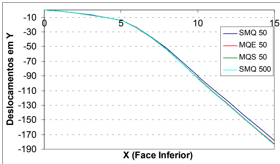
Gráfico 7 – Deslocamentos em Y da face inferior da viga.
