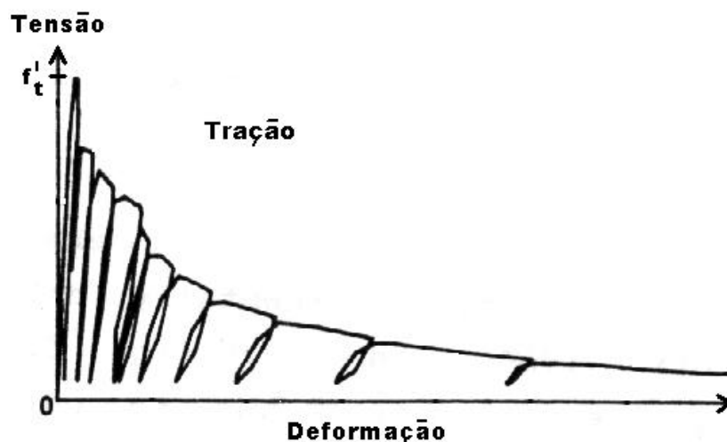
Figura 2.9. Resposta do concreto à tração uniaxial cíclica. (adaptado de Reinhardt et al. , 1986)
