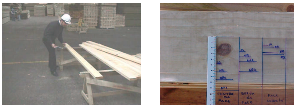
Figura 38 – Classificação visual e detalhe do gabarito de acrílico.
