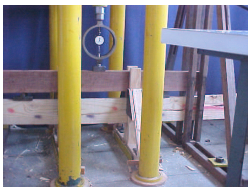
Figura 115 – Ruptura por cisalhamento.
