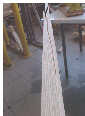
Figura 116 – Ruptura devido à inclinação de fibras.
