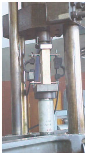
Figura 46 – Transdutores de deslocamento e célula de carga.
