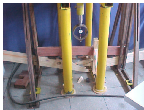
Figura 114 – Ruptura frágil por tração.
