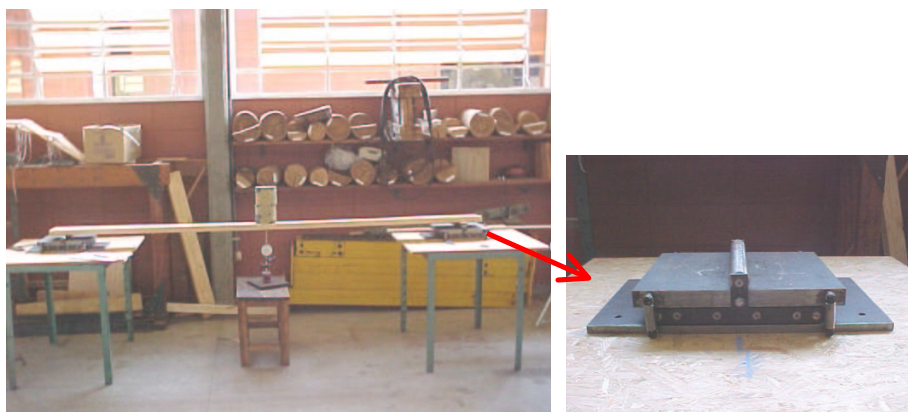
Figura 43 – Teste de flexão estática em relação ao eixo de menor inércia das pranchas e detalhe do apoio.
