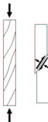
Figura 131 - Efeito das fibras inclinadas na resistência a compressão.
