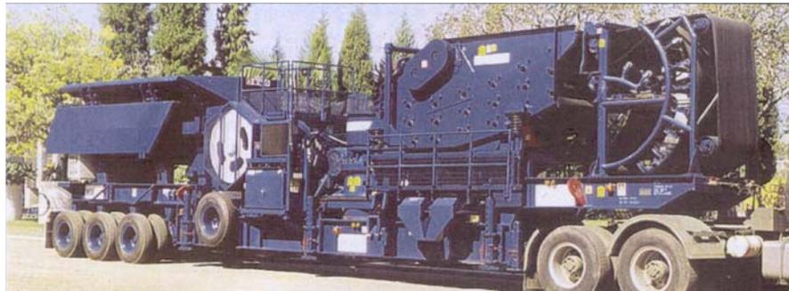
Figura 2.9 – Foto de um conjunto de britagem móvel equipado com britadores primário e secundário e jogo de peneiras, com produtividade de 100t/h
