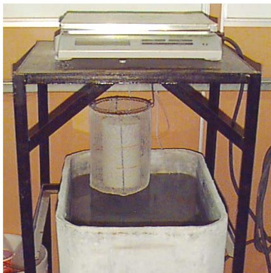
Figura 5.24 – Ensaio para determinação da absorção, índice de vazios e massa específica – esquema de pesagem submersa
