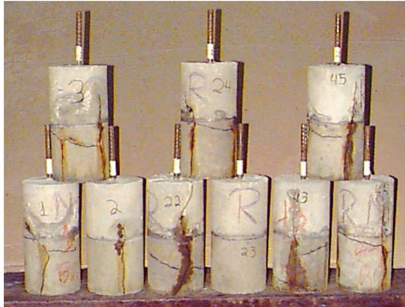
Figura 5.34 – Exemplares fissurados após 28 dias de ensaio
