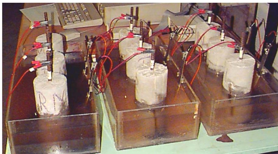
Figura 5.23 – Ensaio de corrosão – RI-5%, RI-0% e CI-0%, respectivamente
