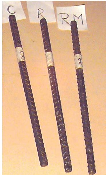
Figura 5.36 – Armaduras dos concretos tipo CI-0%, RI-0% e RI-5%, da esquerda para a direita, após o ensaio de corrosão (28 dias)
