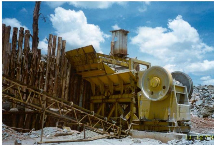
Figura 2.8 – Detalhe do alimentador, do britador primário (de mandíbula) e da correia transportadora da central de britagem apresentada na Figura 2.7
