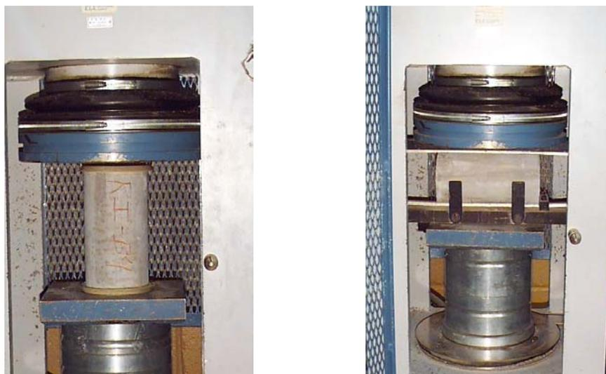
Figura 5.3 – Ensaio de compressão axial e tração por compressão diametral
