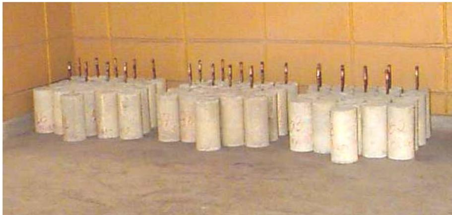
Figura 5.20 – Corpos-de-prova moldados para o ensaio de corrosão
