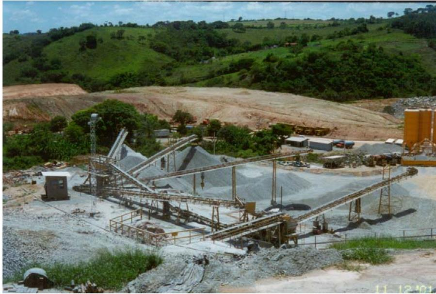
Figura 2.7 – Central de Britagem instalada em barragem no estado de Minas Gerais
