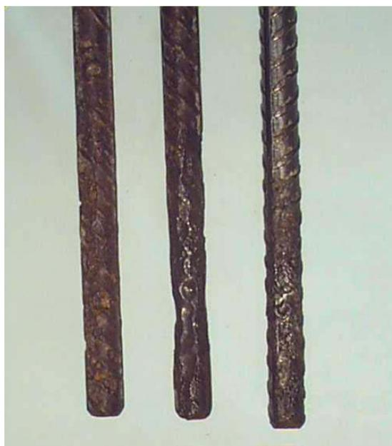
Figura 5.16 – Detalhe do ataque às armaduras (N, R e RM, respectivamente)
