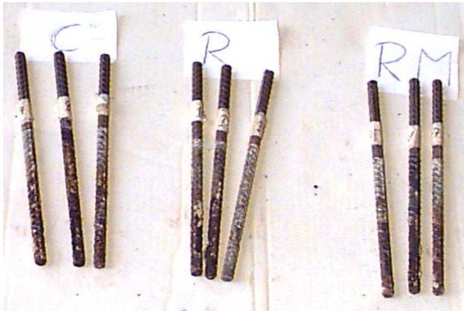
Figura 5.42 – Armaduras dos concretos tipo CI-0%, RI-0% e RI-5%, da esquerda para a direita, após o ensaio de corrosão (120 dias)
