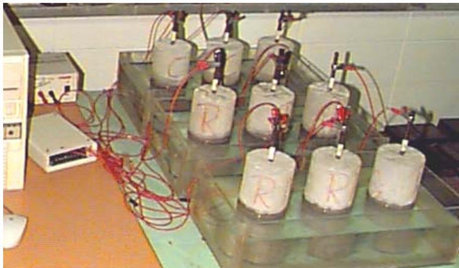
Figura 5.22 – Ensaio de corrosão – detalhe dos corpos-de-prova
