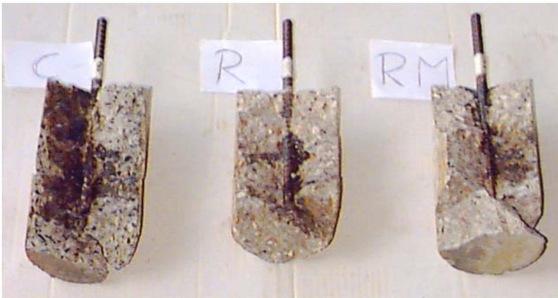
Figura 5.41 – Exemplos rompidos dos concretos tipo CI-0%, RI-0% e RI-5%, da esquerda para a direita, após o ensaio de corrosão (120 dias)
