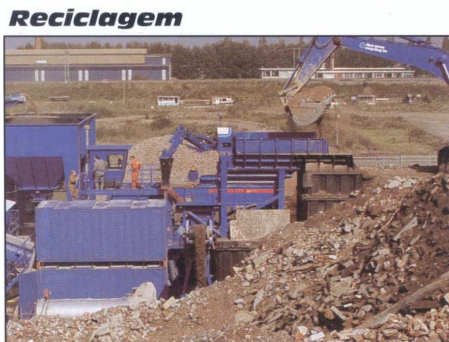
Figura 2.12 – Ilustração apresentada em catálogo técnico de central de britagem
