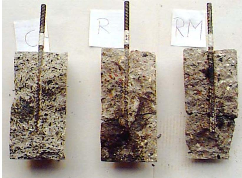
Figura 5.38 – Exemplos rompidos dos concretos tipo CI-0%, RI-0% e RI-5%, da esquerda para a direita, após o ensaio de corrosão (90 dias)
