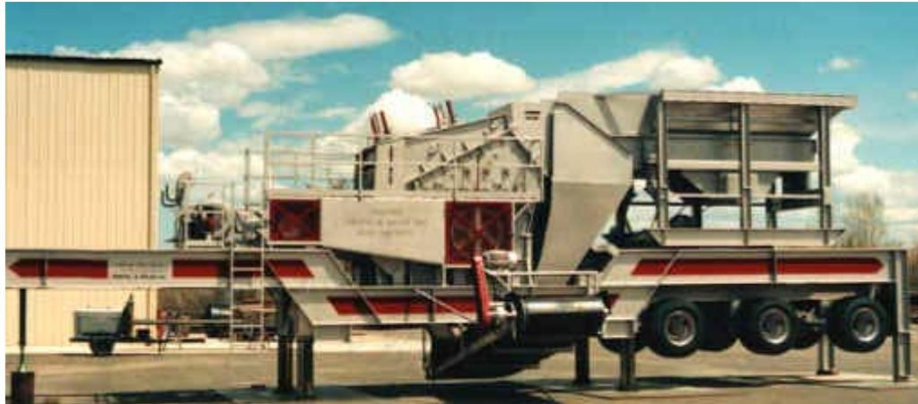
Figura 2.11 – Central de britagem móvel com britador primário
