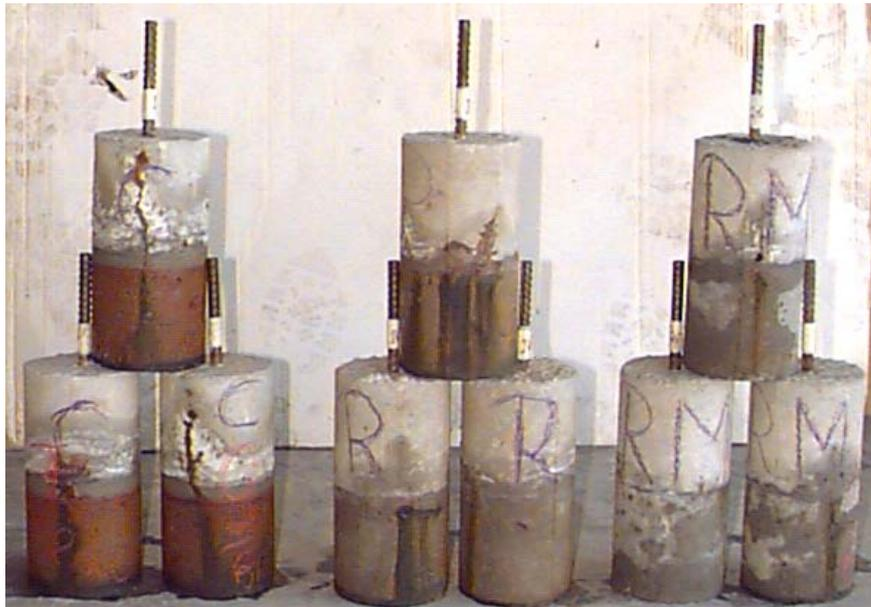
Figura 5.40 – Exemplos fissurados após 120 dias de ensaio
