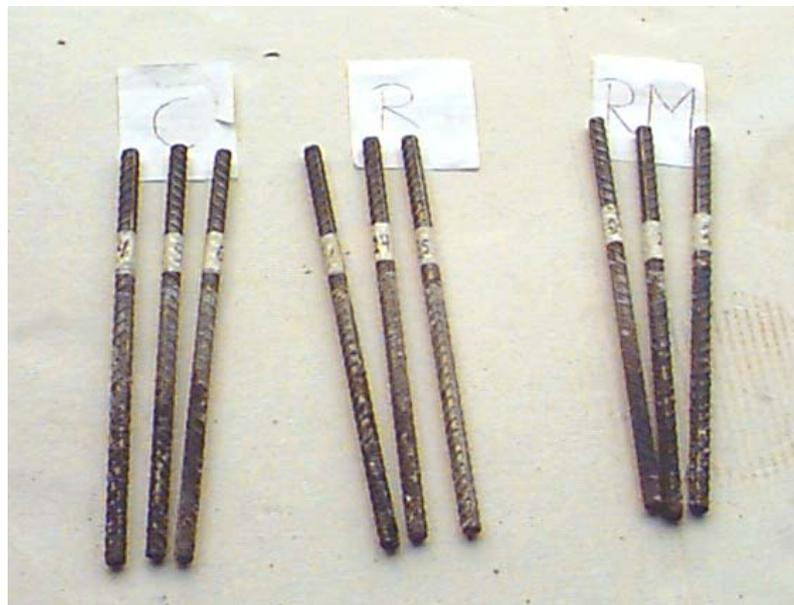
Figura 5.39 – Armaduras dos concretos tipo CI-0%, RI-0% e RI-5%, da esquerda para a direita, após o ensaio de corrosão (90 dias)
