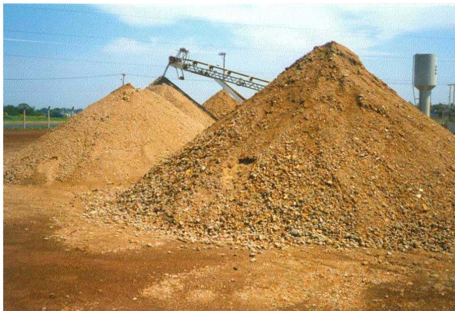
Figura 4.8 – Vista do depósito de entulho processado em bica corrida
