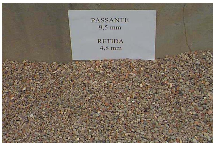
Figura 4.6 – Agregado graúdo reciclado (brita 0)
