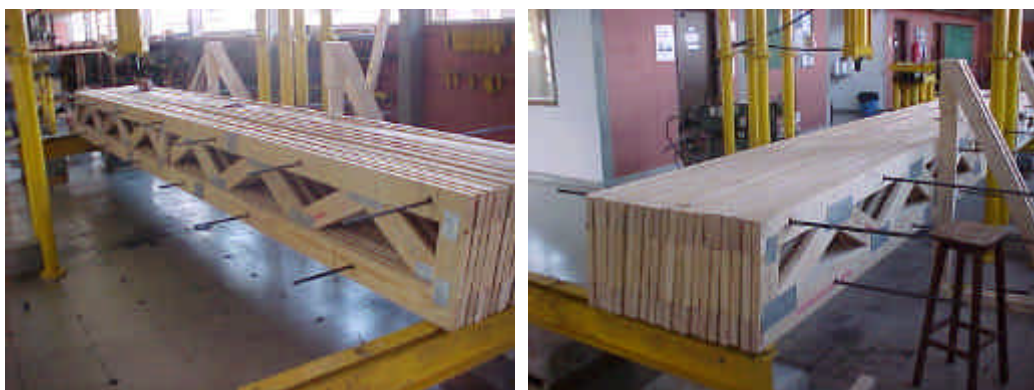
FIGURA 102- Montagem por justaposição das treliças e espaçadores.
