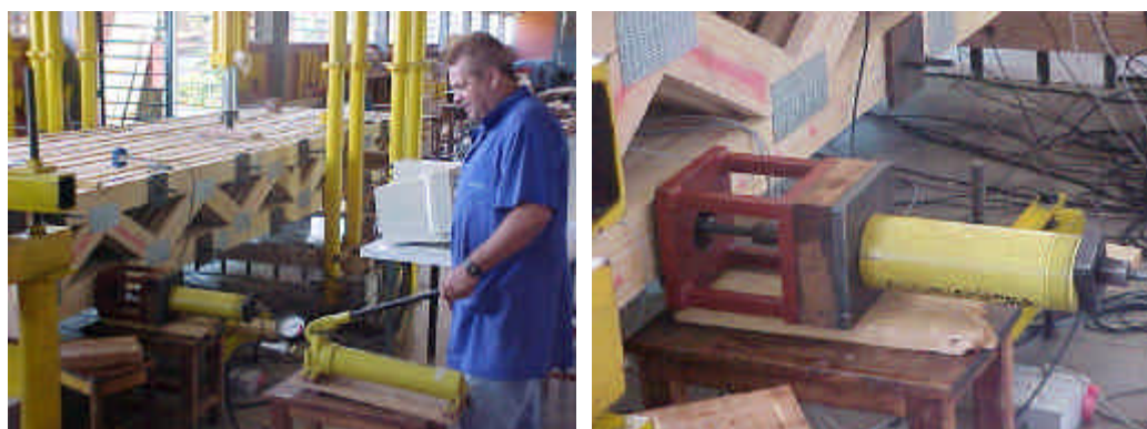
FIGURA 103- Aplicação de protensão no protótipo através de bomba manual.
