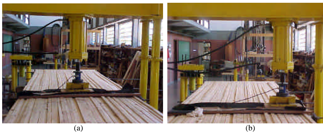
FIGURA 105- (a) Carregamento centrado (b) Carregamento excêntrico.
