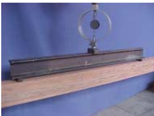
Figura 37 – Detalhe de aplicação de força no ensaio.
