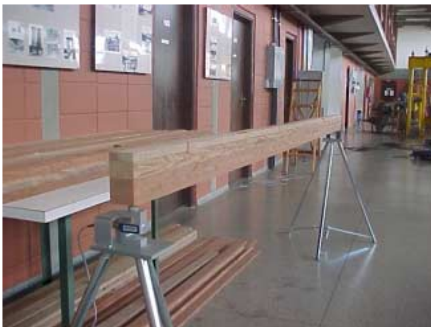
Figura 39 – Elemento estrutural preparado para ensaio de vibração transversal
