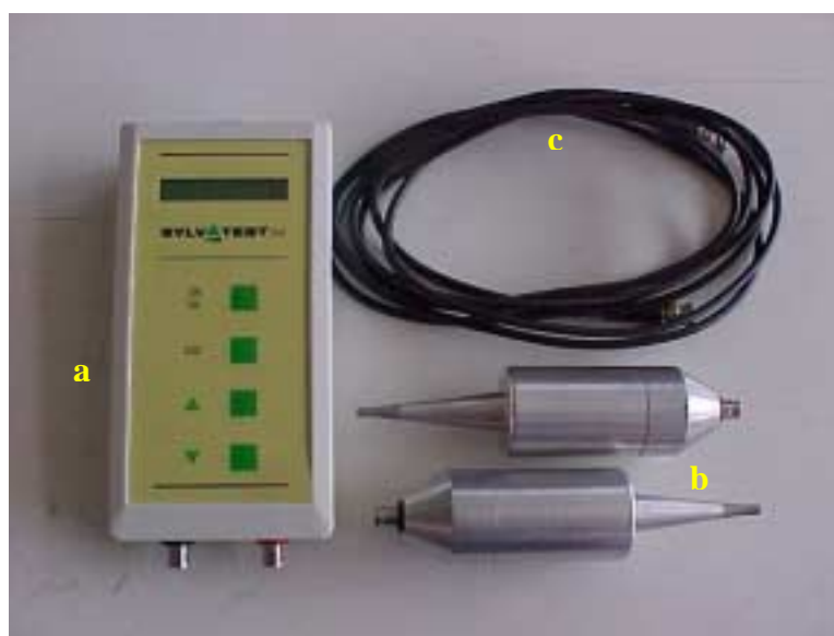
Figura 26 – Aparelho de ultra-som Sylvatest
