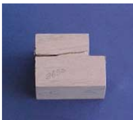
Figura 13 – Corpo-de-prova submetido a ensaio de cisalhamento
