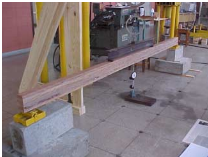
Figura 36 – Ensaio de flexão estática de 4 pontos em uma viga
