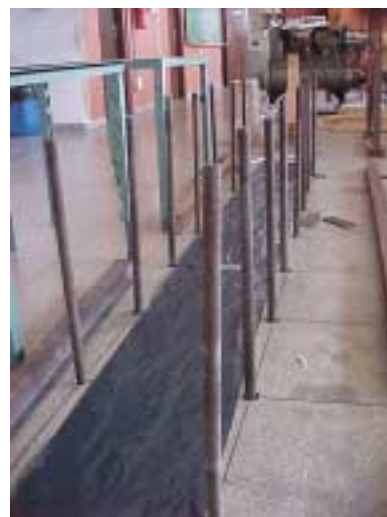
Figura 28 – Dispositivo para prensagem das vigas
