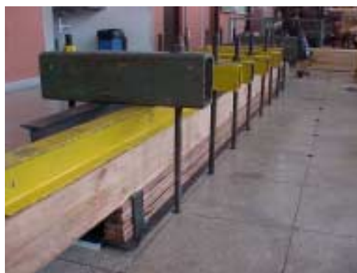
Figura 32 – Vigas sob pressão
