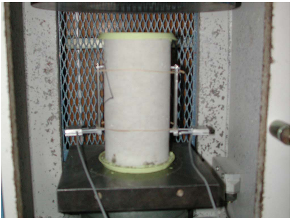
Figura 5.5 – Extensômetros elétricos posicionados no corpo-de-prova
