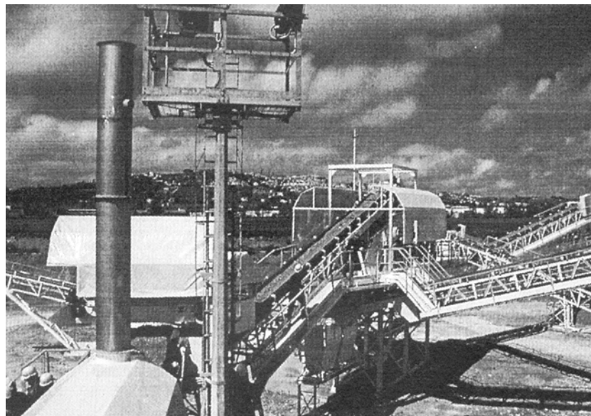
Figura 2.14 – Planta fixa para a produção de agregados reciclados
