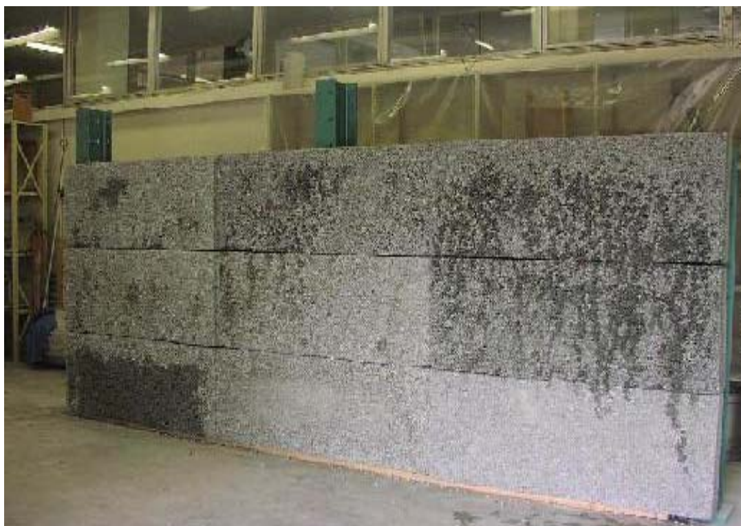
Figura 2.18 – Painel acústico confeccionado com concreto reciclado
