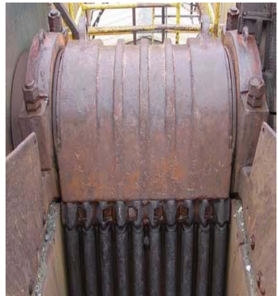
Figura 2.10 – Britador de mandíbula com alta capacidade de produção
