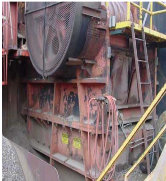
Figura 2.10 – Britador de mandíbula com alta capacidade de produção
