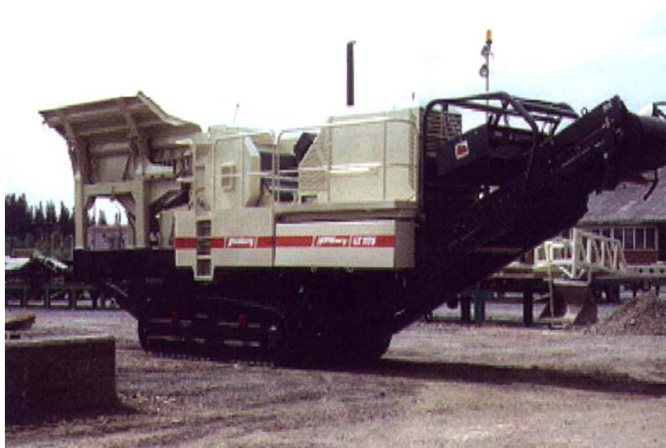
Figura 2.7 – Britador autopropelido de alta capacidade de produção
