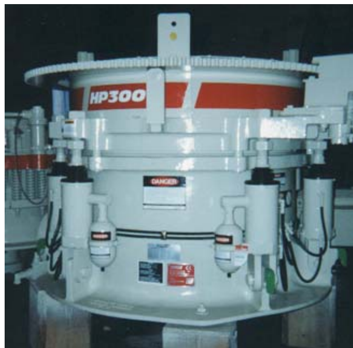
Figura 2.8 – Britador de cones
