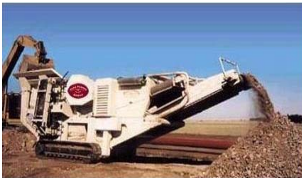
Figura 2.12 – Planta móvel para a produção de reciclados
