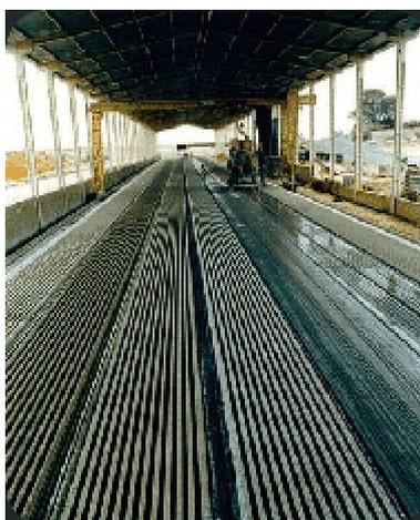
Figura 5-3. Pista de protensão de vigotas protendidas<sup>1</sup>
