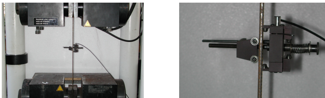
Figura 4.48 – Ensaio de tração das armaduras passivas, com detalhe do clip-gage .
