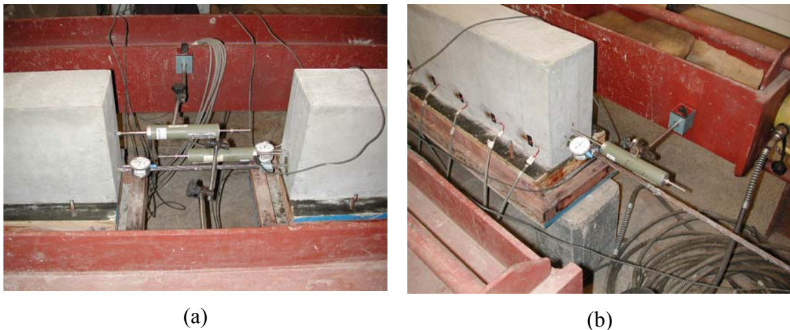
Figura 6.17 – Detalhes da instrumentação: (a) transdutores entre as vigas; (b) transdutor na extremidade.
