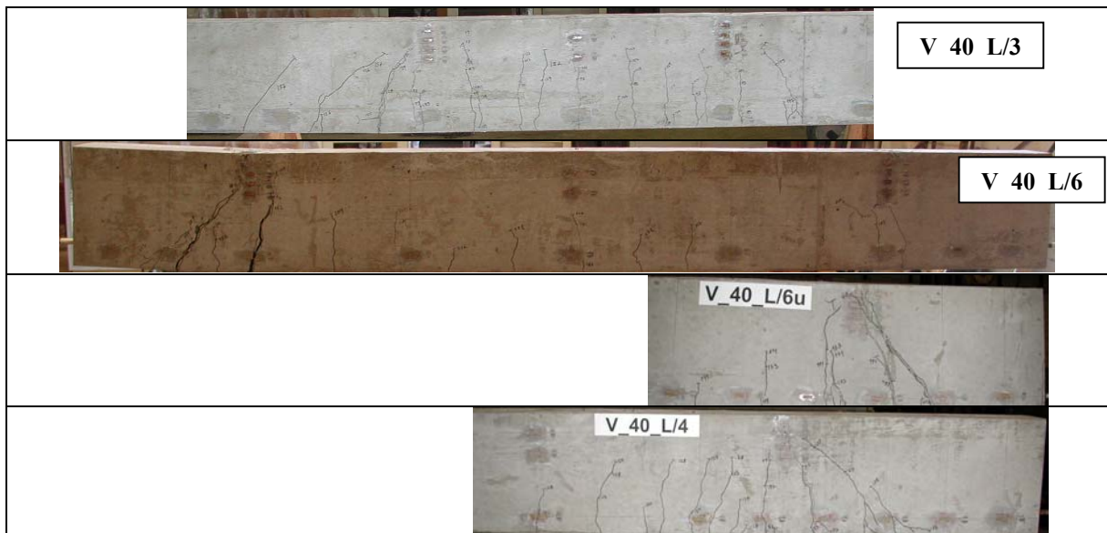
Figura 6.113 – Padrão de fissuração das vigas com consumo de fibra de V_f=40\text{kg/m}^3 .
