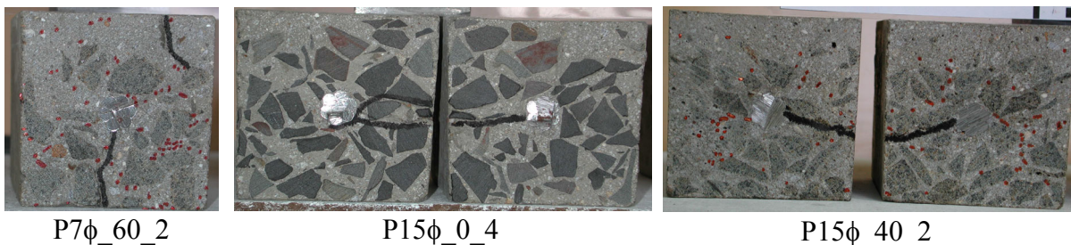
Figura 5.33 – Detalhe interno das fissuras dos prismas da Série 1.
