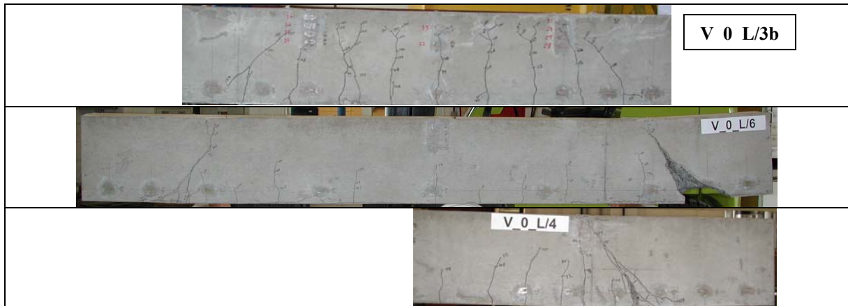
Figura 6.112 – Padrão de fissuração das vigas com consumo de fibra de V_f=0 .
