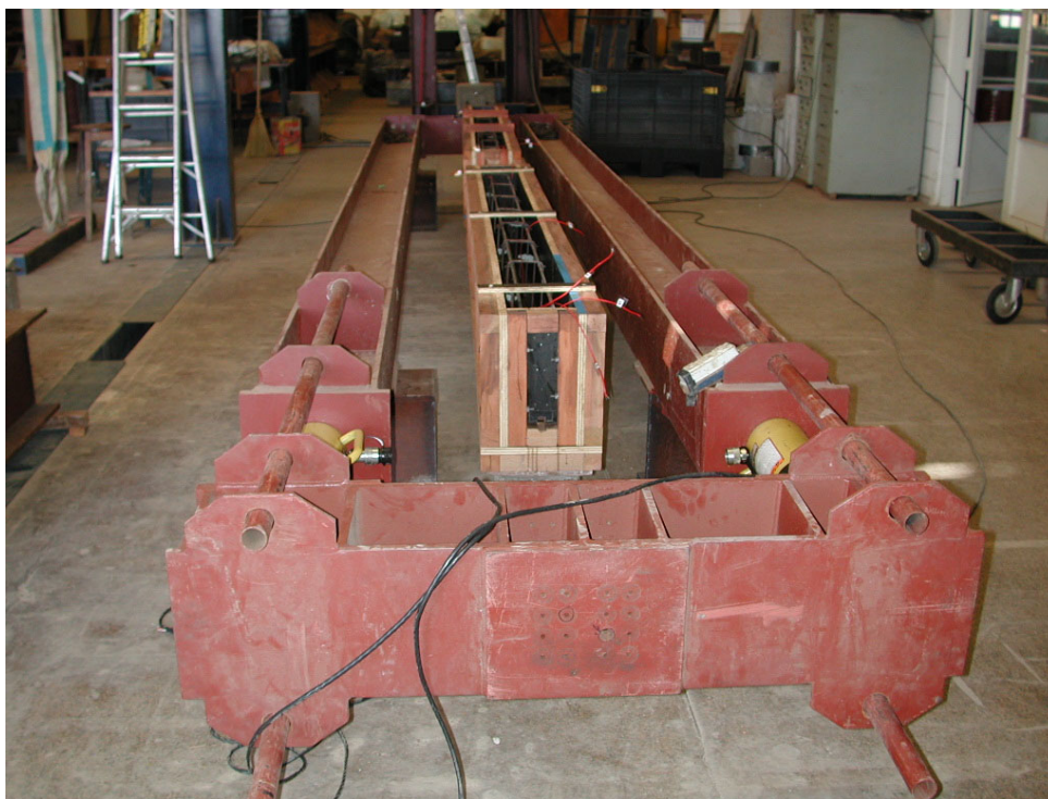
Figura 4.1 – Detalhe do pórtico durante a protensão de vigas
