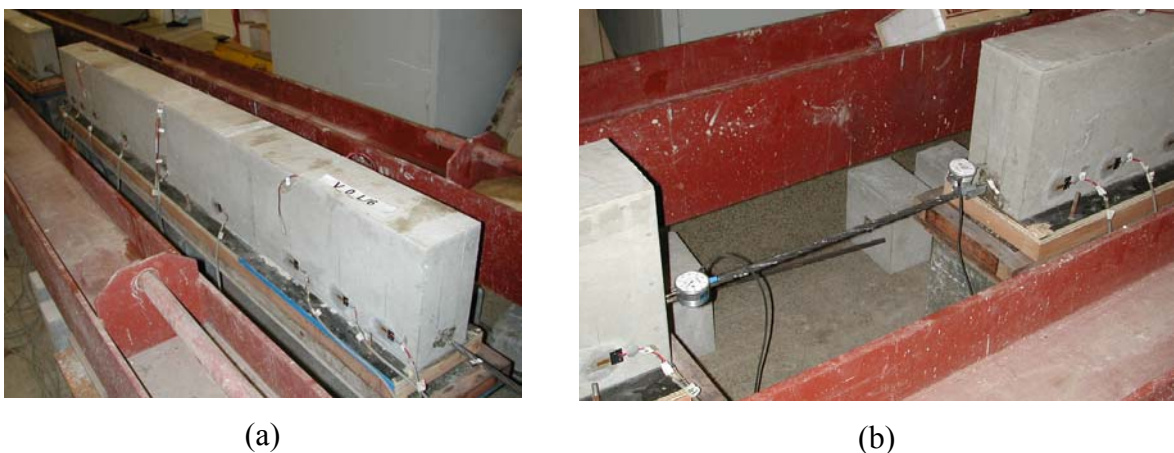
Figura 6.1 – Detalhes da retirada da protensão das vigas: (a) vigas no pórtico de protensão e vista dos extensômetros no concreto; (b) vista da posição dos relógios para leitura da penetração da cordoalha.
