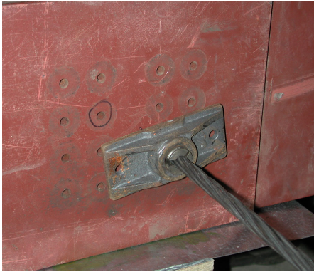
Figura 4.2 – Detalhe do encunhamento da cordoalha
