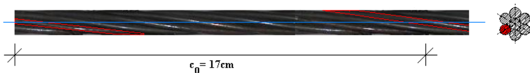
Figura 3.2 – Determinação de c_0 para as cordoalhas, levando em conta o comprimento para dar a volta no contorno.
