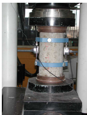
Figura 4.42 – Ensaio de compressão axial para determinação do módulo de elasticidade.
