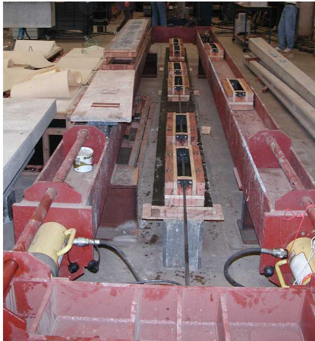
Figura 4.4 – Protensão dos prismas de arrancamento da Série 1.
