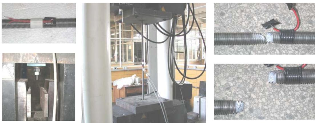
**FIGURA 7.12: DETALHES DA CARACTERIZAÇÃO DOS PARAFUSOS PASSANTES - DETERMINAÇÃO DA RESISTÊNCIA AO ESCOAMENTO E À RUPTURA**
