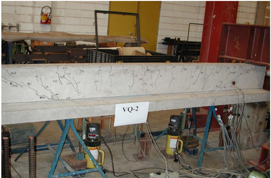
**Figura 8.3** – Panorama de fissuração na viga VQ-2 nas proximidades da ruína.
