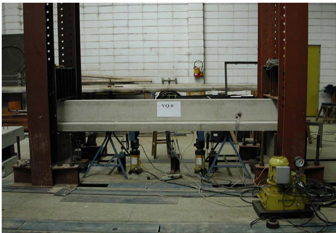
**Figura 7.26** – Pórtico de reação montado para os ensaios das vigas VQ.
