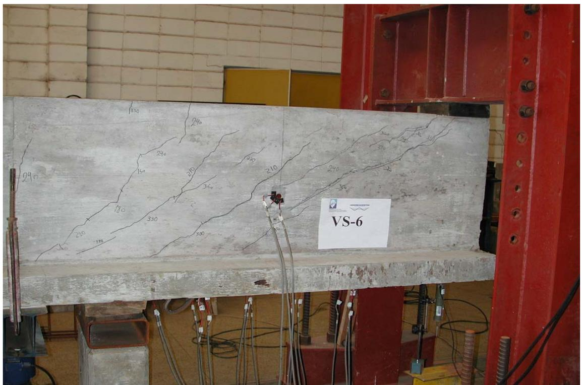
**Figura 8.19** – Panorama de fissuração na viga VS-6 após a ruína.
