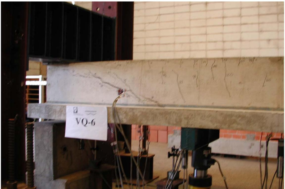
Figura 8.7 – Panorama de fissuração da viga VQ-6 na ruína.
