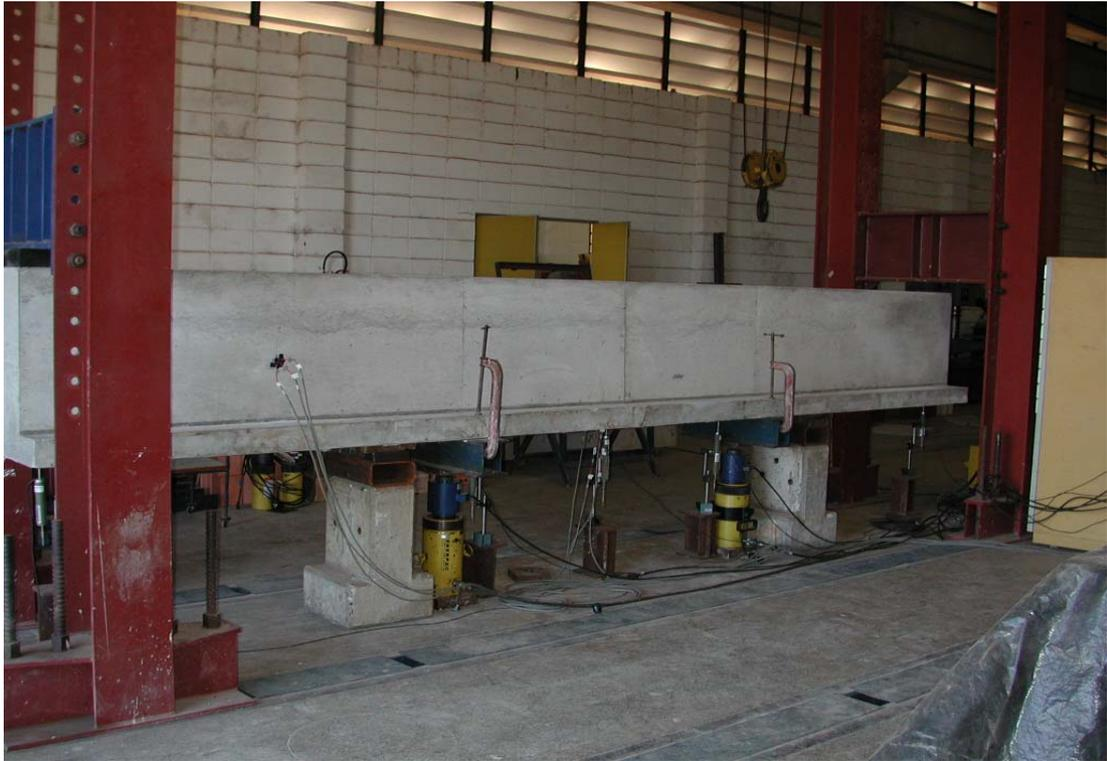
**Figura 7.29** – Pórtico de reação montado para os ensaios das vigas VS.
