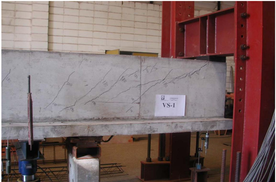
**Figura 8.14** – Panorama de fissuração da viga VS-1 após a ruína.
