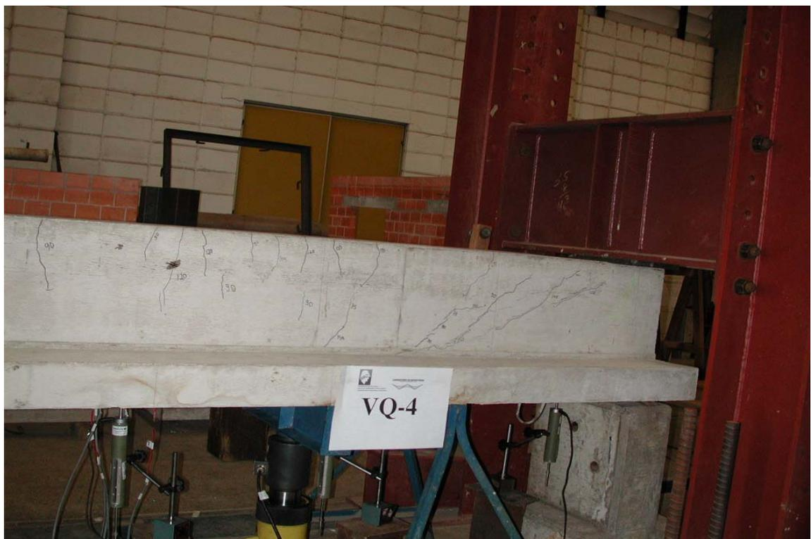
**Figura 8.5** – Panorama de fissuração na viga VQ-4 nas proximidades da ruína.
