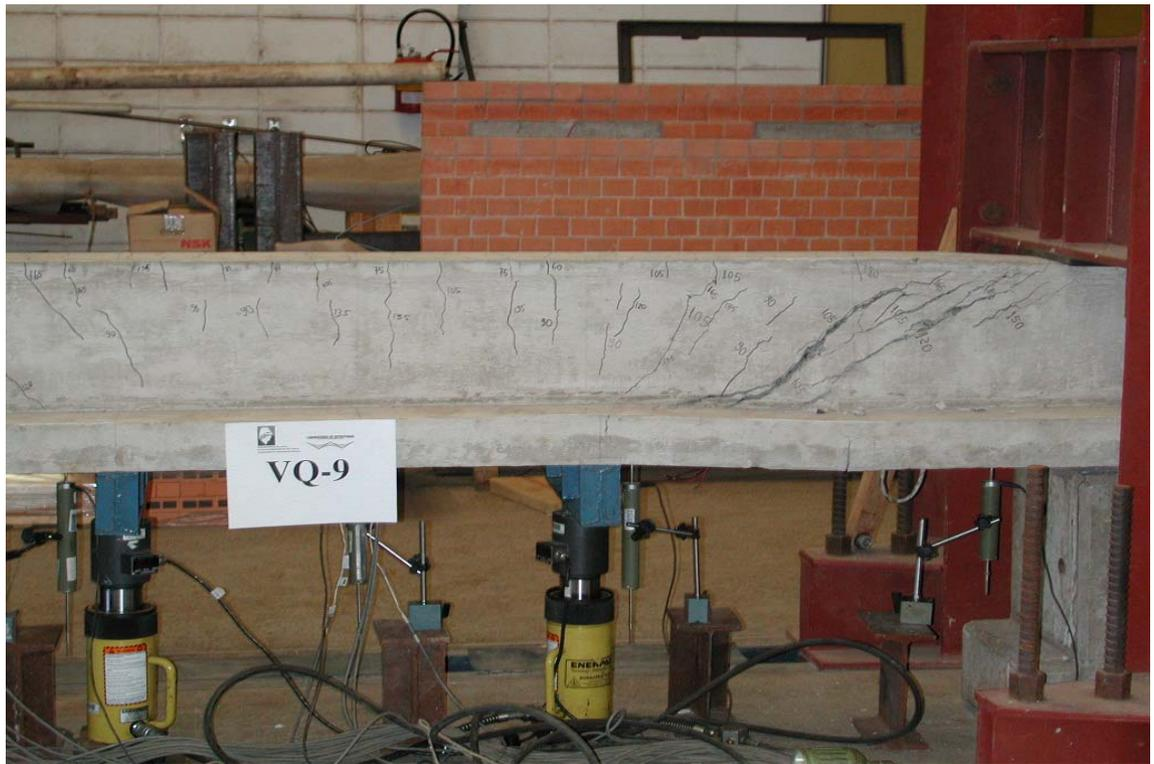
**Figura 8.11** – Panorama de fissuração na viga VQ-9 após o colapso.
