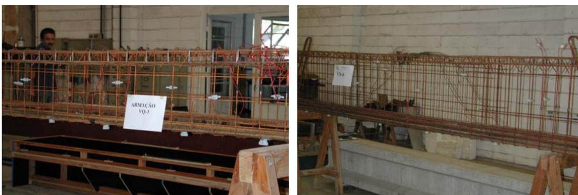
**Figura 7.41** – Armaduras das vigas VQ-3 e VS-6.
