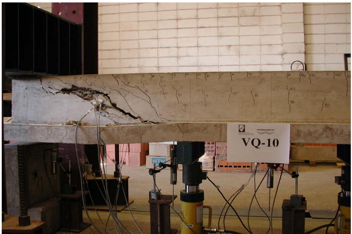
**Figura 8.12** – Panorama de fissuração na viga VQ-10 após a ruína.
