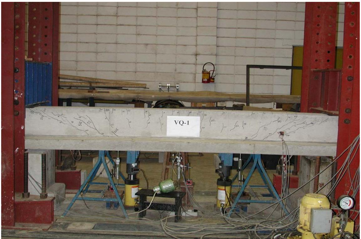
**Figura 8.2** – Panorama de fissuração na viga VQ-1 nas proximidades da ruína.
