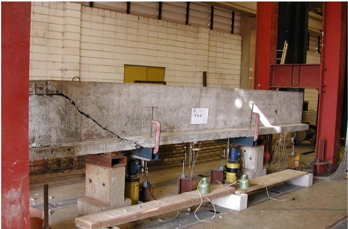
**Figura 8.17** – Panorama de fissuração na viga VS-4 após a ruína.
