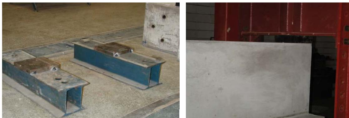
**Figura 7.28** – Detalhes da placa de aço, dos perfis I justapostos e do apoio de neoprene fretado, utilizados nos ensaios das vigas VS.
