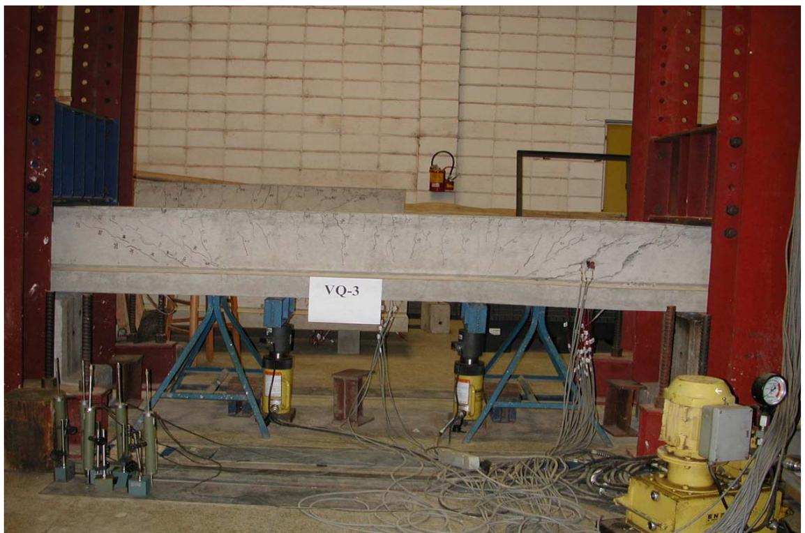
**Figura 8.4** – Panorama de fissuração na viga VQ-3 após o colapso.
