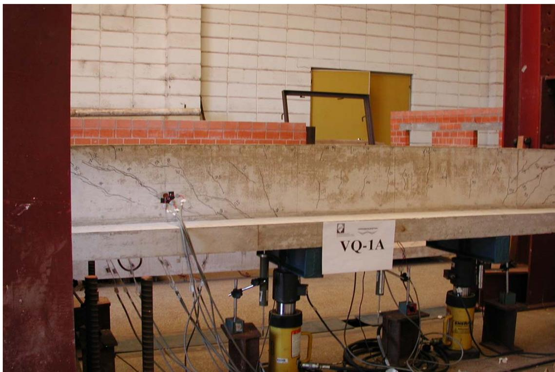
**Figura 8.8** – Panorama de fissuração da viga VQ-1A após o colapso.
