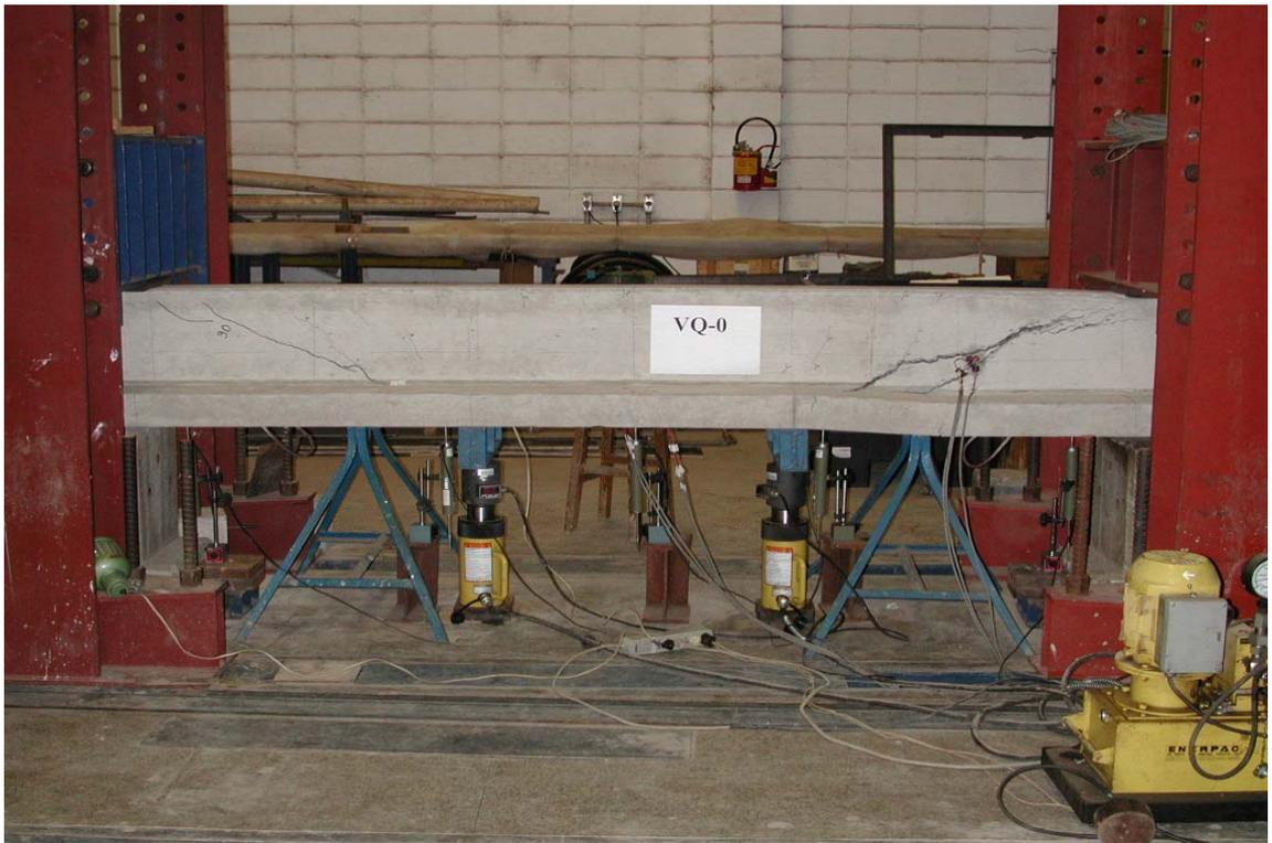
**Figura 8.1** – Panorama de fissuração na viga VQ-0 na ruína.
