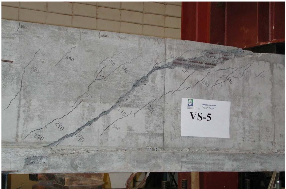
**Figura 8.18** – Panorama de fissuração na viga VS-5 após a ruína.
