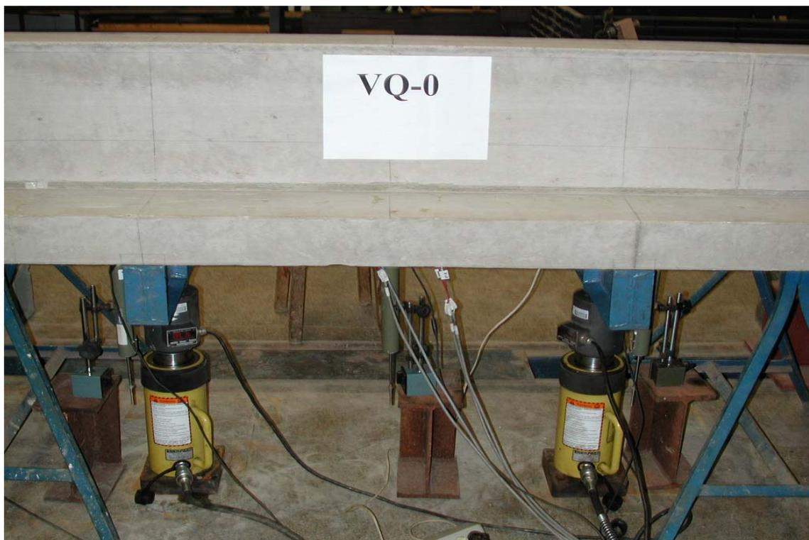
**Figura 7.27** – Detalhe da montagem dos modelos para os ensaios das vigas VQ.
