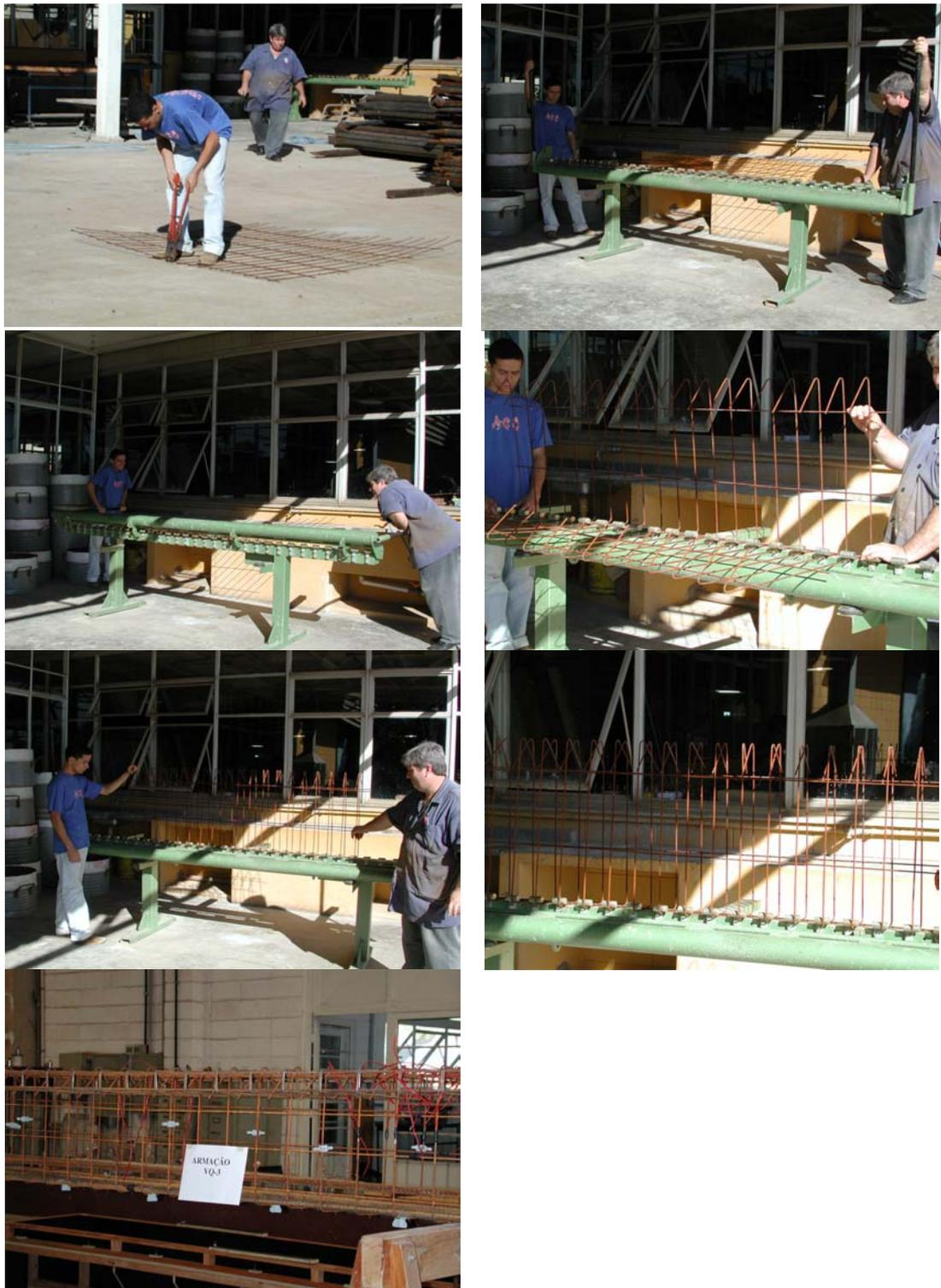
**Figura 2.14** - Fotografias que ilustram o processo de corte, dobra e montagem das armaduras de uma viga com telas soldadas.
