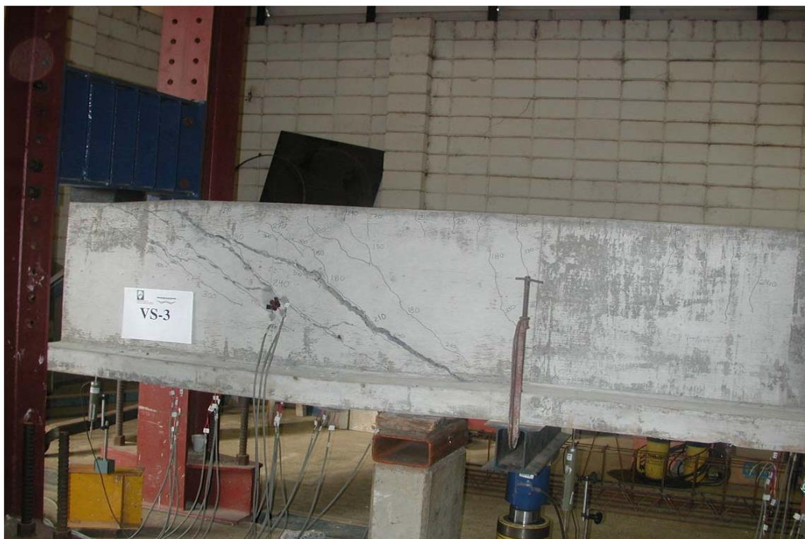
**Figura 8.16** – Panorama de fissuração da viga VS-3 após a ruína.
