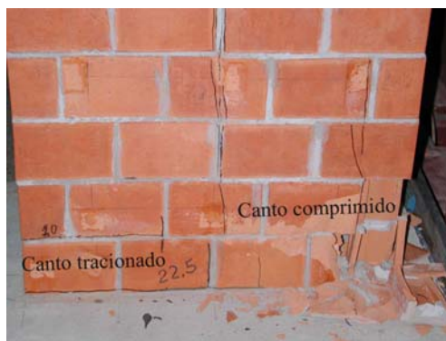
FIGURA 3-17 Modo de ruptura do painel: detalhe dos cantos comprimido e tracionado na base.
