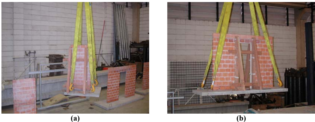
FIGURA 3-28 Transporte utilizando-se ponte rolante: (a) Painel isolado; (b) Painel porta.
