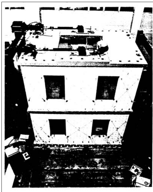
FIGURA 2-15 Estrutura de ensaio com os atuadores hidráulicos [retirado de Abrams (1986)].
