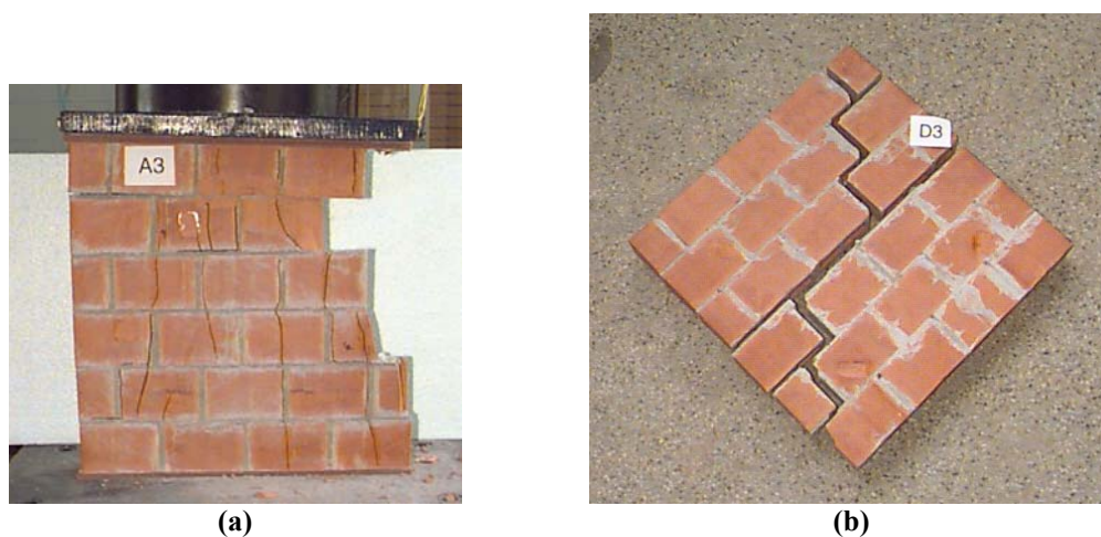
FIGURA 3-10 Modos de ruptura observados durante os ensaios: (a) Compressão simples e (b) Compressão diagonal.
