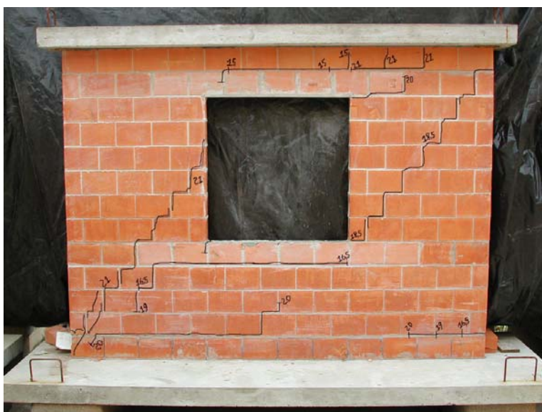
FIGURA 4.5-22 Vista geral do modelo PJSG2 após realização do ensaio.
