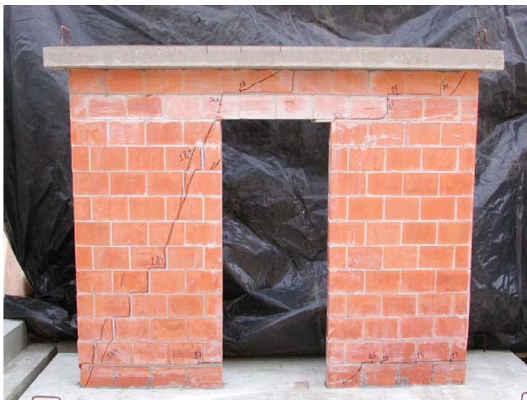
FIGURA 4.3-37 Vista geral do modelo PPSG2 após a realização do ensaio.
