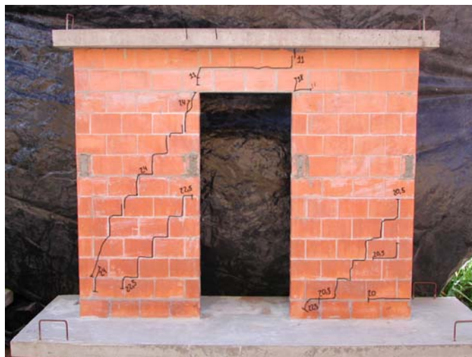
FIGURA 4.4-26 Vista geral do modelo PPCG2 após realização do ensaio.
