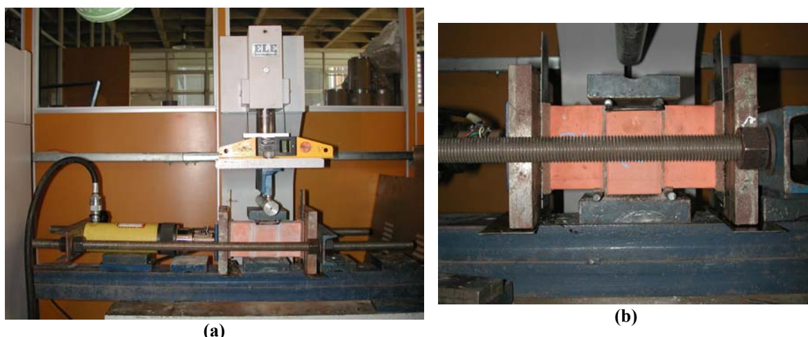
FIGURA 3-11 Ensaio de resistência ao cisalhamento em juntas: (a) Vista geral do arranjo do ensaio; (b) Ruptura típica por escorregamento na junta.
