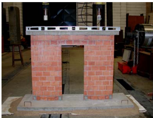
FIGURA 3-29 Utilização de areia para nivelamento do modelo.
