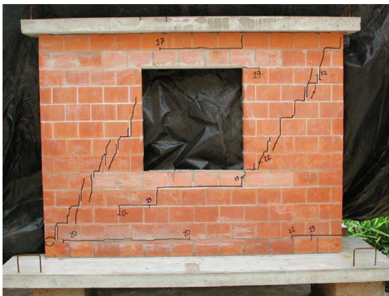
FIGURA 4.5-11 Vista geral do modelo PJSJG1 após realização do ensaio.
