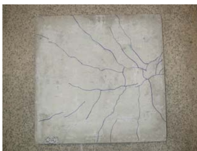
FIGURA 3-16 Fissuração observada no lado da laje de apoio que mantinha contato com o piso do laboratório.
