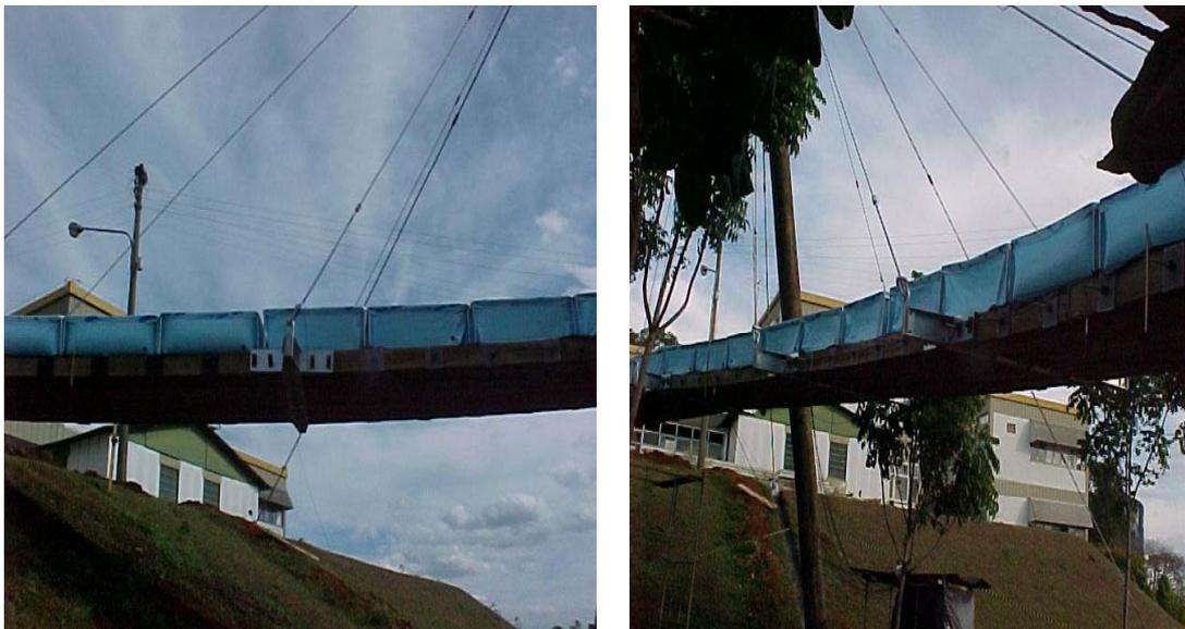
**FIGURA 57 - Ensaio da Passarela – Carregamento Uniformemente Distribuído ao Longo dos quatro Tramos Localizados nas Extremidades**
