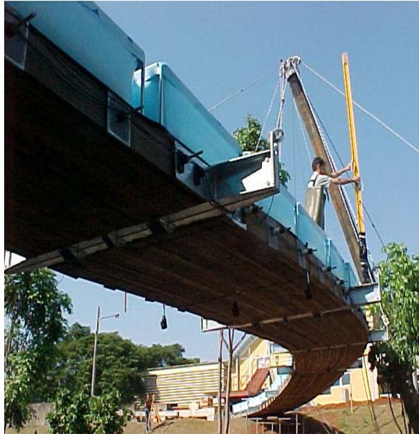
FIGURA 59 - Ensaio da Passarela
