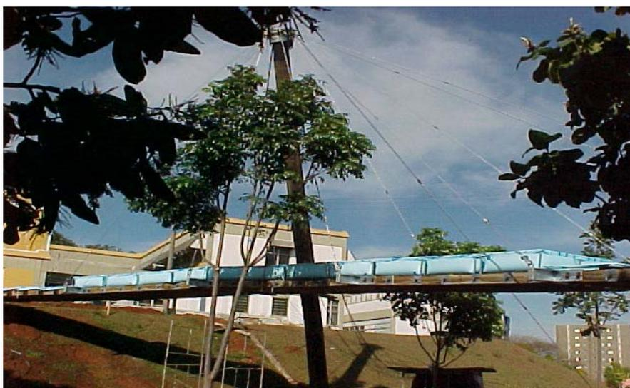
**FIGURA 58 - Ensaio da Passarela – Carregamento Uniformemente Distribuído ao Longo dos Três Módulos Centrais**
