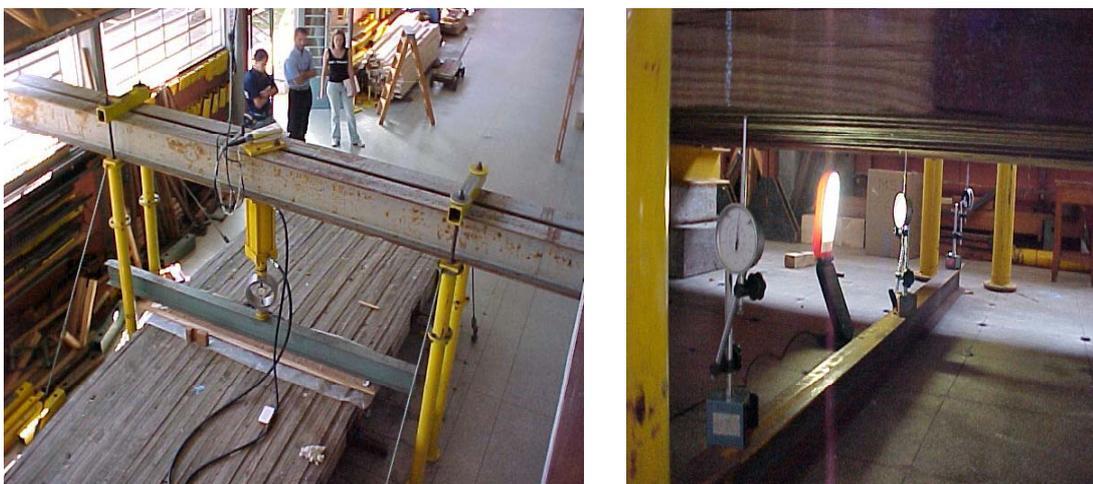
FIGURA 53 - Ensaio da Placa do Módulo do Tabuleiro da Passarela – Carregamento Uniformemente distribuído ao Longo da Seção Transversal Central
