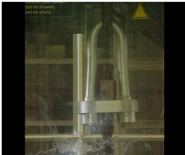
FIGURA 52 - Ensaio do Olhal dos Cabos de Sustentação do Mastro Principal da Passarela
