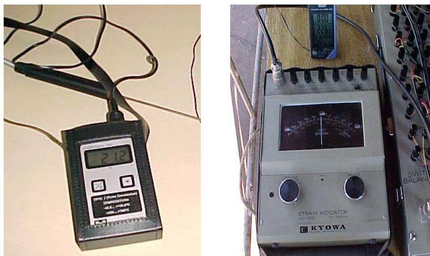
FIGURA 60 - Termômetros Usados e Sistema de Aquisição de Dados da Kiowa
