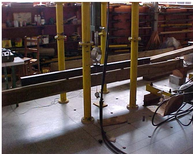
FIGURA 51 - Ensaio à Flexão das Lâminas dos Módulos do Tabuleiro
