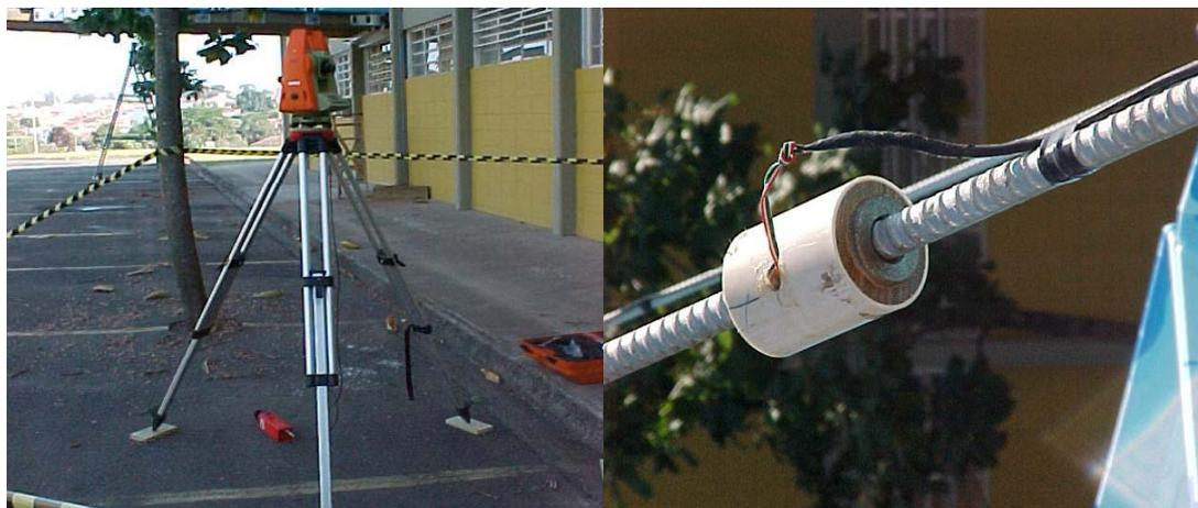
FIGURA 55 - Célula de Carga de um Estal e Estação Total
