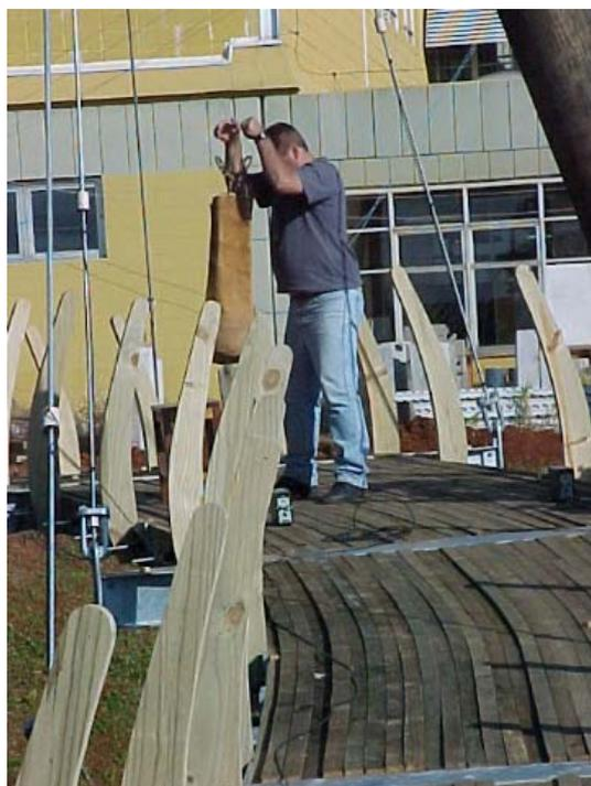
FIGURA 61 – Excitação da Passarela com a Queda de Saco de Areia
