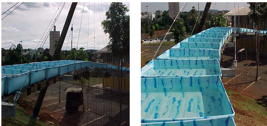
FIGURA 56 - Ensaio da Passarela – Carregamento Uniformemente Distribuído ao Longo de toda a Superfície
