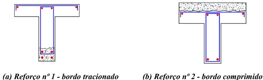
**Figura 1.1 – Técnicas de reforço das vigas estudadas**
