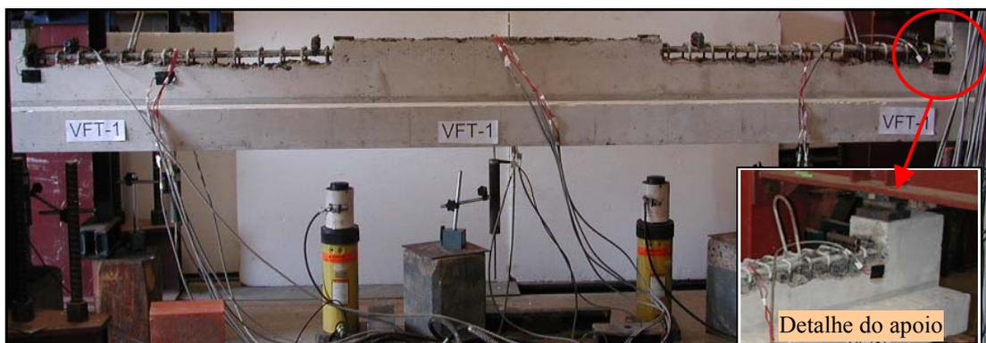
(a) Viga original com armadura exposta antes de ser pré-carregada
