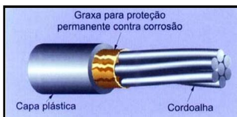
**Figura 7.7 – Cordoalha não aderente usada na protensão das vigas VFC**
