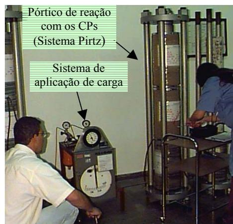
(b) Aplicação de carga – ensaio de fluência
