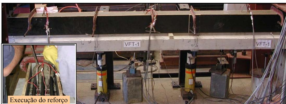
(c) Viga durante e após o reforço sob carga antes da retirada da fôrma
