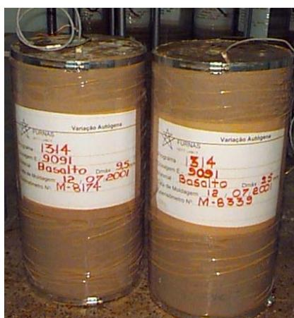
(a) Corpo-de-prova após a selagem
