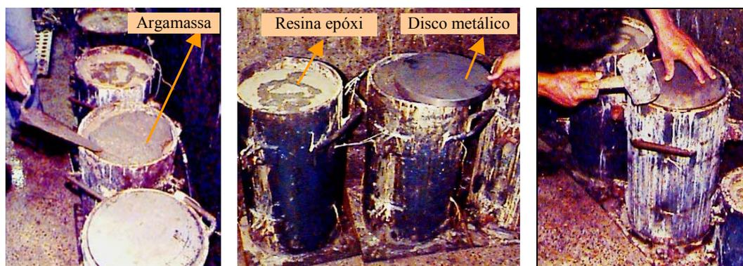
(b) Esquema de fixação do disco metálico sobre os corpos-de-prova
