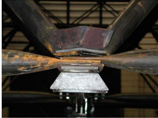
**Figura 5.10 – Detalhe da ligação da treliça TE1-R -Reforço**
