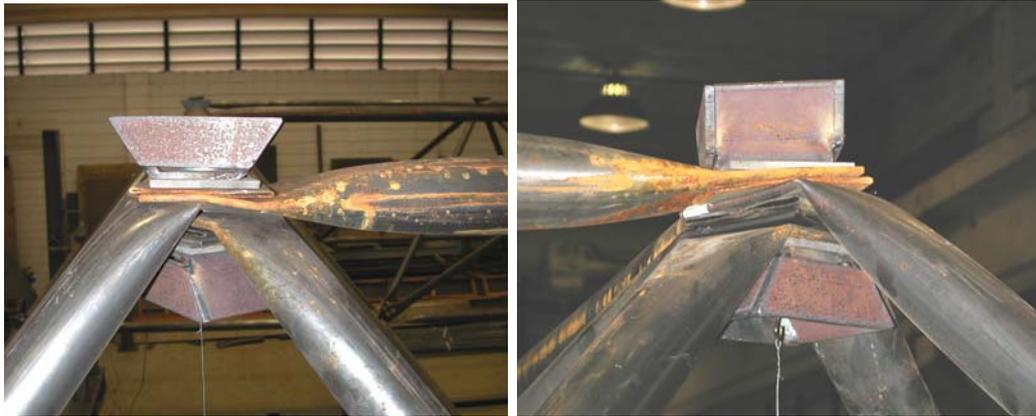
Figura 6.11 – Configuração de colapso nó 1 – TE1-R
