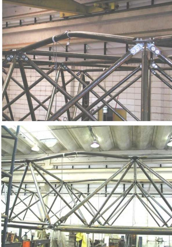
Figura 6.93 – Configuração de colapso - treliça TE5
