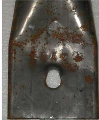
Figura 6.53 – Esmagamento nas paredes dos furos
