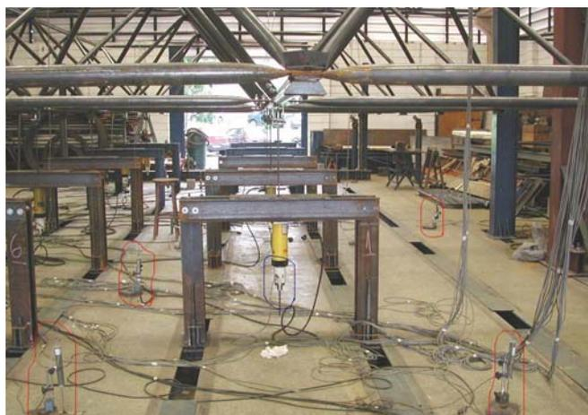
b) detalhe instrumentos – transdutores/células de carga
