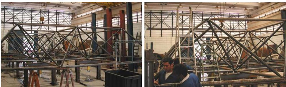
**Figura 5.7 – Substituição de barras nas treliças**
