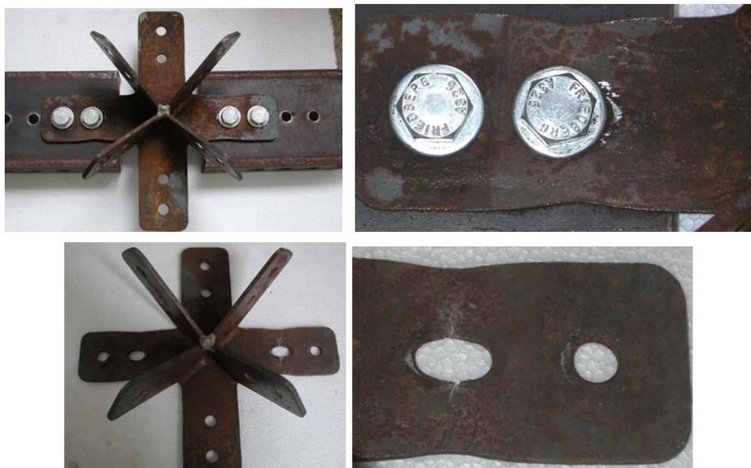
**Figura 6.102 – Modos de falha para nós tracionados**
