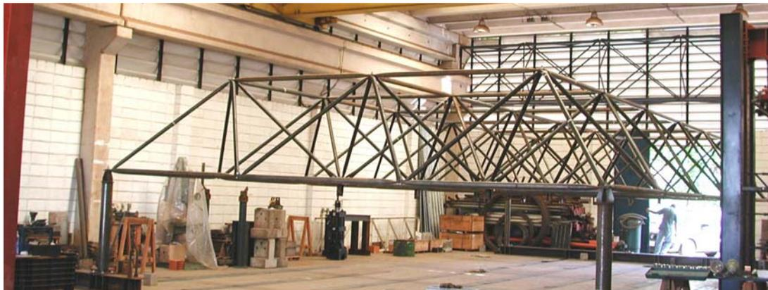
**Figura 5.6b – Vista da treliça após montagem**
