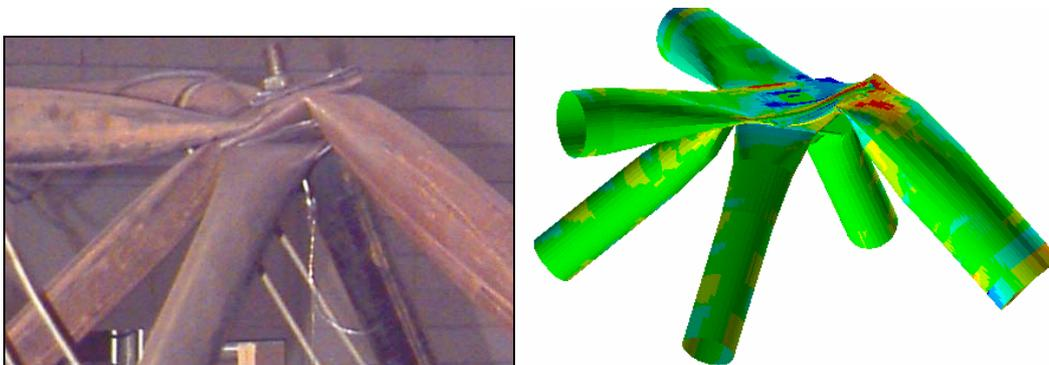
**Figura 4.36 – Configurações final teórica e experimental nó de canto.**
