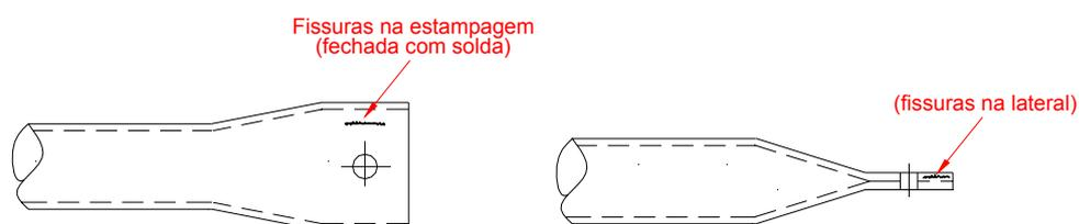
**Figura 3.50 - Possibilidades de fissura em tubos de aço com extremidades estampadas**
