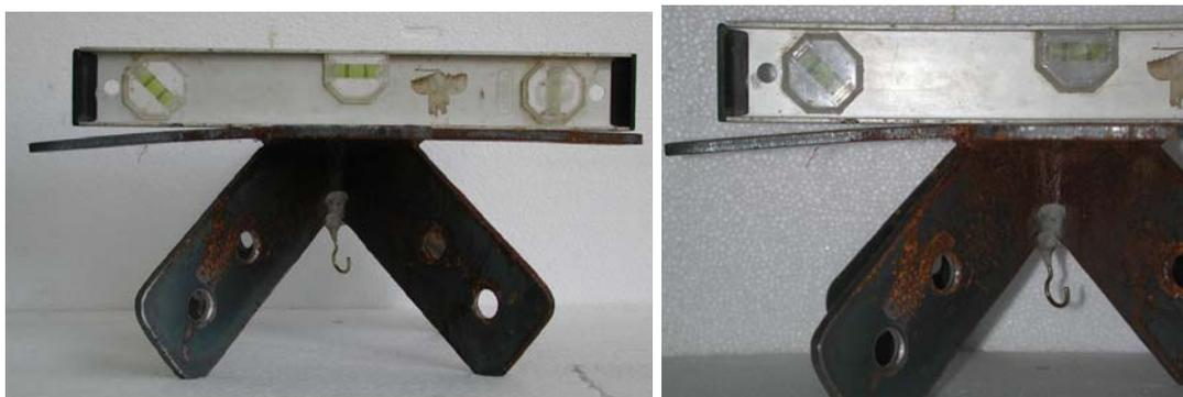
**Figura 5.23 – Imperfeições de fabricação nos nós da treliça TE4**
