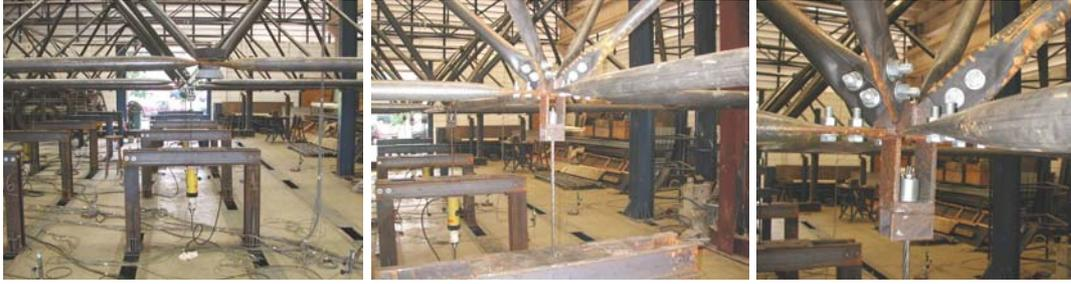
**Figura 5.34 – Vistas do aparato de aplicação de força**
