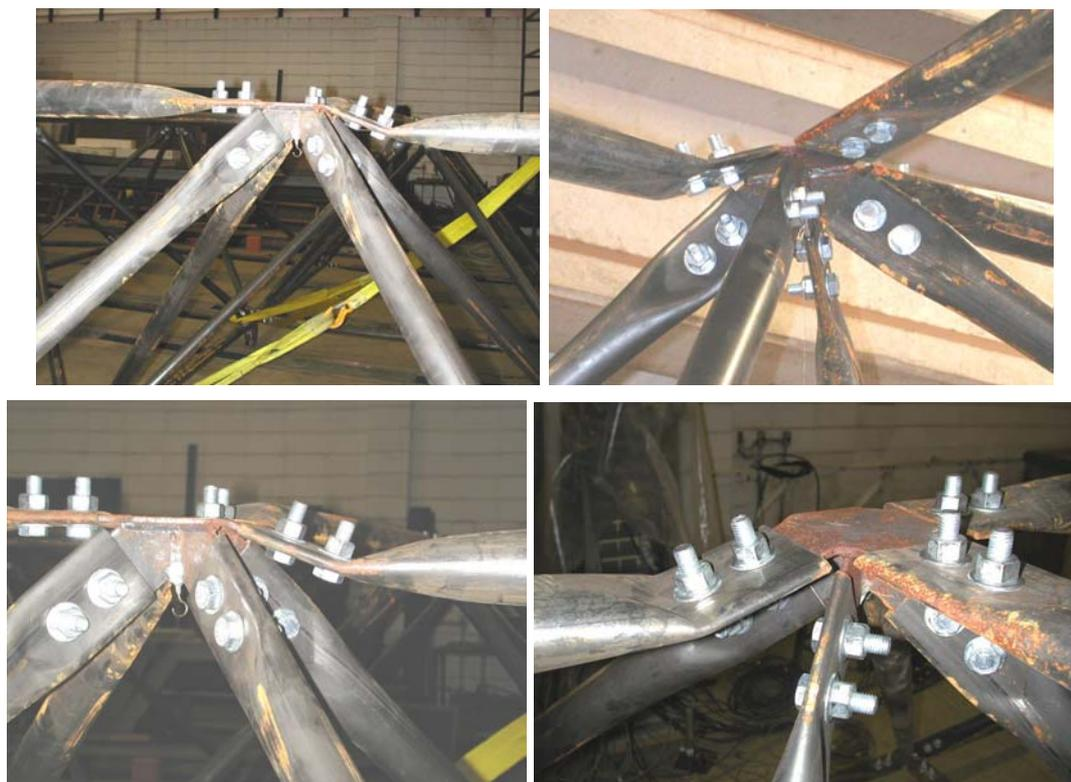
**Figura 6.64 – Configuração de colapso na treliza– TE4**
