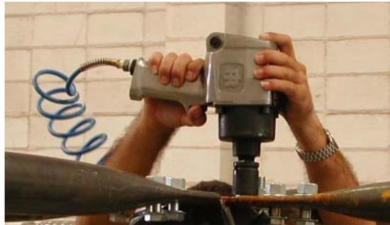
**Figura 5.11 – Aperto dos parafusos com ferramenta pneumática**
