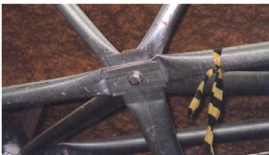
**Figura 3.31 - Nó típico após colapso parcial da estrutura**
