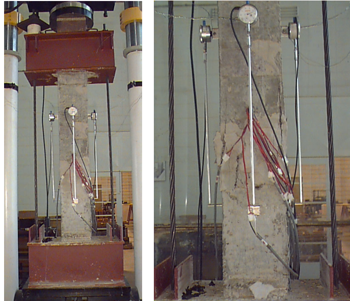
Figura 3.24: Detalhe da ruptura do modelo piloto
