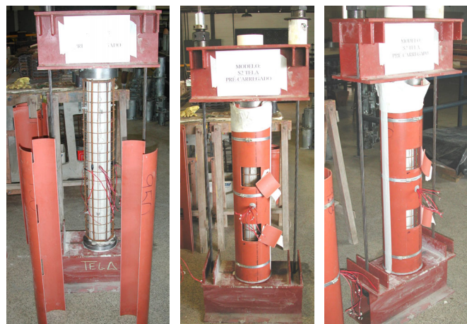
Figura 5.14: Fôrma para concretagem das camisas de reforço dos modelos com pré-carregamento com seção transversal circular
