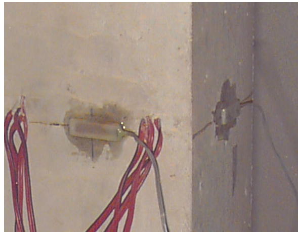
Figura 3.16: Extensômetros de embutir colados na superfície do modelo
