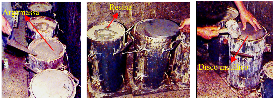
(b) Esquema de fixação do disco metálico sobre os corpos-de-prova
