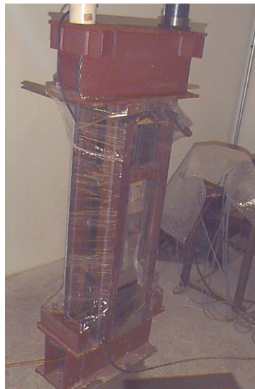
Figura 3.22: Detalhe da proteção do modelo
