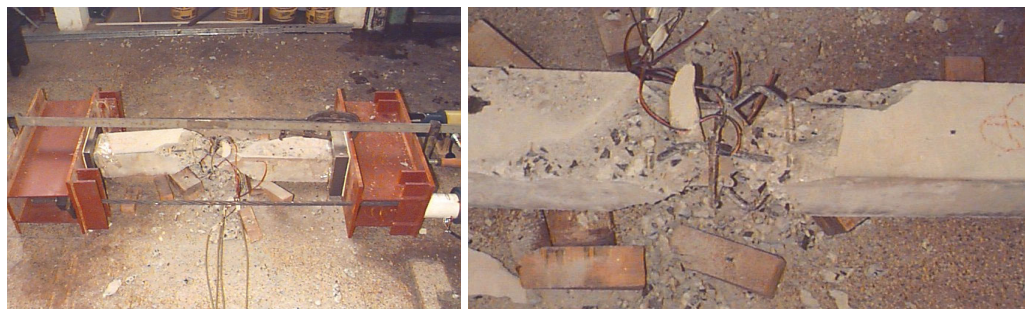
Figura 5.8: Ruptura de um dos modelos experimentais
