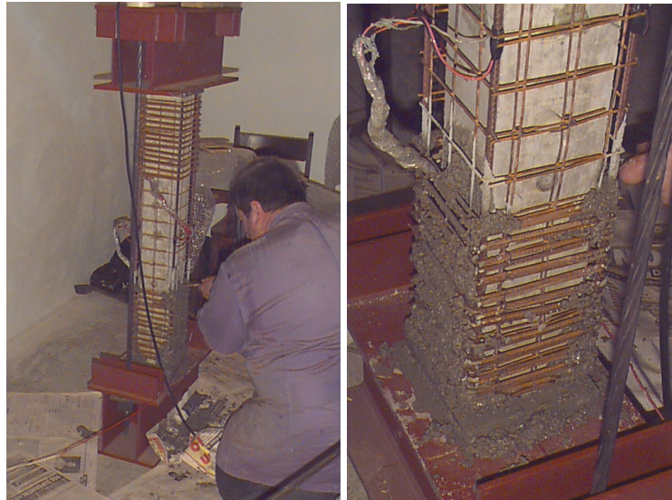
Figura 3.21: Detalhe da limpeza do modelo decorrente de problemas na primeira concretagem
