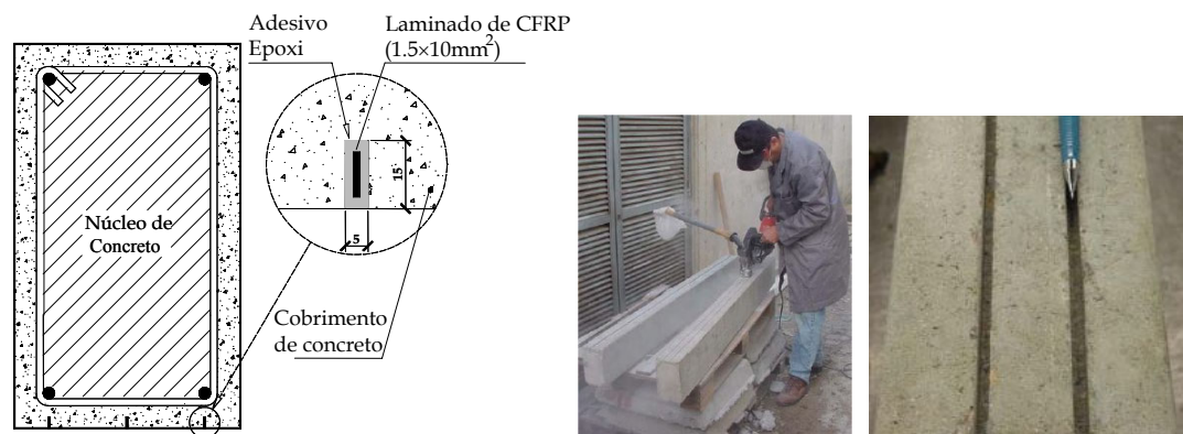
(a) esquema do reforço estrutural
