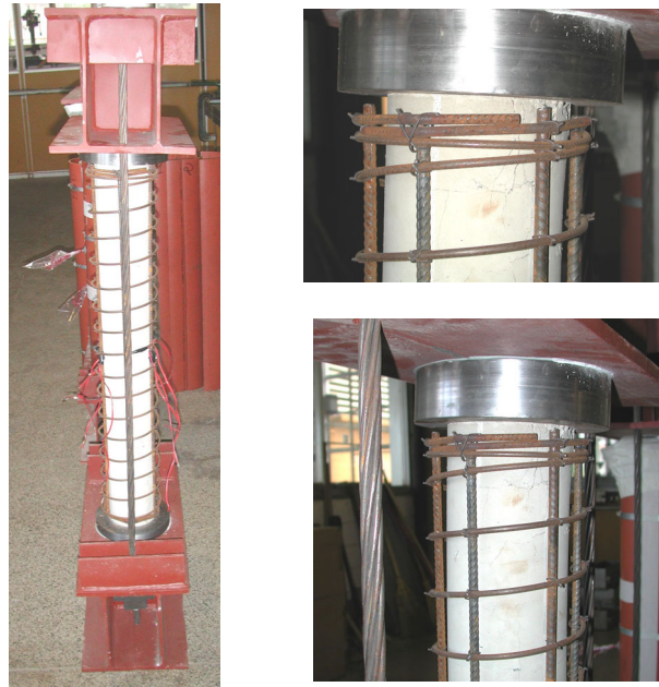
Figura 5.13: Fissuras na extremidade superior do modelo S2EST2
