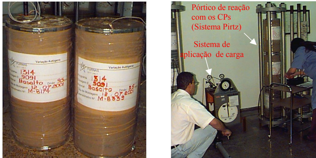
(a) Corpo-de-prova após a selagem (b) Aplicação de carga – ensaio de fluência
