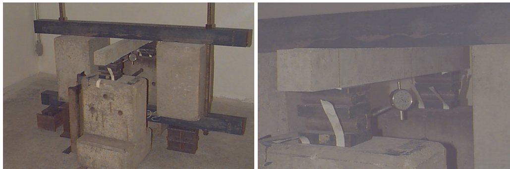
Figura 3.9: Viga de concreto armado para medição da fluência
