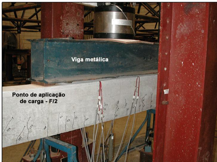
Figura 5.29 – Viga metálica e o ponto de aplicação de força  $F/2$ .
