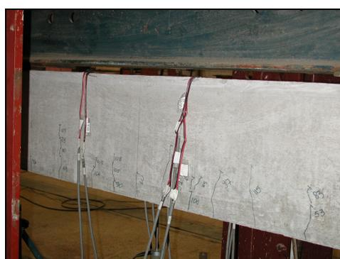
**Figura 5.41 – Vista Geral da fissuração do modelo, viga VC-01.**
