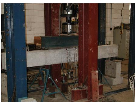
Figura 5.56 – Vista longitudinal da viga VC-03 pronta para o ensaio.
