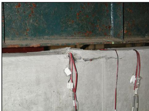
**Figura 5.42 – Início da ruptura, destacamento do cobrimento, viga VC-01.**
