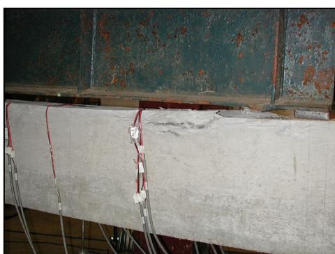
**Figura 5.50 – Início da ruptura, destacamento do cobrimento, viga VC-02.**
