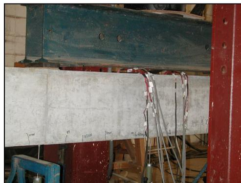
**Figura 5.59 – Vista geral da fissuração da viga VC-03.**
