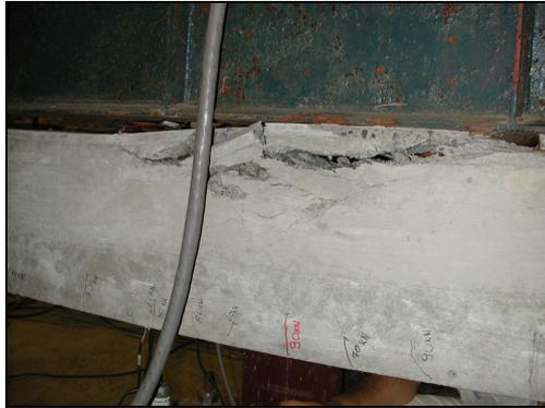
**Figura 5.34 – Ruptura da viga VS-01.**
