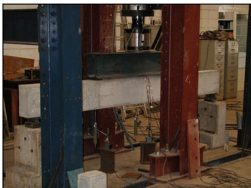
**Figura 5.30 – Viga VS-01, aplicação da carga de escorvamento.**
