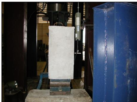
Figura 5.27 – Vista frontal do aparelho de apoio das vigas.
