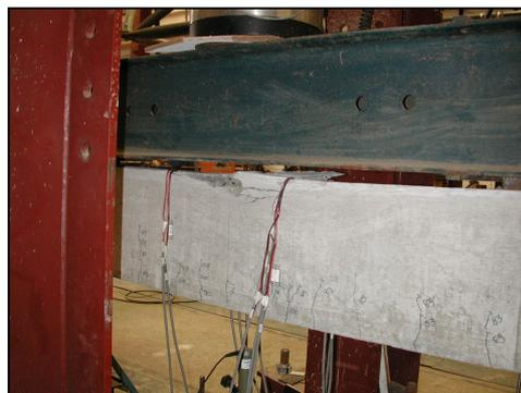
**Figura 5.43 – Início da ruptura, destacamento do cobrimento, viga VC-01.**
