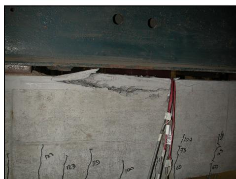
**Figura 5.51 – Início da ruptura, destacamento do cobrimento, viga VC-02.**
