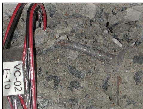
**Figura 5.53 – Detalhe da flambagem da armadura comprimida, viga VC-02.**
