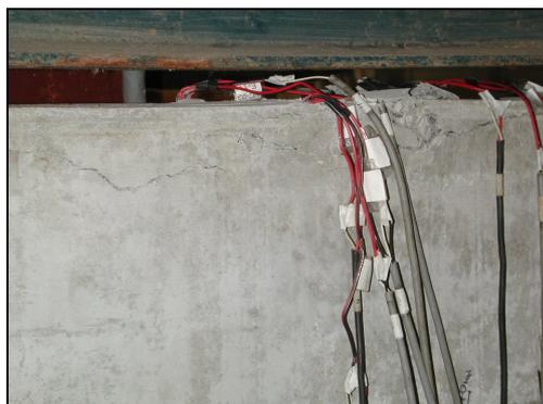
**Figura 5.60 – Início da ruptura, destacamento do cobrimento, viga VC-03.**
