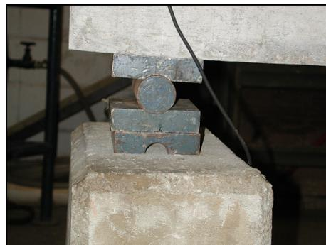
Figura 5.28 – Vista lateral do aparelho de apoio das vigas.
