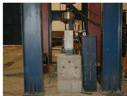
Figura 5.57 – Vista frontal da viga VC-03 pronta para o ensaio.
