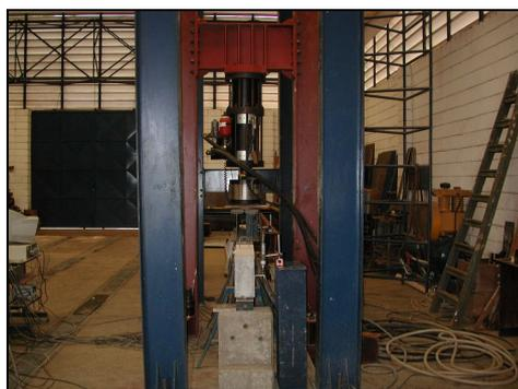
**Figura 5.25 – Atuador servo-controlado, marca INSTRON.**
