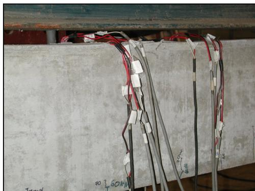
**Figura 5.58 – Ocorrência da primeira fissura, viga VC-03.**
