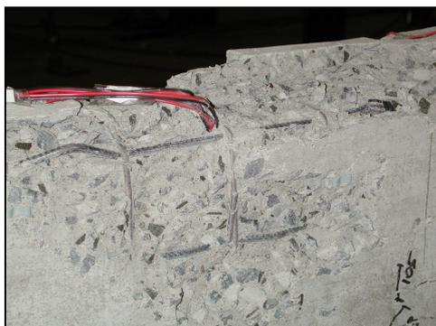
**Figura 5.44 – Flambagem da armadura mais comprimida entre os estribos de confinamento, viga VC-01.**
