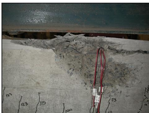
**Figura 5.52 – Flambagem da armadura mais comprimida, viga VC-02.**
