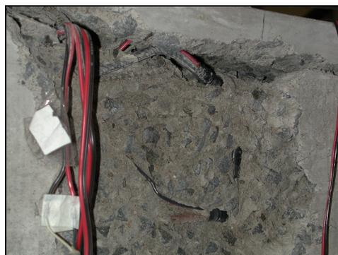
**Figura 5.45 – Detalhe da flambagem ocorrida na armadura mais comprimida, viga VC-01.**
