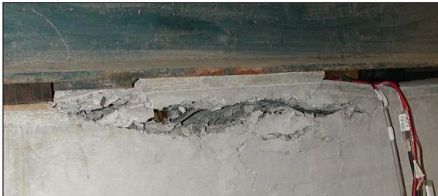
**Figura 5.36 – Flambagem da armadura de compressão da viga VS-01.**
