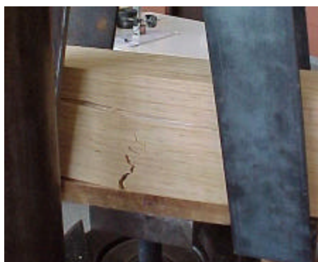
Figura 4.3 - Forma de ruptura para parafusos perpendiculares às fibras
