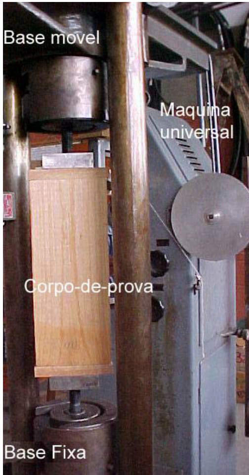
Figura 3.7 – Ensaio para parafusos na direção paralela às fibras.
