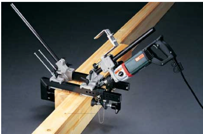
Figura 2.9 - Base de fixação para utilização da parafusadeira. FONTE: SFS (2002).
