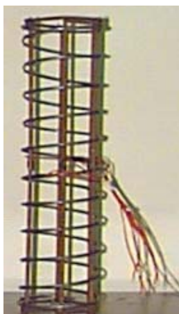
Figura 7.2 – Ilustração das armaduras
